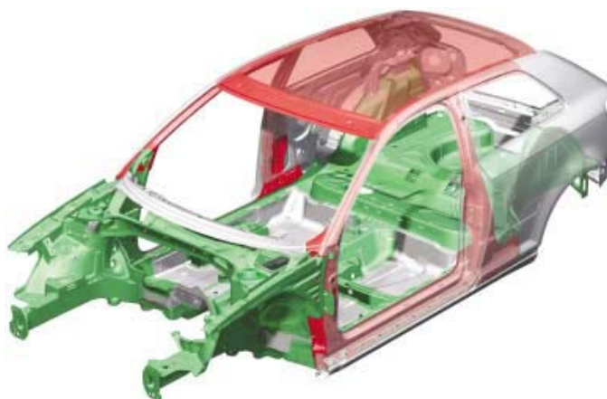
Измененные элементы остова кузова
