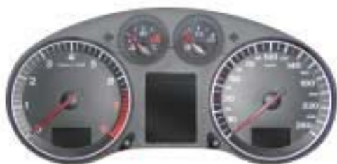
Отдельный прибор управления в качестве шлюза (Gateway)
