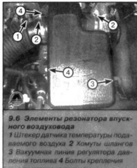
9.6 Элементы резонатора впускного воздухопровода
