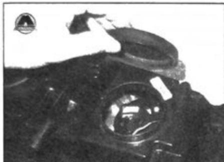
**14.2a** Снимите сервисную крышку, расположенную с обратной стороны корпуса фары...
