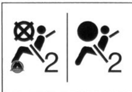
10.45 Индикаторы включения ("ON") и выключения ("OFF") подушки безопасности переднего пассажира
