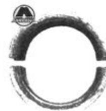
Повреждение из-за повышенного бокового давления или несоответствующего осевого зазора
