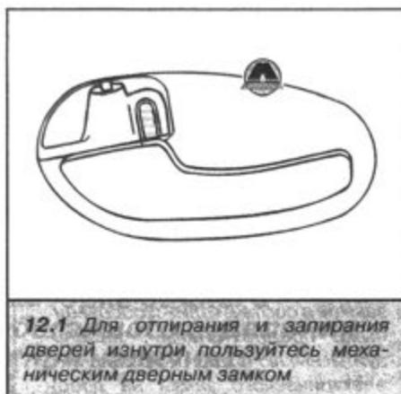
**12.1** Для отпирания и запираения дверей изнутри пользуйтесь механическим дверным замком
