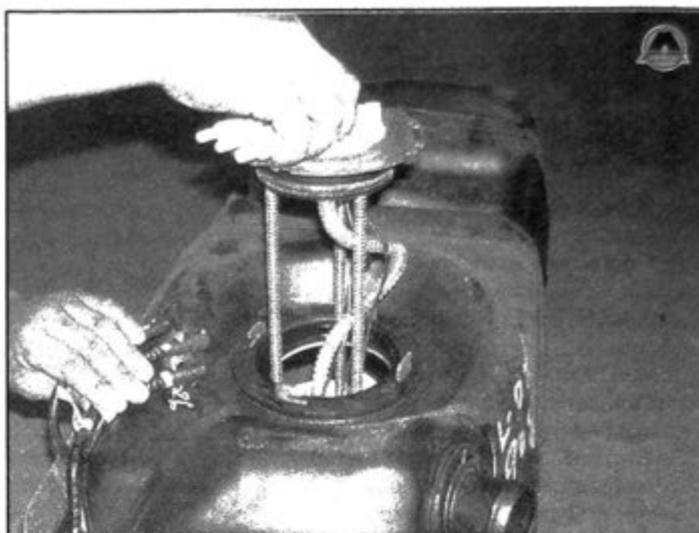
7.6 Аккуратно извлеките топливный насос из бака и слейте топливо в емкость
