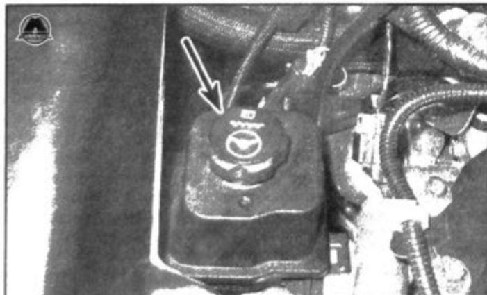
**6.2** Щуп для определения уровня жидкости расположен в бачке насоса гидроусилителя. Чтобы снять крышку, необходимо открутить ее против часовой стрелки
