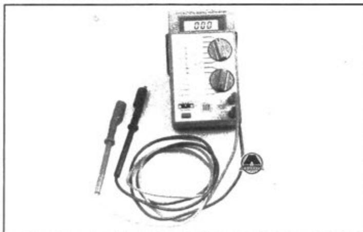
**2.1** Цифровые мультиметры могут использоваться для тестирования всех типов цепей; эти приборы из-за высокого сопротивления внутренних цепей точнее аналоговых мультиметров, что существенно при измерениях на цепях низкого напряжения, подключенных к процессору системы
