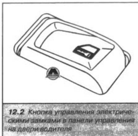
**12.2** Кнопка управления электрическими замками в панели управления на двери водителя
