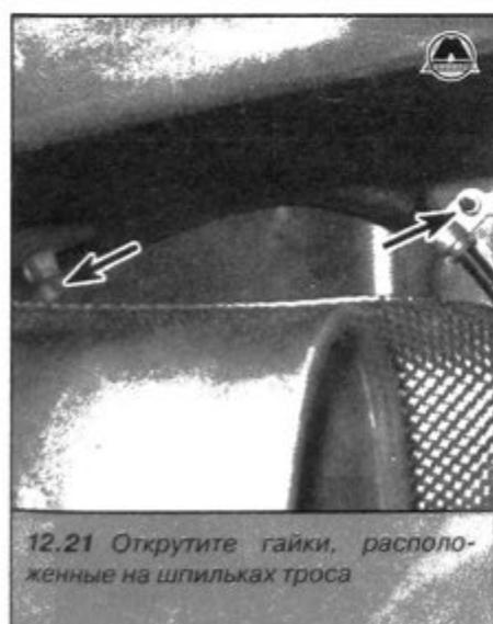
12.21 Открутите гайки, расположенные на шпильках троса
