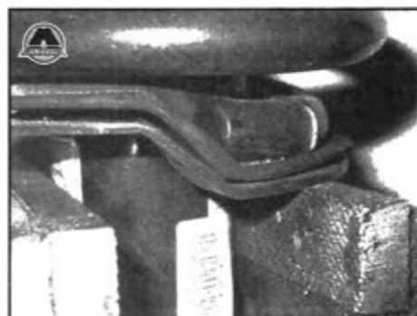
**3.6b** ...затем снимите пружину с нижней пластины, также отметив исходное расположение ее конца в пластине
