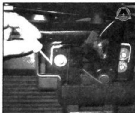
**10.10** Чтобы отрегулировать положение защелки крышки капота в горизонтальной и вертикальной плоскости, необходимо нанести метки исходного взаиморасположения и ослабить болты защелки
