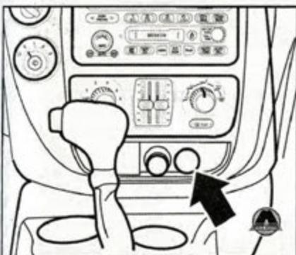
3.2 Розетка для подключения дополнительного оборудования
