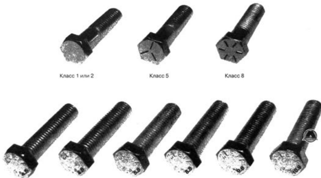
Маркировка болтов в зависимости от допустимой нагрузки (стандарты SAE, USS; нижний ряд – метрические болты)
