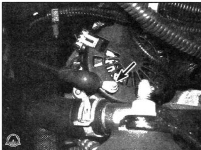
**4.4b** Отсоедините провод от генератора
