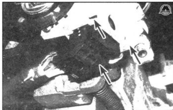
9.5a Снимите электрический элемент выключателя зажигания (отмечен нижней стрелкой), поддев его двумя отвёртками, введенными в специально предусмотренные отверстия (отмечены верхними стрелками)
