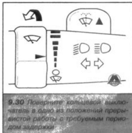
**9.30** Поверните кольцевой выключатель в одно из положений прерывистой работы с требуемым периодом задержки
