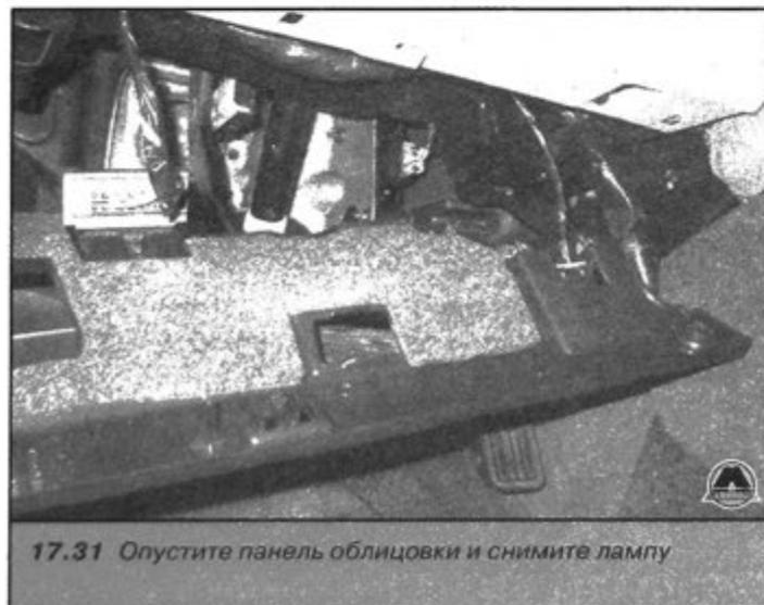
17.31 Опустите панель облицовки и снимите лампу
