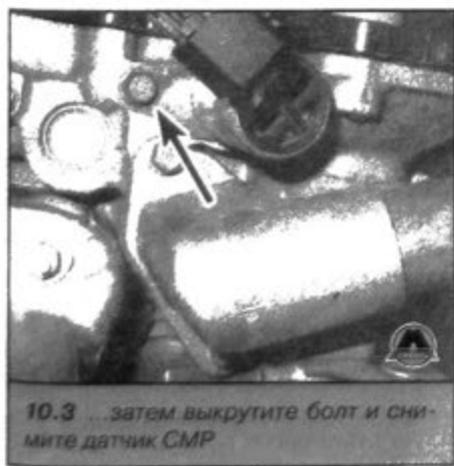
10.3 ...затем выкрутите болт и снимите датчик СМР
