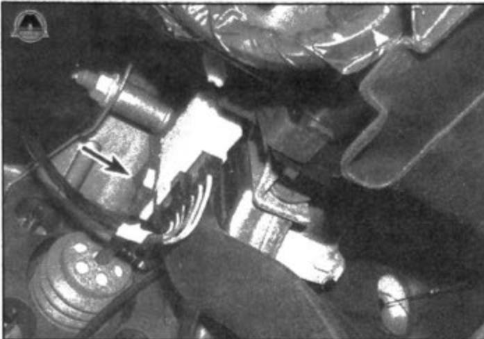
**9.9** Подденьте и снимите со штифта тормозной педали фиксатор выключателя стоп-сигналов и шток вакуумного усилителя
