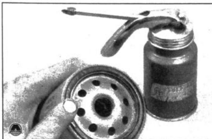
8.18 Перед установкой нового фильтра смажьте его уплотнитель чистым моторным маслом
