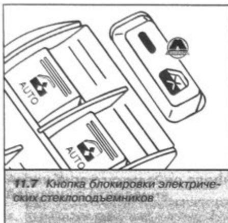
**11.7** Кнопка блокировки электрических стеклоподъемников
