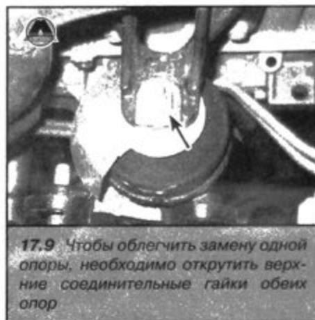
17.9. Чтобы облегчить замену одной опоры, необходимо открутить верхние соединительные гайки обеих опор
