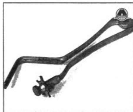
Приспособление для очистки канавок поршневых колец
