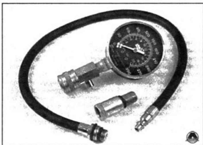
Компрессометр с переходником под отверстие свечи
