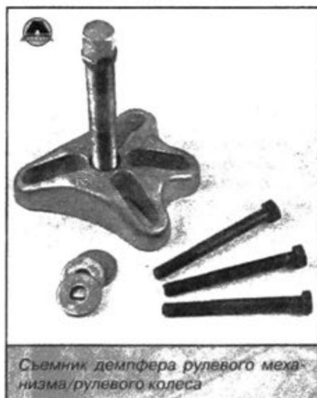
Съемник демпфера рулевого механизма/рулевого колеса
