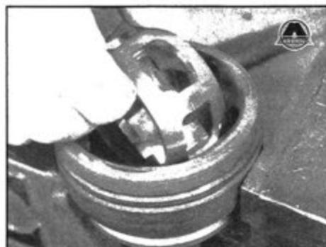
**13.4i** Поверните внутреннюю обойму и сепаратор на 90°, затем поместите элементы в корпус
