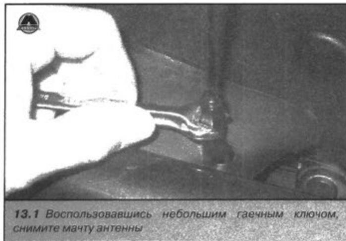
13.1 Воспользовавшись небольшим гаечным ключом, снимите мачту антенны
