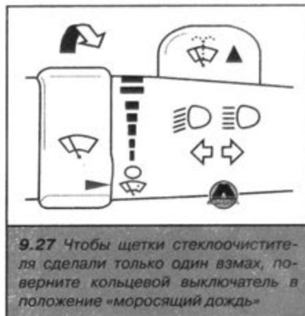
**9.27** Чтобы щетки стеклоочистителя сделали только один взмах, поверните кольцевой выключатель в положение «моросящий дождь»
