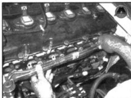
14.6 Резервуар и форсунки снимаются в сборе. После этого можно отсоединить каждую форсунку в отдельности
