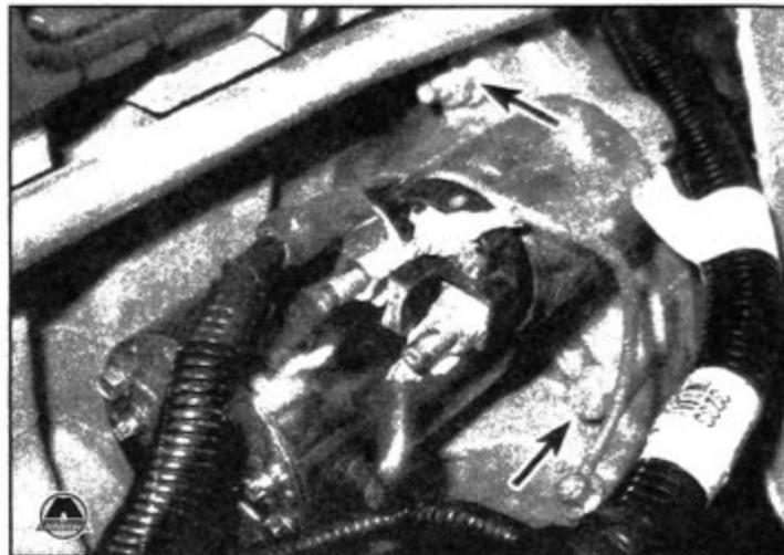
**13.4** Открутите гайку и выкрутите болт крепления стартера
