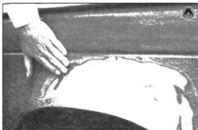
**9** На границе шпаклевки и металла, или металла и старой краски, не должно ощущаться перепада уровня. Выполните окончательную доводку обработанной поверхности, удалите пыль и абразивный материал с прилегающих металлических кузовных деталей и облицовочных панелей.
