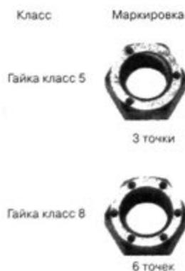
Маркировка в зависимости от допустимой нагрузки на гайках стандарта SAE
