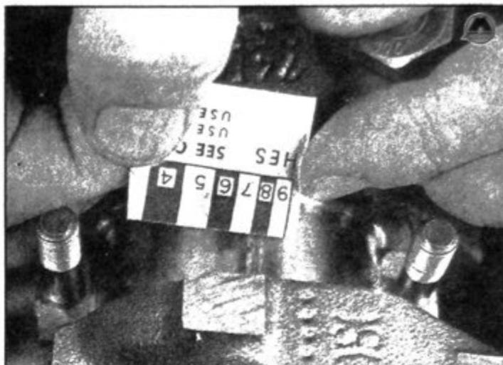
**9.41** Сопоставьте ширину раздавленного отрезка индикатора с масштабной диаграммой и определите величину масляного зазора (для определения зазора сопоставляйте самую широкую часть); убедитесь в том, что определение зазора производилось по соответствующей диаграмме – индикатор укомплектован дюймовой и метрической шкалой
