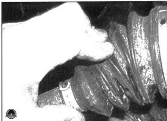
**26.15** На полноприводных автомобилях необходимо осмотреть на наличие ослабления хомутов, трещин и признаков просачивания смазки внутренние и наружные чехлы приводных валов (показан внутренний чехол)
