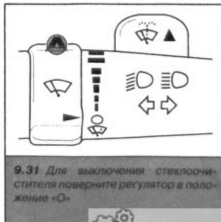
**9.31** Для выключения стеклоочистителя поверните регулятор в положение «0»
