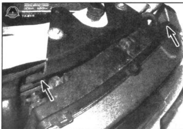
16.2a Вытяните фиксаторы кожуха фары...
