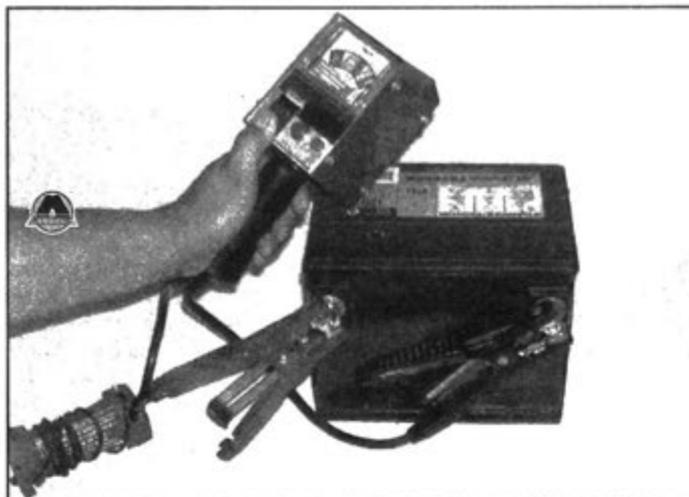
**3.3** Подключите нагрузочную вилку к контактным выводам аккумулятора и выполните проверку в соответствии с инструкциями по использованию вилки
