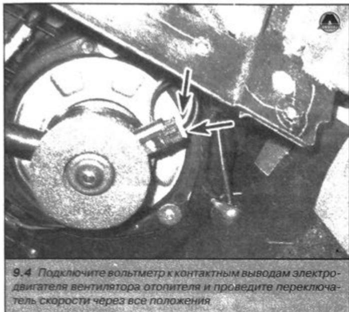
9.4 Подключите вольтметр к контактным выводам электродвигателя вентилятора отопителя и проведите переключатель скорости через все положения
