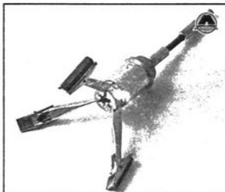
Хон для обработки поверхности тормозного цилиндра
