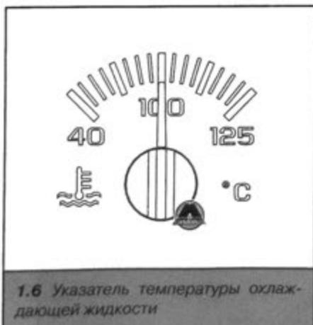
1.6 Указатель температуры охлаждающей жидкости
