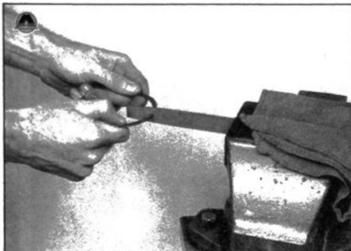
**9.15** Если зазор слишком мал, следует привести его в норму. Закрепите напильник в тисках и произведите подпиливание концов поршневого кольца
