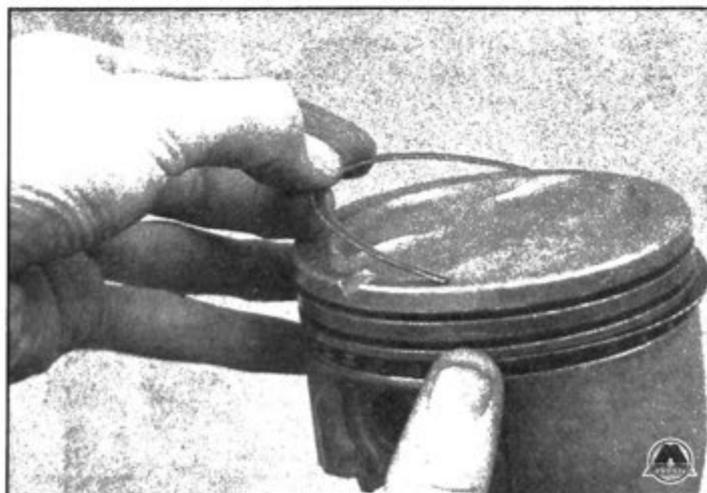
**9.19б** Не устанавливайте составляющие маслосъемного кольца с помощью специального приспособления
