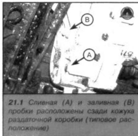
**21.1** Сливная (А) и заливная (В) пробки расположены сзади кожуха раздаточной коробки (типичное расположение)
