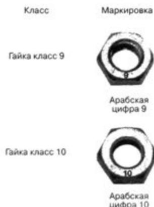
Маркировка в зависимости от допустимой нагрузки на метрических гайках
