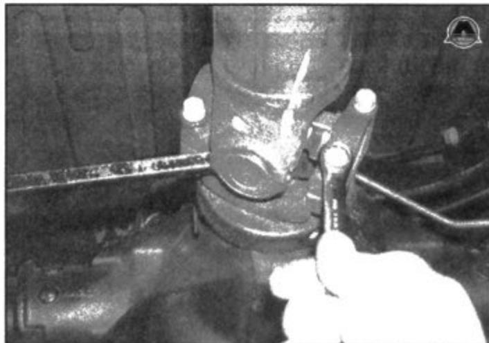
3.3 Чтобы заблокировать карданный вал при ослаблении затяжки болтов, проденьте большую отвертку через вилку
