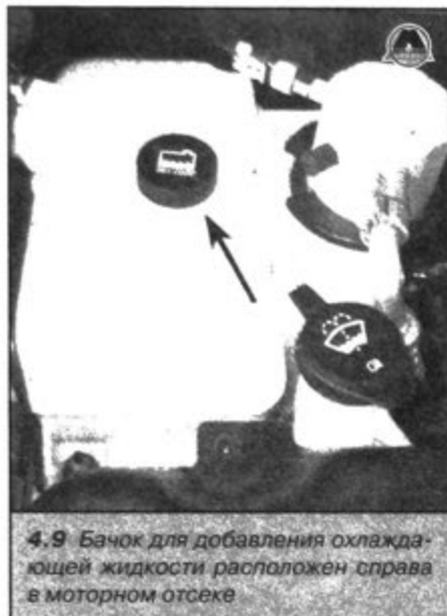
**4.9** Бачок для добавления охлаждающей жидкости расположен справа в моторном отсеке
