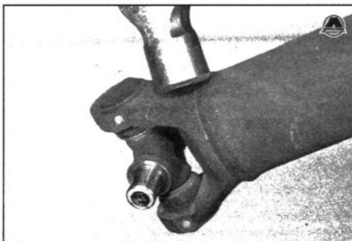
4.22 Равномерно постучите по вилке молотком - при этом произойдет ее спружинивание, и шарнир приобретет подвижность
