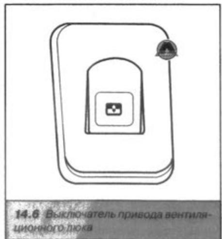
14.6 Выключатель привода вентиляционного люка
