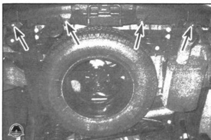
12.15 Снимите штифты, расположенные снизу облицовки заднего бампера
