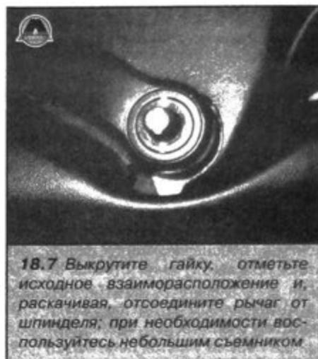
18.7 Выкрутите гайку, отметьте исходное взаиморасположение и, расклевывая, отсоедините рычаг от шпинделя; при необходимости воспользуйтесь наибольшим съемником
