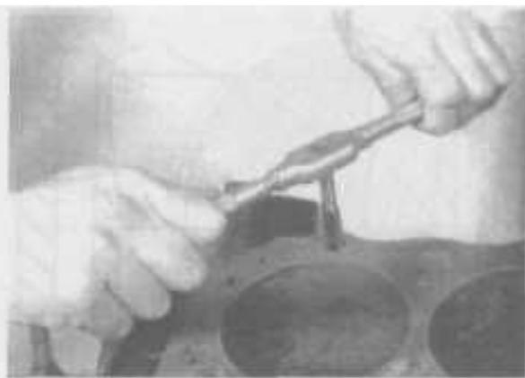
15.8. Все отверстия под болты в блоке (особенно отверстия под болты крышек коренных подшипников и головки) должны быть очищены, а резьба в них должна быть восстановлена с помощью метчика (по окончании работ обязательно очистите отверстия от загрязнений) сушки и продувки всех масляных отверстий и магистралей.
