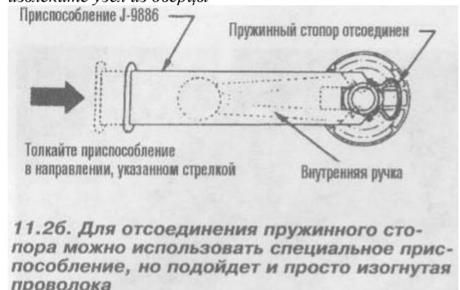
11.2б. Для отсоединения пружинного стопора можно использовать специальное приспособление, но подойдет и просто изогнутая проволока
