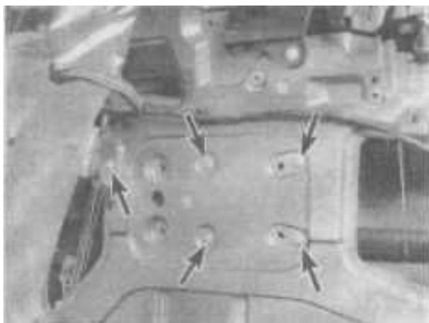
**20.4, Высверлите заклепки крепления электрического стеклоподъемника стекла двери (указаны стрелками)**
