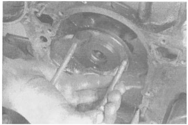
**12.12.** Вверните длинные болты в отверстия для болтов для использования их в качестве рукоятки при снятии и установке распределительного вала
