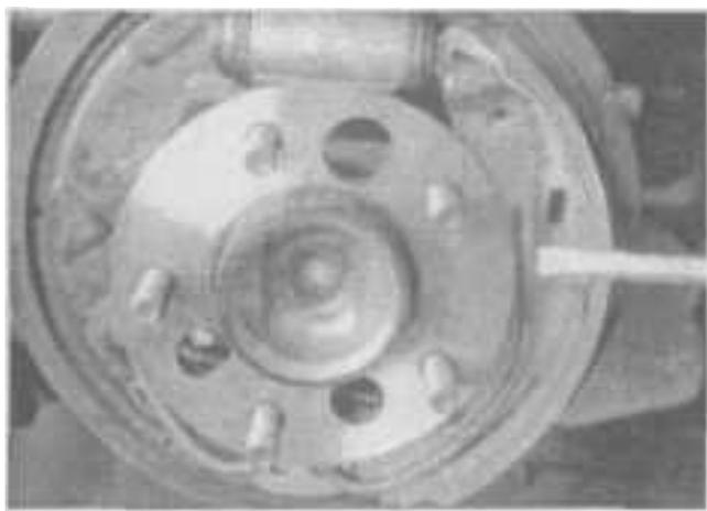
5.4м. На автомобилях 1992 года выпуска поднимите пружину с задней тормозной колодки и выверните колодку из области ступицы, чтобы получить доступ к тросу стояночного тормоза
