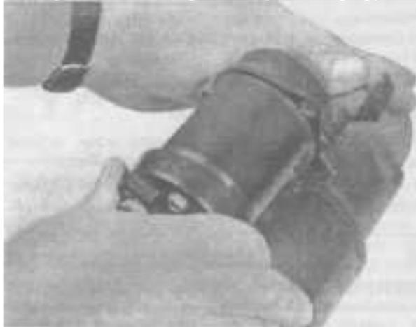
*17.5. Для снятия реле со стартера отверните винты крепления и, повернув реле против часовой стрелки, выньте из корпуса стартера*
