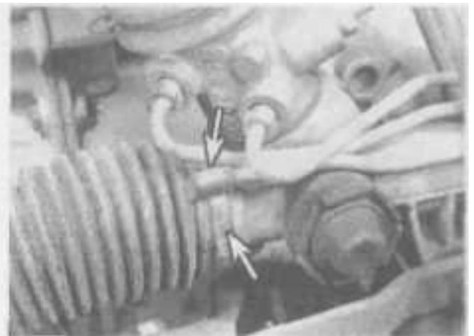
**18.3. Снимите внешний хомут защитного чехла**
