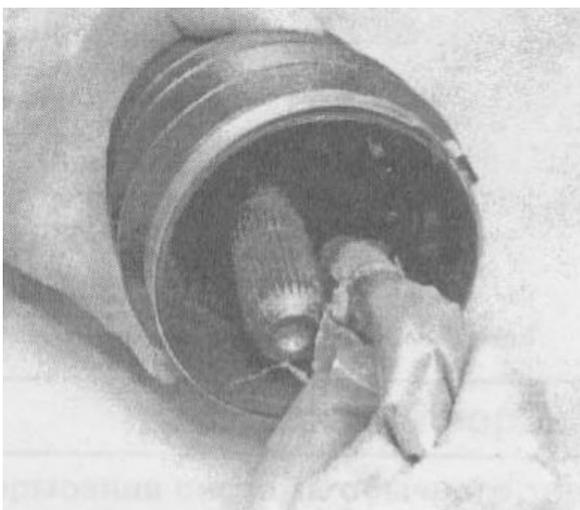
3.4р. Оденьте защитный чехол на полуось и закладывайте смазку внутрь защитного чехла полуоси до тех пор,...
