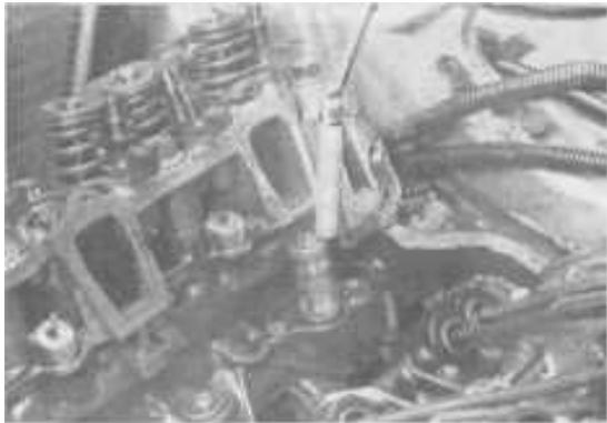
10.5a. Извлечь толкатели можно с помощью приспособления с магнитом...
