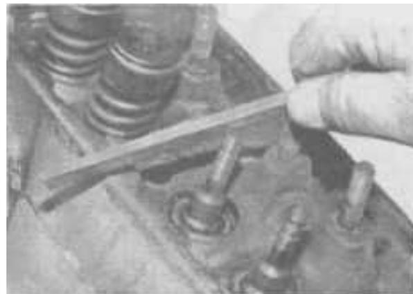
**8.4. Если клапан не выходит из направляющей втулки, зачистите края конца стержня и область над канавкой держателя напильником или абразивным бруском**
