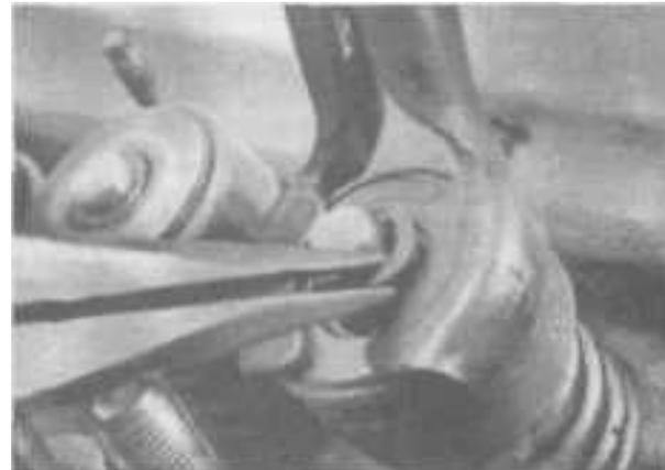
**8.3. Используйте специальное устройство для сжатия пружины, а затем снимите сухари со стержня клапана**
