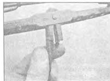
**2** Чтобы снять щетку стеклоочистителя, максимально оттяните поводок от стекла, пока он не зафиксируется. Поверните щетку на 90°, а затем, нажав пальцем на защелку, выдвиньте щетку из крюка на конце поводка.
