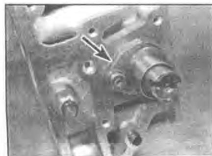
**10.9** Выкрутите болт и снимите фланец распредвала (отмечен стрелкой) – 1.1 и 1.4-литровые двигатели
