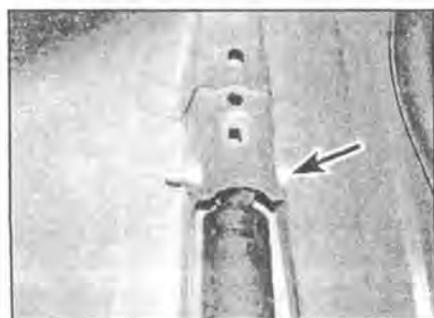
**13.4** Выкрутите верхний болт (отмечен стрелкой) крепления амортизатора
