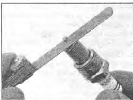
**18.8** Замерьте межэлектродный зазор свечи зажигания щупом
