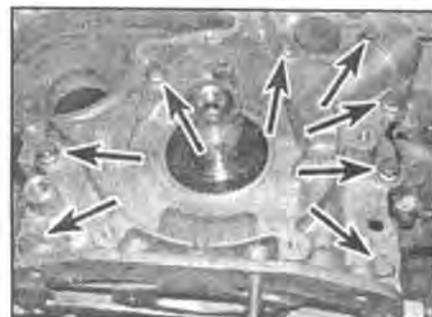
12.5 Выкрутите 8 болтов (отмечены стрелками) и снимите масляный насос
