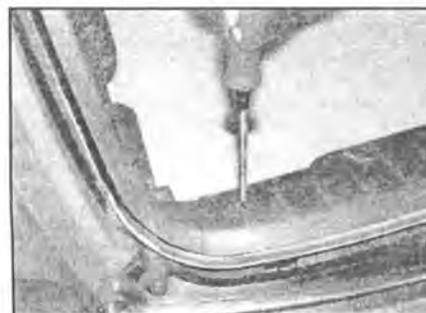
**25.44** Выкрутите болты, крепящие панель к полу багажного отсека
