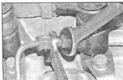
**9.4** При раскручивании гаек соединителей топливных форсунок зафиксируйте соединители вторым гаечным ключом (двигатели с 8 клапанами)
