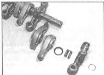
**10.4** Удалите стопорное кольцо и снимите компоненты с вала – 1.1 и 1.4-литровые двигатели
