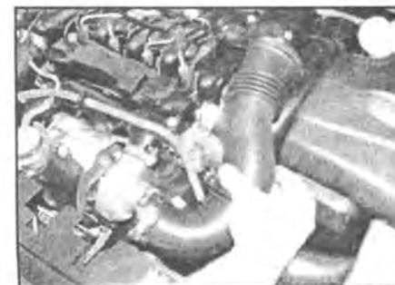
18.6b ...и отсоедините патрубок воздухозаборника от турбоагнетателя и воздухомера – двигатели с 16 клапанами
