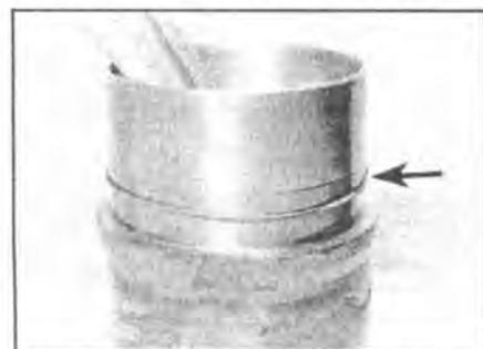
**11.18б** ...и снимите (отмечен стрелкой) кольцевой уплотнитель
