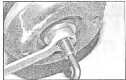
**5.2** Отверните гайку верхнего гнезда пружины. Придерживайте шток амортизатора при помощи подходящего торцевого ключа
