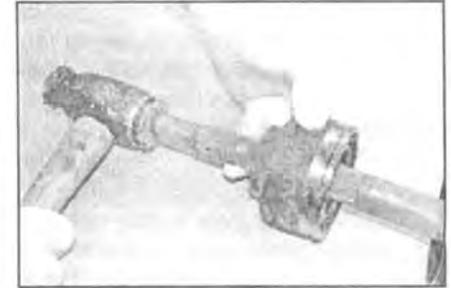
**3.12f** Нанесите резкий удар для смещения хомута проводки и расположения внутренней обоймы над стопорным кольцом. Поместив шарнир на его местоположение, срежьте хомут для проводки
