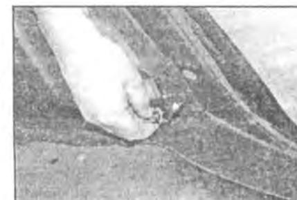
**25.22** Снимите облицовочный колпачок, затем выкрутите нижний анкерный болт ремня безопасности заднего сидения
