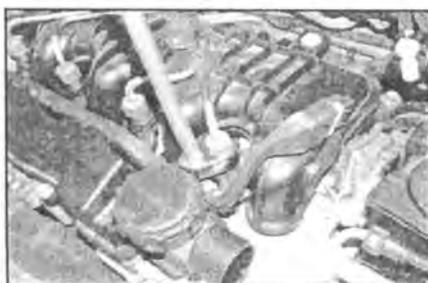
**9.15** С помощью адаптера «воронья лапа» открутите соединительные гайки форсунок (двигатели с 16 клапанами)
