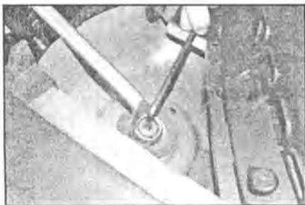
**4.13** Ослабьте и выкрутите верхнюю монтажную гайку стойки
