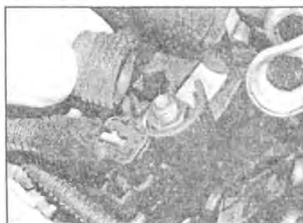
**7.4** Снимите с помощью рычага резиновые колпачки, затем отсоедините проводку от генератора
