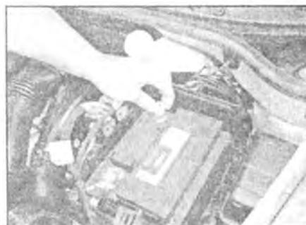
**2** Чтобы обеспечить хороший электроконтакт, зажимы клемм должны быть затянуты. Проверьте их рукой: они не должны двигаться. Также проверьте каждый провод, нет ли на нем трещин и не перетерт ли он.
