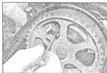
**11.20** Для измерения люфта датчика положения распредвала вставьте согнутый на 90° щуп между спицами звездочки
