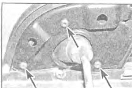
**17.4** Выкрутите три крепящих винта (отмечены стрелками) и снимите зеркало с двери
