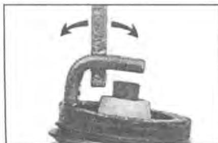
Регулировка зазора в свече зажигания
