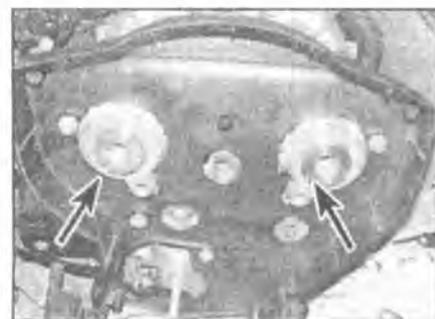
**10.32** *Метки расположения в 7-часовом положении на впускном распредвале и в 8-часовом положении на выпускном – 1.6-литровые двигатели*
