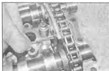
**9.66** Прикрутите натяжитель цепи в сборе двумя крепящими болтами, затем извлеките сверло, чтобы отжать механизм натяжения – двигатели с 16 клапанами
