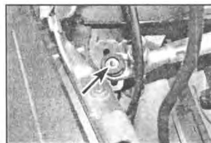
**14.2b** ...затем выкрутите гайку (отмечена стрелкой), крепящую механизм стеклоочистителя к кузову автомобиля
