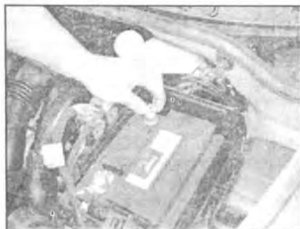
**A** Откиньте пластмассовую крышку и проверьте безопасность и качество подключения аккумулятора.
