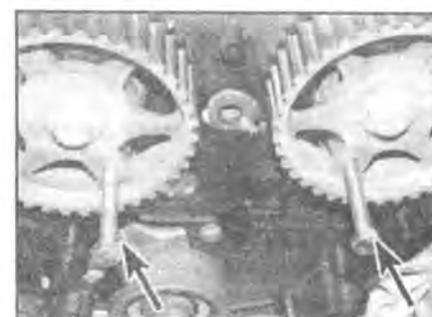
**3.8** Вставьте болты или штифты диаметром 8 мм в установочные отверстия в звездочках распределительных валов (отмечены стрелками) и заблокируйте – 1.6-литровые двигателях
