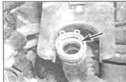
2.13 Перед защелкиванием соединителя убедитесь, что кольцевой уплотнитель и (отмечено стрелкой) стопорное кольцо правильно установлены на соединительной муфте шланга
