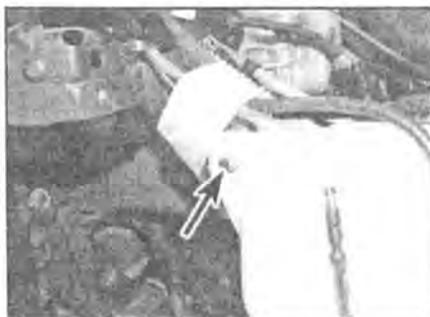
**16.7a** Ослабьте и выкрутите верхнюю стопорную гайку (отмечена стрелкой) бачка омывателя...
