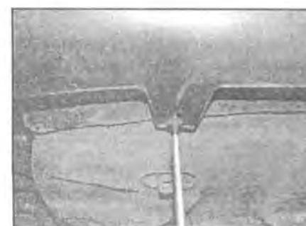
**7.4** Выкрутите два нижних центральных болта, крепящие бампер к его кронштейну
