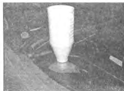
**23.19** Используйте обычную 1,0 литровую пластиковую бутылку в качестве дополнительного резервуара.
