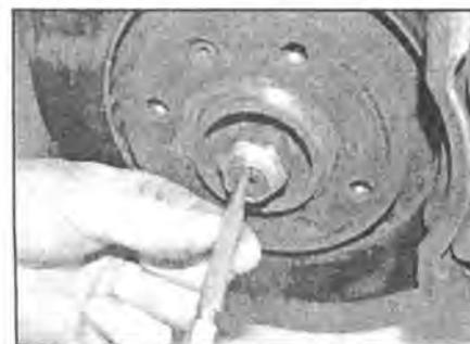
2.4 Сбейте кромку, фиксирующую крепящую приводной вал гайку
