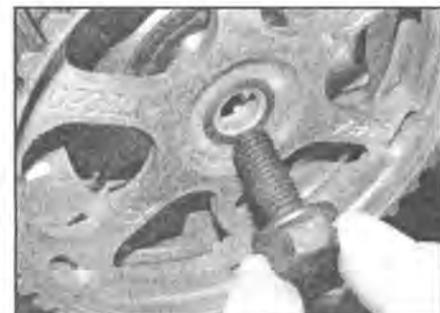
**8.3** Выкрутите крепящий болт и снимите звездочку с распредвала
