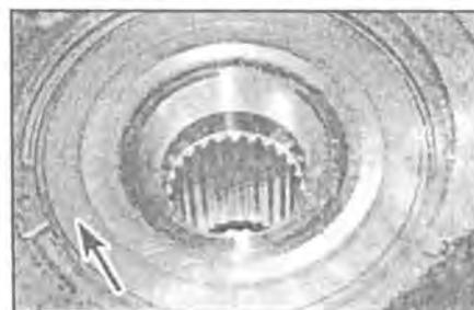
**3.7** Опасайтесь повредить изоляцию подшипника (отмечена стрелкой) – она содержит излучатель датчика скорости колеса
