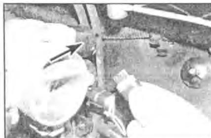
13.26 Отсоедините разъем провода (отмечен стрелкой) от шагового двигателя регулировки оборотов холостого хода (1.1-литровый двигатель)
