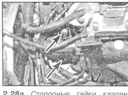
**2.28a** Стопорные гайки клапана – соленоида рециркуляции отработавших газов (отмечены стрелками) на двигателях с 8 клапанами...
