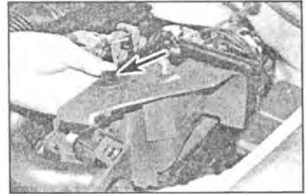
**4.10** Снимите воздушный дефлектор, повернув пластмассовый фиксатор (отмеченный стрелками) на 90° (двигатели с 8 клапанами)
