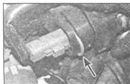
**7.6** Снимите с помощью рычага стопорное кольцо датчика (отмечено стрелкой), затем снимите температурный датчик дизельного двигателя
