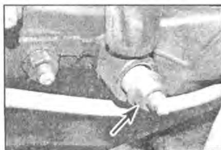
**13.5** Выкрутите гайку (отмечена стрелкой) и извлеките болт нижнего крепления амортизатора
