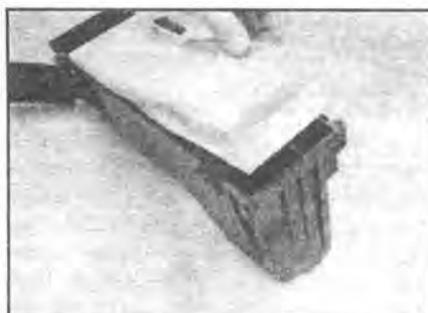
**19.2c** ...и удалите фильтрующий элемент воздушного фильтра
