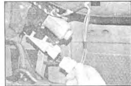
**13.12** Отсоедините разъем проводов от электродвигателя стеклоподъемника
