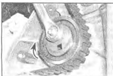
**6.9** Ослабьте гайку, затем вращайте шкив механизма натяжения по часовой стрелке для ослабления натяжения зубчатого ремня привода – 1.1 и 1.4-литровые двигатели
