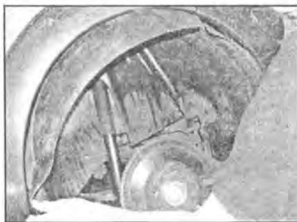
**13.2b** ...и снимите защиту арки заднего колеса
