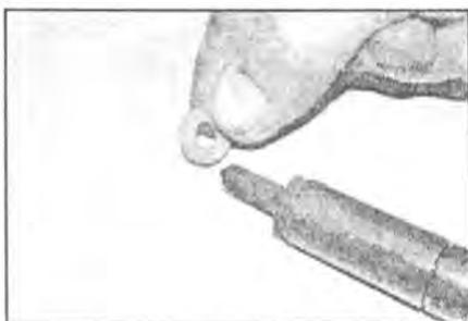
**10.20b** ...и новые медные уплотнительные шайбы на концы форсунок (двигатели с 16 клапанами)
