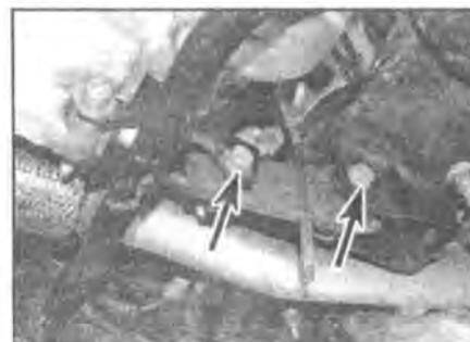
16.21 Стяжные болты крепления задней опоры двигателя (отмечены стрелками)
