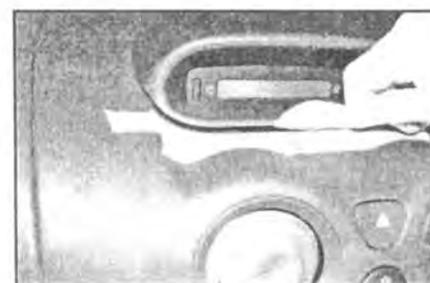
**27.2a** Вставьте плоскую пластмассовую лопатку под нижний край облицовки универсального дисплея
