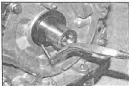
**14.3** Просверлите в сальнике отверстие и, с помощью самонарезного болта и плоскогубцев, снимите сальник
