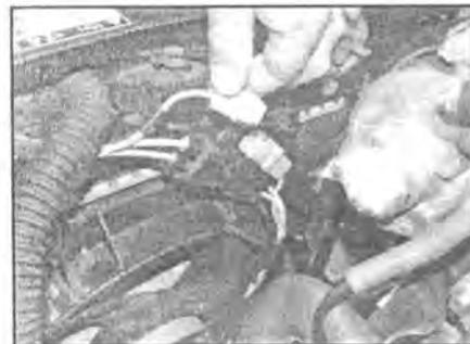
6.5 Отсоедините два провода от кожуха вентилятора
