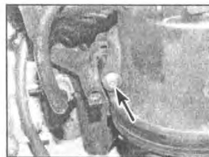
19.7а Выкрутите фиксирующий винт (отмечен стрелкой)...
