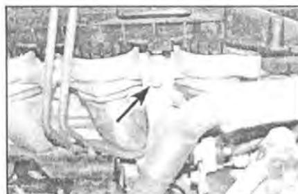
**8.11б** ...и болт (отмечен стрелкой), крепящий трубу к задней части головки блока цилиндров (двигатели с 16 клапанами)
