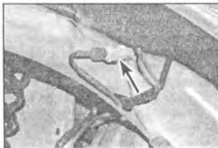
**23.19а** Отсоедините разъем провода датчика скорости переднего колеса (отмечен стрелкой) сверху колесной арки...
