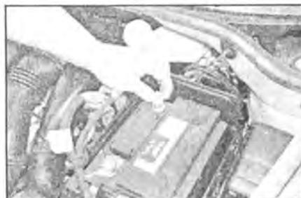
**4.4** Ослабьте гайку зажимного болта и отсоедините провод от отрицательной клеммы аккумулятора
