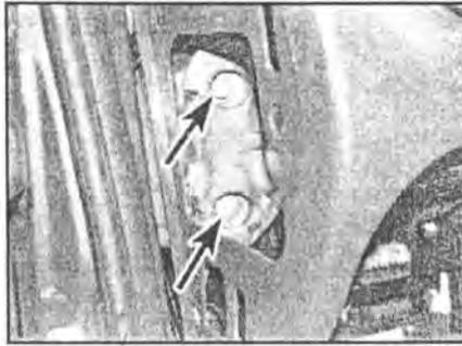
**27.29b** ... и выкрутите по два монтажных болта (отмечены стрелками) с каждой стороны
