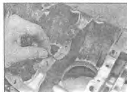
**17.5** На втором и четвертом коренном подшипнике устанавливаются верхние и нижние вкладыши с желобком – 1.1 и 1.4-литровые бензиновые двигатели
