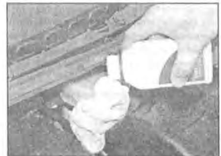
**3** Аккуратно залейте жидкость, избегая проливания ее на расположенные вблизи окрашенные элементы. Используйте только жидкость, рекомендованную для данной гидросистемы; смешивание различных типов жидкости может повредить систему и/или снизить тормозную эффективность. После заполнения до установленного уровня, надежно закрутите крышку и вытрите пролитую жидкость.
