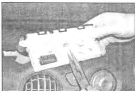
**6.15** Снимите патроны лампочек многофункционального дисплея, затем извлеките из зажимов лампочки с вставляющимися разъемами
