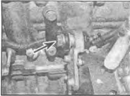
**10.28a** Выкрутите верхний задний монтажный болт (отмечен стрелкой) топливного насоса высокого давления
