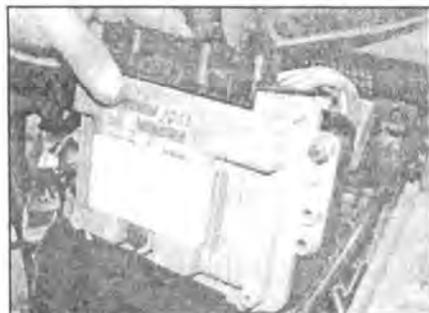
13.22 Извлеките устройство из кожуха аккумулятора
