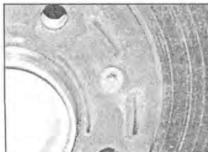
7.5 Выкрутите винты шестигранным ключом и снимите диск
