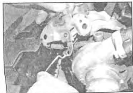
**9.1b** Снимите замок и отсоедините тросик открывания капота
