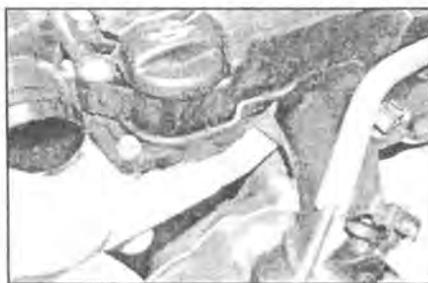
**4.32** Поднимите правый край резонатора, чтобы освободить уплотнитель резонатора от его опорной стойки (двигатели с 16 клапанами)
