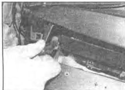
**10.3a** Прижмите фиксирующую пластину фильтра...
