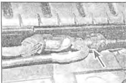
**14.5b** ...и отсоедините клапанную трубку (отмечена стрелкой) от коллектора (1.6-литровый двигатель)
