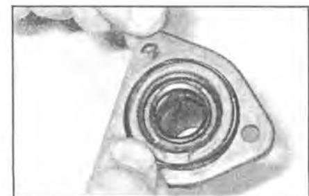
**4.11** Установите новый уплотнитель или прокладку (в зависимости от конструкции) на заднюю часть направляющей втулки
