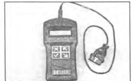
Считыватель кода неисправности
