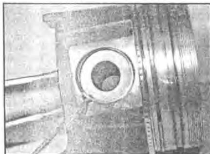
**12.15а** Снимите с помощью рычага стопорное кольцо...
