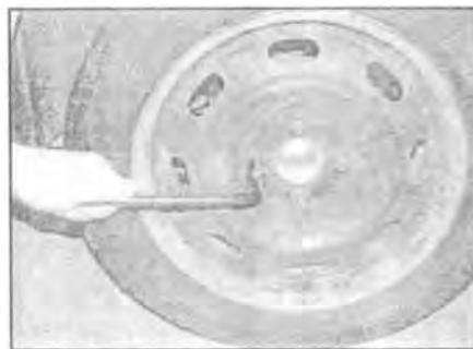
**3** Используя баллонный ключ, слегка ослабьте каждый болт колеса. На моделях с колесами на литых дисках используйте специальный инструмент для откручивания блокировочных гаек.
