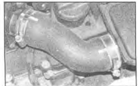
**4.3** Ослабьте хомут и отсоедините выходной шланг турбонагнетателя — 8 клапанные двигатели
