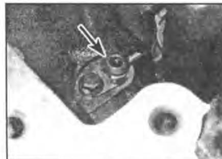
**11.3** Масляные форсунки поршней (отмечены стрелками) внутри блока цилиндров
