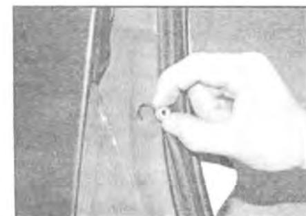
**5.32b** ...и выкрутите стопорную гайку, к которой открылся доступ
