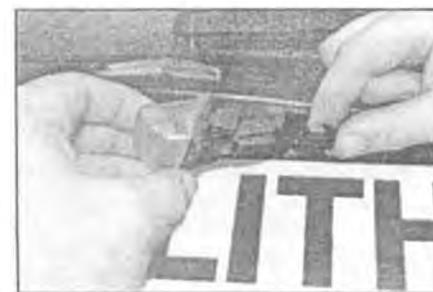
**7.17** Аккуратно подденьте и снимите фонарь подсветки номерного знака с задней откидной двери и отсоедините разъем проводов
