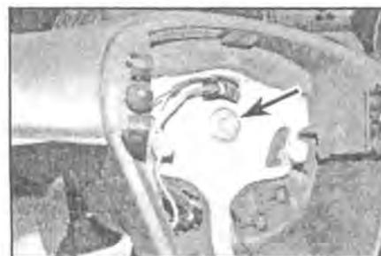
**16.3** Ослабьте и выкрутите болт крепления рулевого колеса (отмечен стрелкой)
