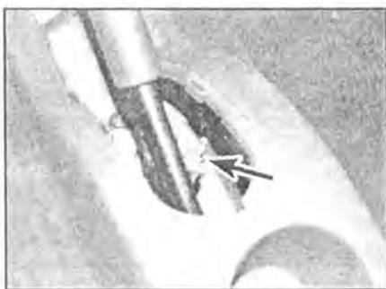
**17.5** Регулировочная гайка тросика ручного тормоза (отмечена стрелкой)
