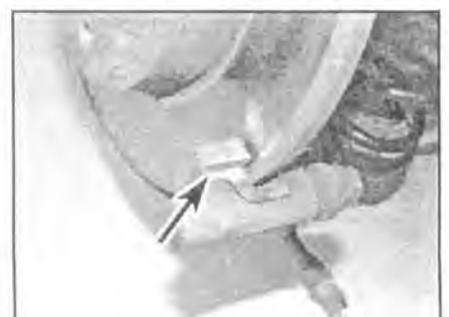
5.4b ...запомните местоположение прокладок (отмечено стрелкой) между колодками и суппортом
