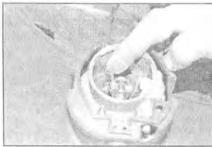
**5.19** Отстегните фиксатор лампы и извлеките его с противотуманной фары
