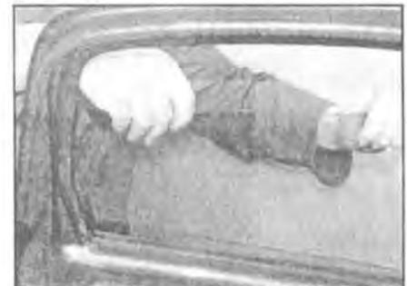
**13.26** Приподнимите вверх заднюю часть стекла и снимите его с двери
