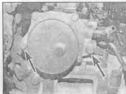
9.4 Выкрутите крепящие болты (отмечены стрелками) вакуумного насоса – двигатели с 8 клапанами
