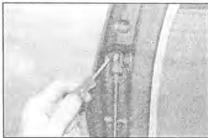
**14.10** Надавите на пружинные фиксаторы и стяните амортизаторы с шарниров на задней двери
