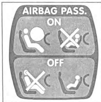
2.3 Индикатор отключения пневмоподушки безопасности
