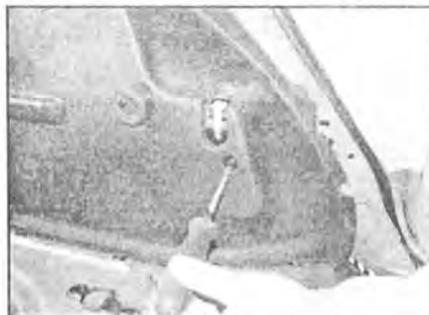
**25.33** Выкрутите передний болт, крепящий боковую панель к корпусу автомобиля
