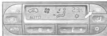
4.18а Кнопка включения обогрева на автомобилях с системой «климат-контроль»...
