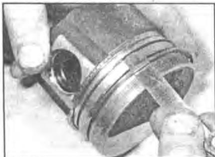
**12.2** Снимите поршневые кольца с помощью измерительного шупа
