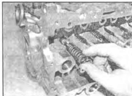
**6.6d** ...затем снимите пружину клапана
