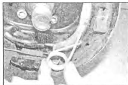
**11.4b** ...затем отсоедините вспомогательную пружину от тормозной колодки и от нижней возвратной пружины
