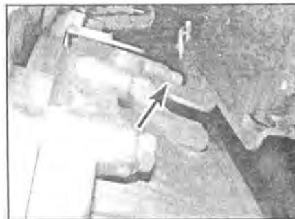
**8.6** Передний крепящий болт установочной пластины БЭУ (отмечен стрелкой)
