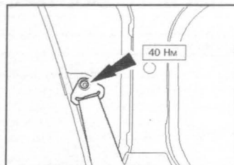
20.10a Болт верхнего анкера заднего ремня (модели с короткой базой)
