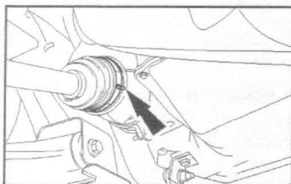
2.6 Снятие правого приводного вала
