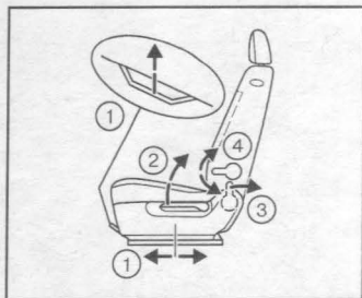
9.2 Регулировка положения сиденья
