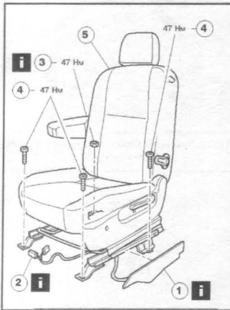
18.2a Снятие сиденья водителя
