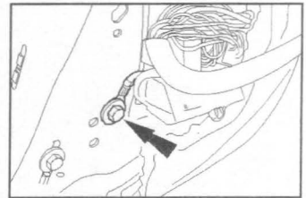
16.20 Провод массы на левой стойке А
