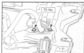
4.11 Гайки крепления хомута стабилизатора
