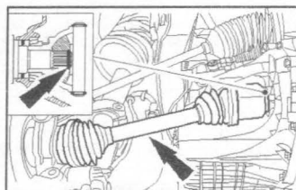
20.50 Положение установленного стопорного кольца левого приводного вала
