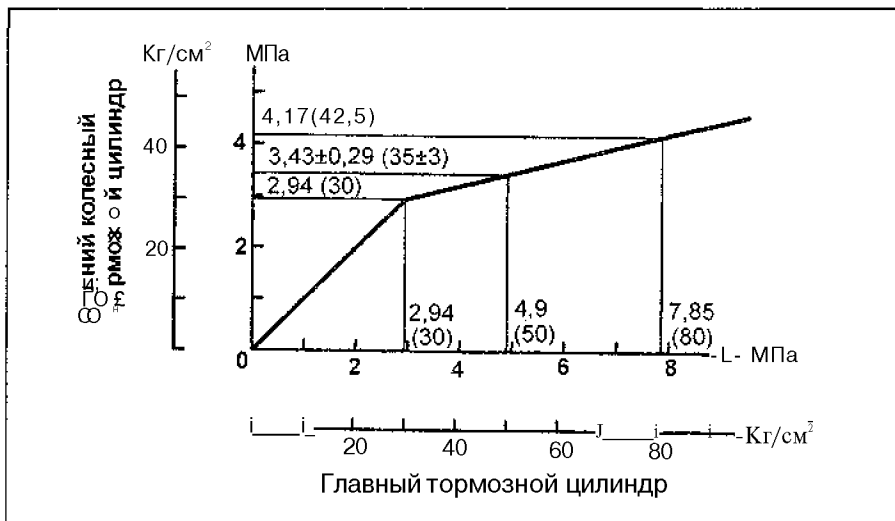
График работы регулятора давления (модели 2WD).
