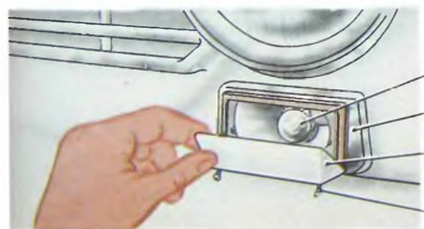
ЗАМЕНА ЛАМПЫ ФОНАря ОСВЕЩЕНИЯ НОМЕРНОГО ЗНАКА
