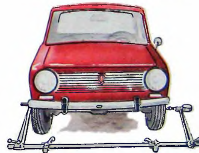
ЗАМЕР СХОЖДЕНИЯ ПЕРЕДНИХ КОЛЕС
