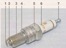
Свеча зажигания: 1 — боковой электрод; 2 — центральный электрод (в тепловом конусе изолятора); 3 — резьбовая часть корпуса; 4 — уплотнительное кольцо; 5 — шестигранная часть корпуса под ключ; 6 — изолятор (на нем нанесена маркировка свечи зажигания); 7 — контактный наконечник (съемный, установлен на резьбе)
