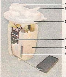
Топливный модуль двигателя 11183 (1.6): 1 — входной патрубок (для подвода топлива к регулятору давления); 2 — выходной (нагнетающий) патрубок; 3 — крышка модуля; 4 — датчик указателя уровня топлива; 5 — заборная камера; 6 — направляющая крышки модуля
