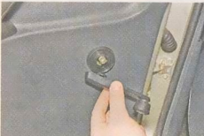
4. Поддев шлицевой отверткой, снимаем декоративную накладку ручки двери.
