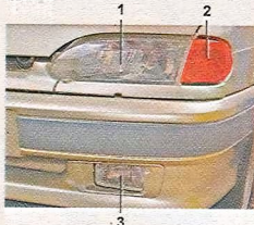
Фары: 1 — блок-фара; 2 — передний указатель поворота; 3 — противотуманный фара
