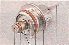
Регулятор давления топлива двигателя 11183 (1.6): 1 — отверстие для сброса избыточного топлива; 2, 4 — уплотнительные кольца; 3 — отверстия для подвода топлива в регулятор; 5 — корпус; 6 — вывод для соединения регулятора с «массой»
