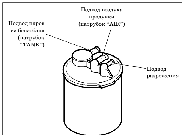
Рис. 1.8-02. Адсорбер автомобилей семейства ВАЗ-2110
