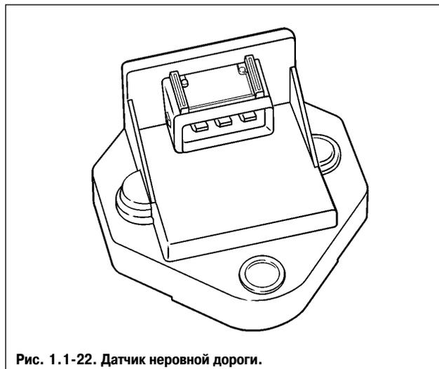
Рис. 1.1-22. Датчик неровной дороги.
