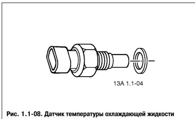
Рис. 1.1-08. Датчик температуры охлаждающей жидкости
