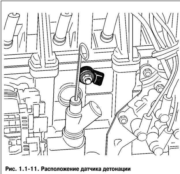
Рис. 1.1-11. Расположение датчика детонации
