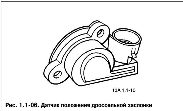
Рис. 1.1-06. Датчик положения дроссельной заслонки
