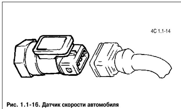
Рис. 1.1-16. Датчик скорости автомобиля
