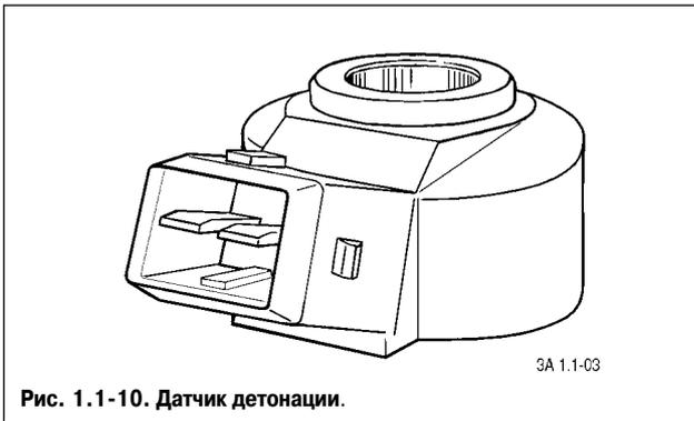
Рис. 1.1-10. Датчик детонации.
