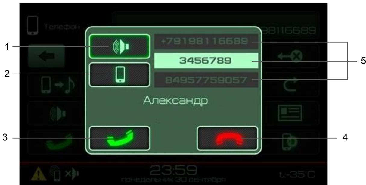
**Рисунок 12 - Окно телефонного соединения**
