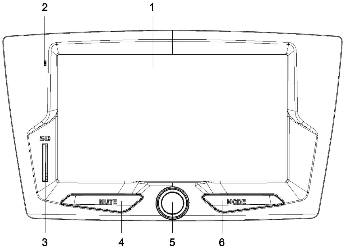
Рисунок 1 - Лицевая панель радиоаппарата
