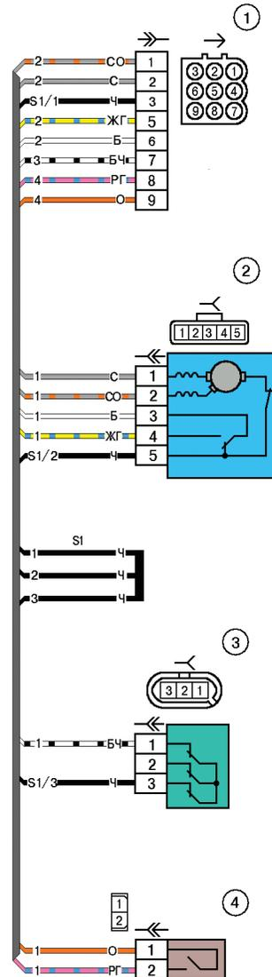
**СХЕМА ЭЛЕКТРИЧЕСКИХ СОЕДИНЕНИЙ ЖГУТА ЗАДНЕГО ДОПОЛНИТЕЛЬНОГО ЛЕВОГО И ЖГУТА ПРОВОДОВ ФОНАРЕЙ ОСВЕЩЕНИЯ НОМЕРНОГО ЗНАКА**
