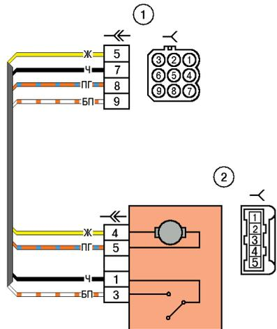
**СХЕМА ЭЛЕКТРИЧЕСКИХ СОЕДИНЕНИЙ ЖГУТА КОРОБКИ ВОЗДУХОПРИТОКА**
