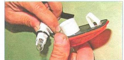
Повернув патрон с лампой против часовой стрелки, вынимаем его из корпуса указателя.
