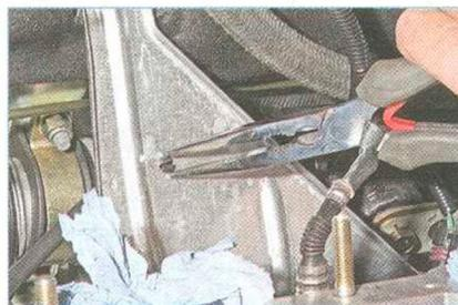
Сжав пассатижами усики держателя жгута проводов датчика концентрации кислорода...
