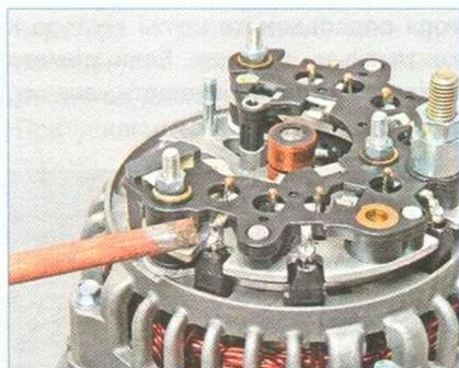
...отпаиваем шесть выводов обмотки статора от выводов выпрямительного блока...
