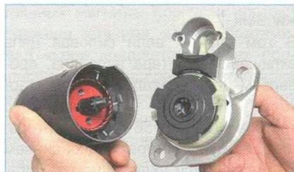
Разъединяем корпус и переднюю крышку.
