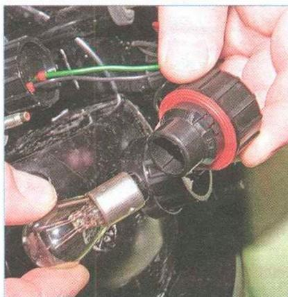
...и вынимаем лампу из патрона.
