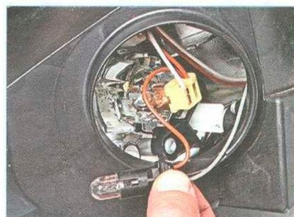
...и вынимаем патрон с лампой.
