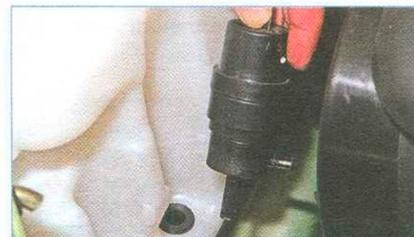
Потянув вверх, извлекаем электронасос из отверстия в бачке омывателя ветрового стекла.
