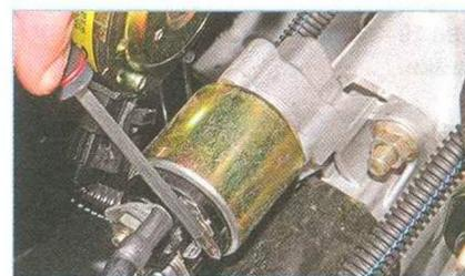
Стержнем отвертки перемыкаем вывод обмоток тягового реле и наконечник провода, соединенного с «плюсовым» выводом аккумуляторной батареи.
