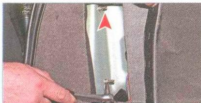
Ключом или высокой головкой «на 10» отворачиваем три гайки крепления фонаря (третья гайка находится под обивкой и на фото не видна).
