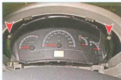
Тем же инструментом отворачиваем два винта крепления комбинации приборов...
