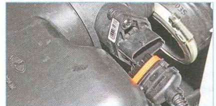
...и отсоединяем колодку жгута проводов от датчика.
