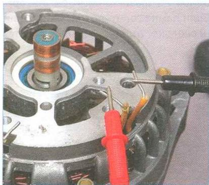
Для проверки обрыва в обмотках статора подсоедините щупы тестера (в режиме омметра) к выводам обмотки статора. Если омметр показывает бесконечность, значит, в обмотке есть обрыв.
