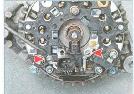
Шлицевой отверткой отворачиваем два винта крепления выводов регулятора напряжения.
