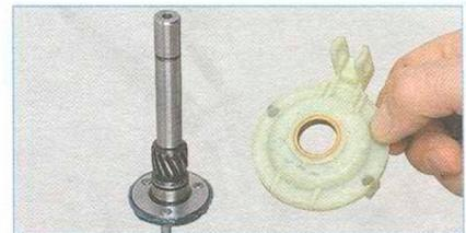
Снимаем с вала привода коронную шестерню планетарного редуктора.
