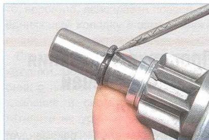
Поддеваем отверткой запорное кольцо и снимаем его. Снимаем ограничительное кольцо хода шестерни привода.
