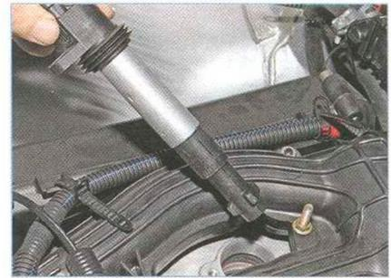
...и снимаем катушку зажигания.
