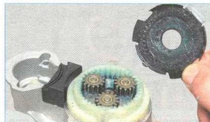
Снимаем крышку планетарного редуктора.
