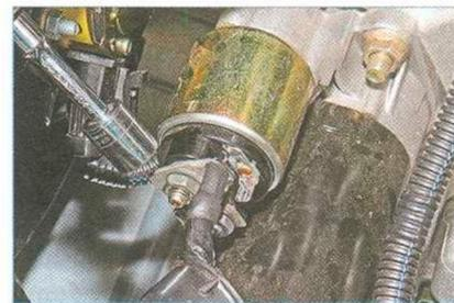
**Головкой «на 13» отворачиваем гайку крепления наконечника провода,**
