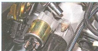
Головкой «на 15» отворачиваем две гайки крепления стартера (нижняя гайка на фото не видна).
