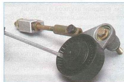
Поддев отверткой крышку ролика (для наглядности показано на демонтированном натяжном устройстве)...
