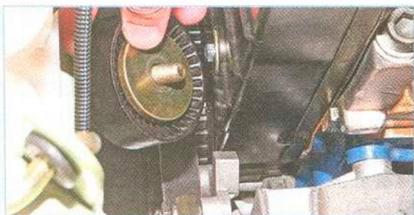
Вынимаем натяжной ролик с болтом, опорной втулкой и шайбой.
