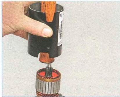
При установке корпуса на якорь придерживаем ручкой молотка якорь от притягивания его постоянными магнитами и опускаем корпус на заднюю крышку.
