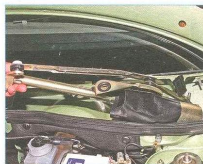
Вынимаем очиститель ветрового стекла с мотор-редуктором в сборе.
