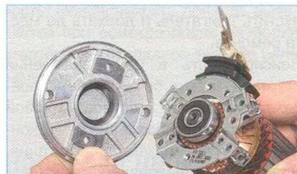
...и снимаем заднюю крышку.
