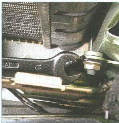
Ключом «на 13» отворачиваем гайку крепления кронштейна звукового сигнала...
