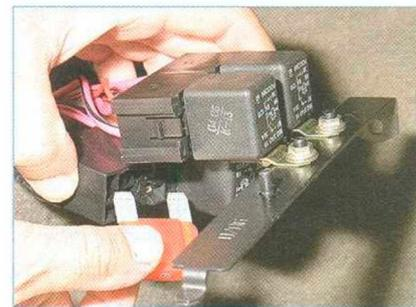
...вынимаем его из колодки блока. Для замены предохранителей системы управления...
