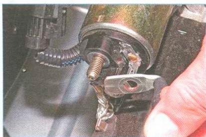
...и снимаем наконечник провода.
