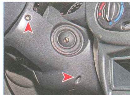
Аналогично отворачиваем винт и саморез с правой стороны рулевой колонки.
