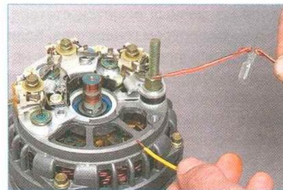
«Плюс» батареи через лампу (1–5 Вт, 12 В) подсоедините к выводу «В+» генератора, а «минус» — к его корпусу. Если лампа горит, то и в блоке «положительных», и в блоке «отрицательных» вентилях имеется короткое замыкание (для наглядности щеткодержатель с регулятором напряжения снят).
