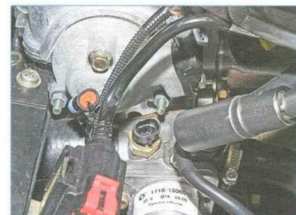
Высокой головкой «на 19» с удлинителем отворачиваем датчик...
