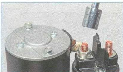
Головкой «на 13» отворачиваем гайку нижнего контактного болта тягового реле и снимаем с него наконечник провода.
