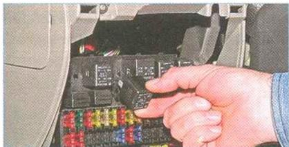
**...вынимаем из монтажного блока реле стартера.**
