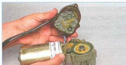
...и снимаем крышку редуктора с прокладкой.
