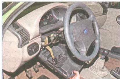
Снимаем нижний кожух.
