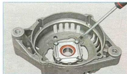
...шлицевой отверткой отворачиваем четыре винта крепления прижимной пластины подшипника.
