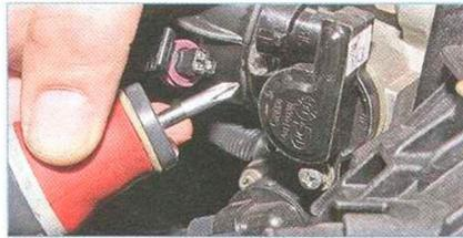
Крестообразной отверткой отворачиваем два винта крепления датчика.
