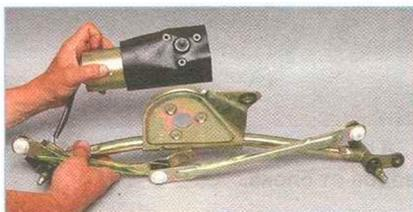
...и снимаем мотор-редуктор с кронштейна.
