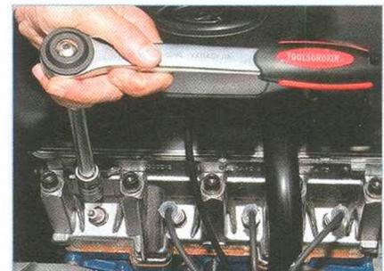
Высокой головкой «на 21» с удлинителем (или свечным ключом) выворачиваем свечу.
