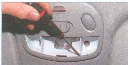
**... отверткой отжимаем облицовку плафона и выводим из зацепления две защелки облицовки.**
