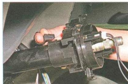
...отсоединяем колодку жгута проводов от соединителя.
