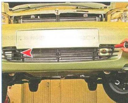
Крестообразной отверткой отворачиваем два самореза крепления решетки к бамперу...
