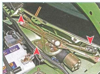
Головкой «на 10» отворачиваем два болта и ключом того же размера гайку крепления очистителя.
