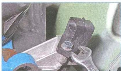
Ключом «на 10» отворачиваем болт крепления датчика.
