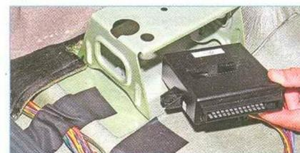
...и вынимаем блок из кронштейна кузова.
