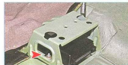
Головкой «на 10» с удлинителем отворачиваем две гайки крепления блока...
