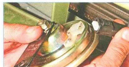
Отсоединяем колодку проводов от звукового сигнала.
