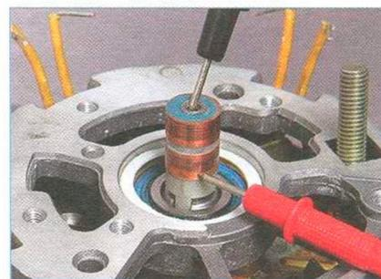
Для проверки короткого замыкания обмотки ротора на «массу» подсоедините щупы тестера к контактному кольцу и к валу ротора (или к шкиву). Омметр должен показать бесконечность, в противном случае обмотка замкнута на «массу».
