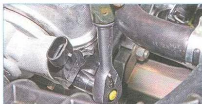
Головкой «на 10» отворачиваем болт крепления датчика...
