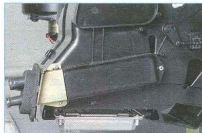
...вводим кронштейны контроллера в направляющие корпуса отопителя (для наглядности показано на демонтированном отопителе).
