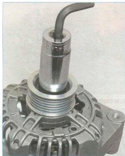
Надеваем на гайку крепления шкива высокую головку «на 24» и через ее отверстие вставляем шестигранник «на 8» в отверстие вала ротора.
