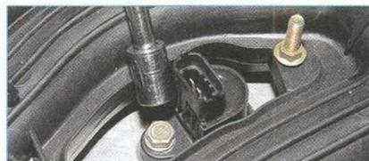
Головкой «на 10» отворачиваем болт крепления катушки зажигания...
