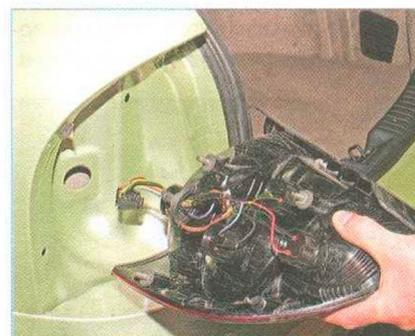
...снимаем фонарь, вытягивая провода с колодкой через отверстие в кузове.
