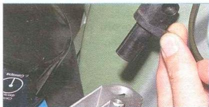
Вынимаем датчик из отверстия в приливе на корпусе масляного насоса.
