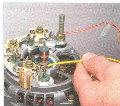
Для проверки замыкания в «положительных» вентилях «+» батареи через лампу соедините с выводом «В+» генератора, а «-» — с выводом одной из фазных обмоток статора. Если лампа горит, пробиты один или несколько положительных вентилях.
