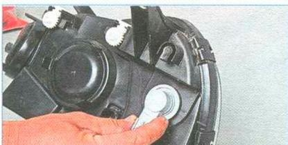
Поворачиваем патрон указателя поворота против часовой стрелки на 45° ...
