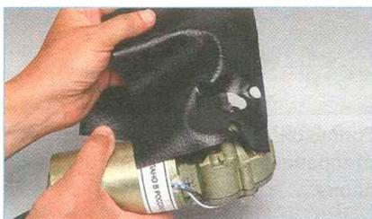
Снимаем защитную пленку с мотор-редуктора.
