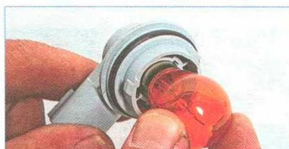
Нажав на лампу, поворачиваем ее до упора против часовой стрелки...
