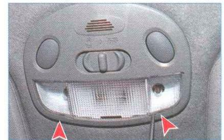
Вставляя поочередно лезвие отвертки в пазы рассеивателя, выводим из зацепления две защелки...
