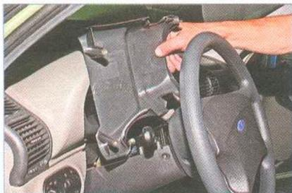
...снимаем верхний кожух рулевой колонки.
