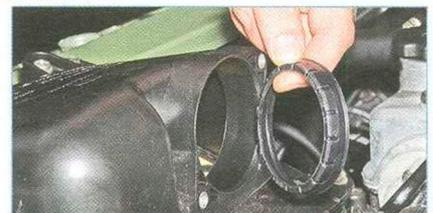
Снимаем уплотнительную втулку датчика.
