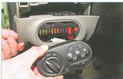
...и вынимаем блок из крышки панели приборов.
