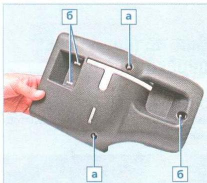
Расположение отверстий под винты а и саморезы б крепления нижнего кожуха
