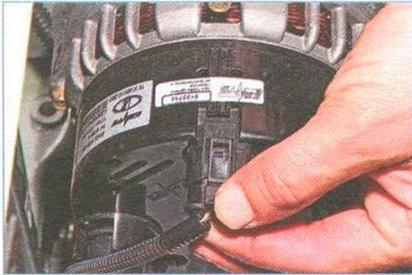
Нажав на фиксатор колодки провода предварительного возбуждения генератора ...
