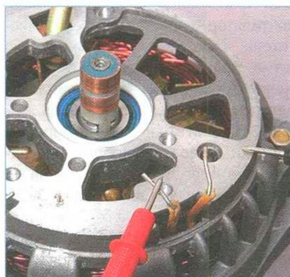
Для проверки замыкания обмотки статора на «массу» подсоедините щупы тестера к выводу обмотки и корпусу генератора. Омметр должен показать бесконечность, в противном случае обмотка замыкает на массу.
