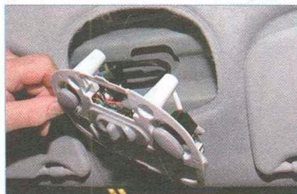
**Вынимаем плафон из отверстия в обивке.**
