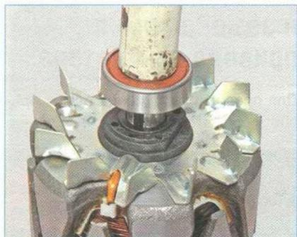
...и напрессовываем подшипник на задний конец вала оправкой или отрезком трубы подходящего диаметра, прикладывая усилие только к внутреннему кольцу подшипника.
