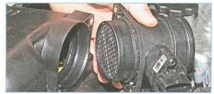
...и снимаем датчик.
