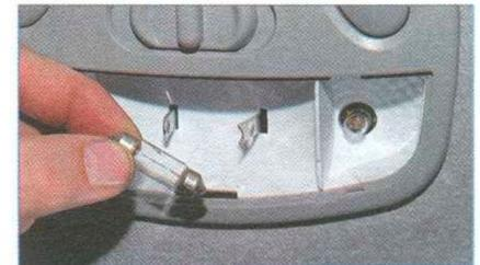
Вынимаем лампу из плафона...
