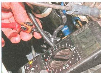
...прибор должен зафиксировать напряжение, приблизительно равное напряжению аккумуляторной батареи.
