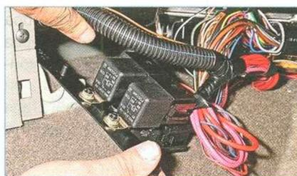
...и вынимаем кронштейн с блоком реле из-под консоли панели приборов.
