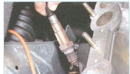
Снимаем управляющий датчик концентрации кислорода.
