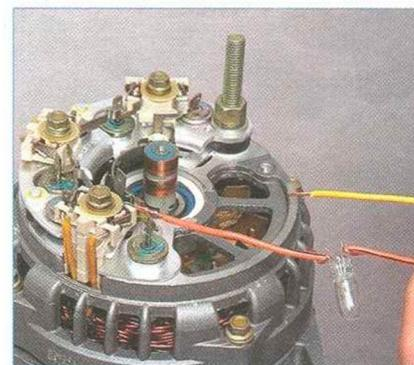
Для проверки замыкания в «отрицательных» вентилях «+» батареи через лампу соедините с выводом
