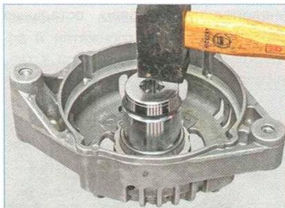
...запрессовываем его подходящей инструментальной головкой, прикладывая усилие к наружному кольцу подшипника.
