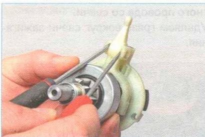
Двумя отвертками разжимаем проушину опоры и снимаем рычаг привода.
