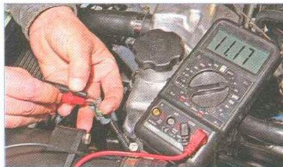
...должен выдавать напряжение бортовой сети на вывод «С» колодки жгута проводов.
