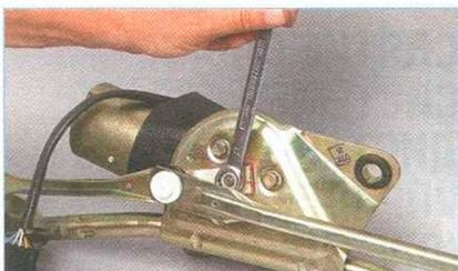
Ключом «на 13» отворачиваем гайку крепления кривошипа. Снимаем кривошип с вала мотор-редуктора.
