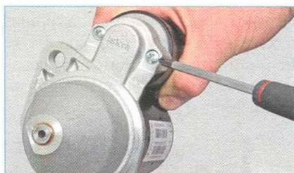
Крестообразной отверткой отворачиваем два винта крепления тягового реле...
