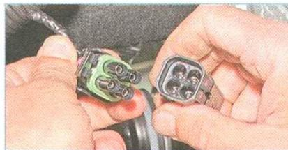
...и отсоединяем колодку жгута проводов системы управления двигателем от колодки жгута проводов датчика концентрации кислорода.
