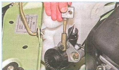
Вынимаем натяжное устройство в сборе.
