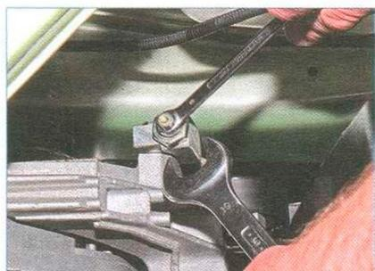
...и, удерживая шпильку, ключом «на 19» ослабляем затяжку ее контргайки.
