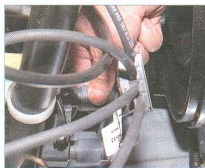
...снимаем с вывода катушки зажигания наконечник высоковольтного провода.
