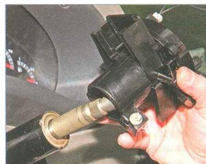
...и снимаем соединитель с рулевой колонки.
