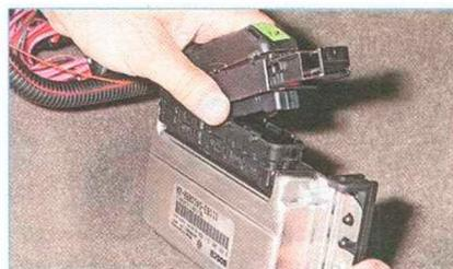
Снимаем колодку жгута проводов системы управления двигателем.
