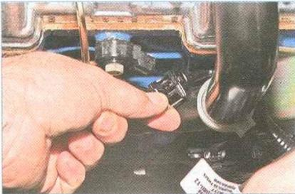
...и отсоединяем колодку жгута проводов от датчика детонации (для наглядности высоковольтные провода 2-го и 3-го цилиндров сняты, трос привода дроссельной заслонки отведен в сторону).
