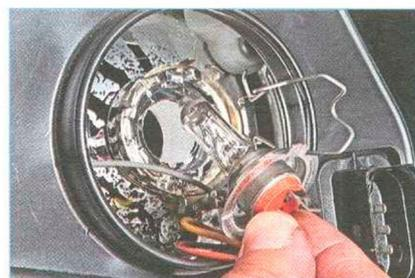
Вынимаем лампу из корпуса блок-фары.
