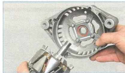
...и снимаем крышку. Для замены переднего подшипника...
