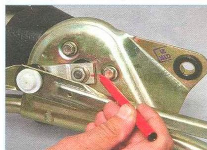
Маркером помечаем положение кривошипа относительно кронштейна очистителя.
