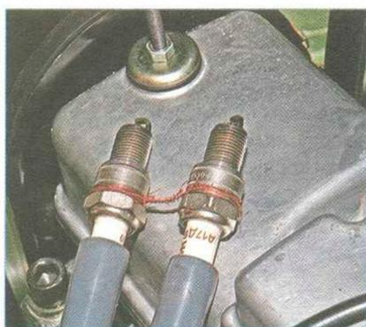
Связываем корпуса свечей отрезком неизолированного провода («массируем»).
