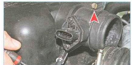
Головкой «на 10» с удлинителем отворачиваем два болта крепления датчика массового расхода воздуха к крышке корпуса воздушного фильтра...
