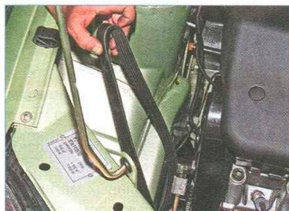
...и снимаем со шкивов генератора и коленчатого вала.
