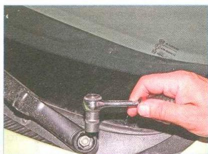
Головкой «на 13» отворачиваем гайку крепления рычага щетки.
