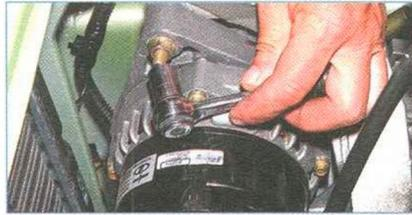
Головкой «на 13» отворачиваем гайку болта верхнего крепления генератора...
