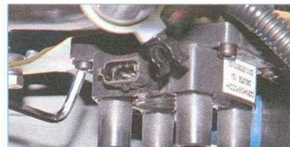
Шестигранным «на 5» отворачиваем четыре винта крепления катушки зажигания к кронштейну...
