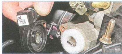
Снимаем датчик с дроссельного узла.
