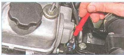
Подсоединив щупы тестера к выводу «А» колодки и к «массе» двигателя, измеряем сопротивление.
