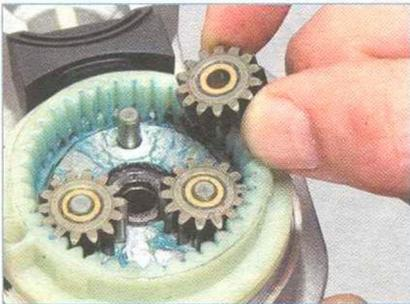
Вынимаем три сателлита планетарного редуктора привода.
