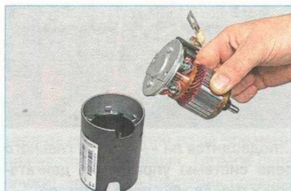
Вынимаем из корпуса якорь со щеткодержателем и задней крышкой.
