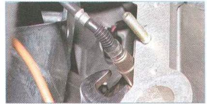
Ключом «на 22» выворачиваем датчик из отверстия катколлектора.
