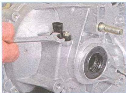
Ключом «на 10» отворачиваем гайку крепления датчика скорости...
