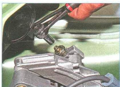
Головкой «на 8» вращаем регулировочную шпильку против часовой стрелки.
