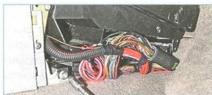
Головкой «на 10» отворачиваем гайку крепления кронштейна блока реле...
