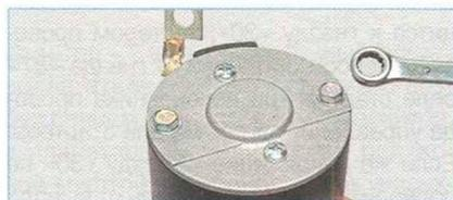
Ключом «на 8» отворачиваем два стяжных болта.
