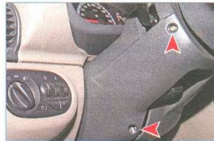
С левой стороны рулевой колонки крестообразной отверткой отворачиваем нижний винт и верхний саморез, соединяющие верхние и нижние кожухи рулевой колонки.
