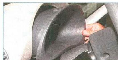
...и снимаем накладку комбинации приборов...
