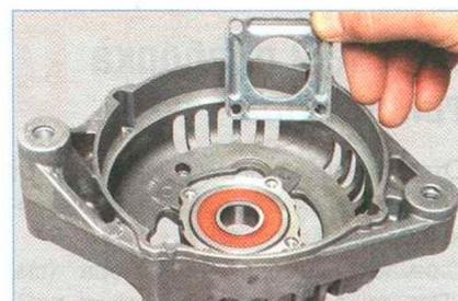
Снимаем прижимную пластину.
