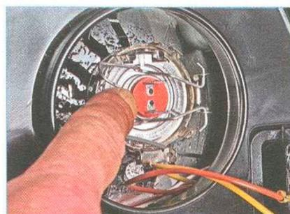
Выводим пружинный фиксатор из зацепления с двумя крючками...
