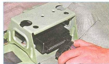
...и отсоединяем колодку жгута проводов от блока.
