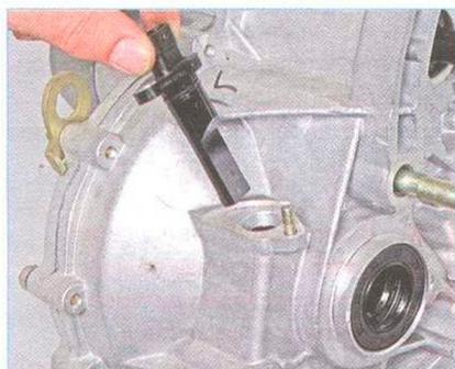
...вынимаем датчик из отверстия картера сцепления.
