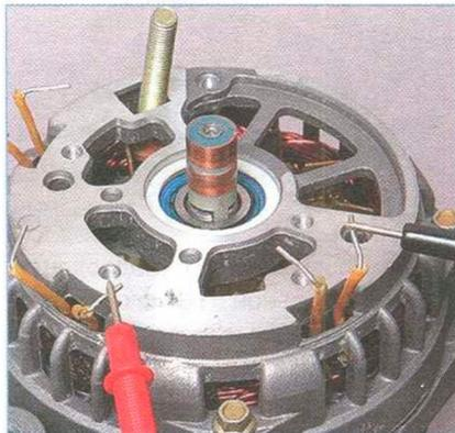
Для проверки короткого замыкания между обмотками статора подсоедините щупы тестера между выводами двух обмоток. Омметр должен показать бесконечность, в противном случае обмотки замкнуты между собой.
