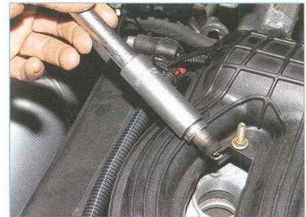
Высокой головкой с удлинителем или свечным ключом «на 16» выворачиваем свечу зажигания и вынимаем ее.
