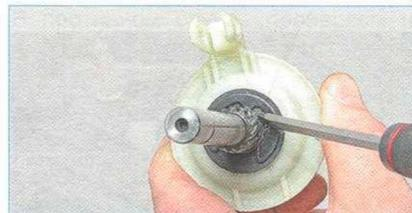
Отверткой сдвигаем из проточки вала стопорное кольцо и снимаем его.
