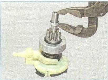
Ограничительное кольцо хода приводной шестерни устанавливаем на стопорное кольцо при помощи раздвижных пассатижей.
