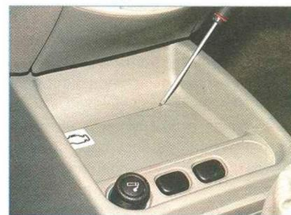
...поддеваем отверткой крышку облицовки туннеля пола...
