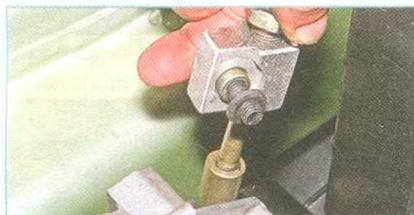
Снимаем с болта шайбу (расположенную с внутренней стороны кронштейна натяжного устройства), вынимаем болт и втулку.
