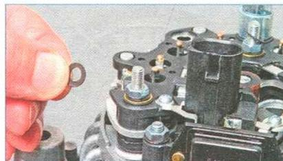
Снимаем со шпилек крепления кожуха три металлические шайбы.
