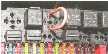
**Вставляем перемычку (отрезок провода) в гнезда силовых контактов реле «30» и «87».**
