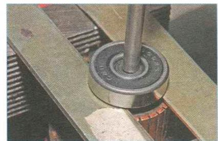
Вставляем две металлические пластины между подшипником и коллектором якоря и опираем их на губки тисков, нанося удары молотком, через выколотку из мягкого металла в торец вала, спрессовываем подшипник.
