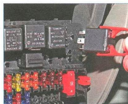
Большим пинцетом извлекаем реле большого размера.
