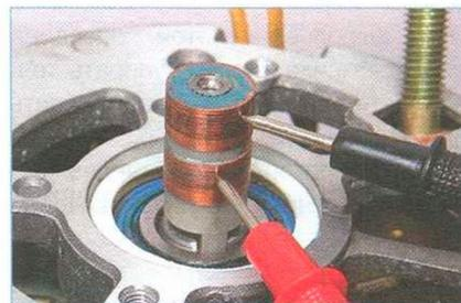
Для проверки обрыва обмотки ротора подсоедините щупы тестера к контактному кольцу. Если омметр показывает бесконечность, значит, в обмотке есть обрыв.
