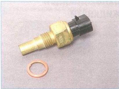
Соединение датчика с выпускным патрубком уплотняется медной шайбой.
