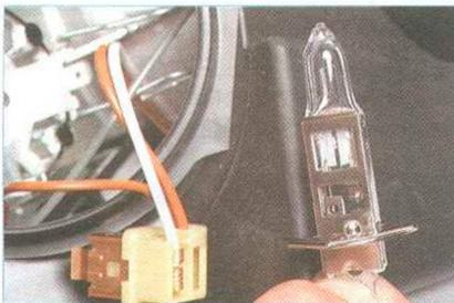
**Вынимаем лампу из корпуса блок-фары.**
