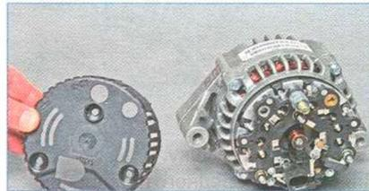
...и снимаем кожух.
