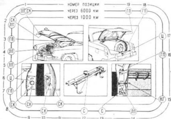
Рис. 63. Места смазки кузова автомобиля.
