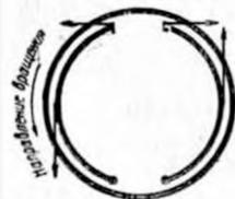
Тормозной барабан состоит из стального штампованного диска, залитого в чугунный обод, имеющий для улучшения охлаждения ребристую поверхность.
