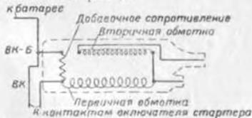
Рис. 65. Схема соединения обмоток индукционной катушки
