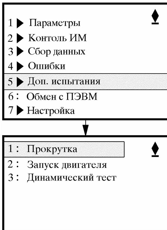
Рис. 14. Включение режима “Дополнительные испытания”
