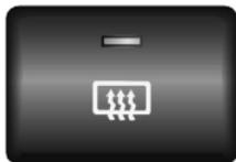
Обогрев заднего стекла работает только при включенном двигателе. Для включения обогрева нажмите на данную кнопку. При этом на кнопке загорится контрольная лампа включения обогрева заднего стекла. Чтобы выключить обогреватель, повторно нажмите на кнопку. Обогрев будет автоматически отключен через 15 секунд. Чтобы включить его еще раз, нажмите на кнопку после автоматического отключения обогрева.
