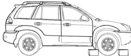
Для предотвращения перемещения автомобиля при поднятии его домкратом установите упорные башмаки под колесо, расположенное с противоположной стороны по диагонали от заменяемого колеса.
