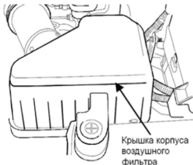
Замена воздушного фильтра производится в соответствии со сроками, указанными в сервисной книжке. Воздушный фильтр расположен в пластиковом корпусе рядом с двигателем в моторном отсеке.
