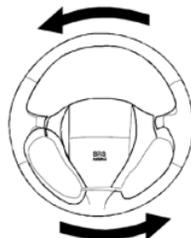
Чтобы проверить свободный ход рулевого колеса, установите все четыре колеса параллельно продольной оси автомобиля и слегка поверните рулевое колесо в обоих направлениях. Не нажимайте на руль сильно, постарайтесь почувствовать разницу сопротивления вращению рулевого колеса, которая указывает на границы свободного хода.
