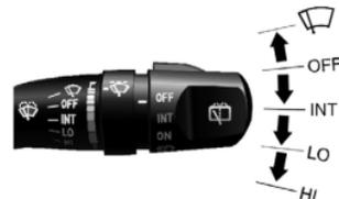
Функция стеклоочистителя контролируется комбинированным переключателем, находящимся справа от рулевого колеса.
