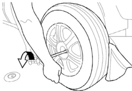
Перед тем, как поднять автомобиль, необходимо ослабить затяжку колесных гаек. Ослабьте все гайки, повернув их баллонным ключом против часовой стрелки. На этом этапе не отворачивайте колесные гайки полностью.
