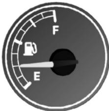
Стрелка данного указателя показывает уровень топлива в топливном баке.
