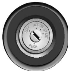
При открытии двери загорится подсветка замка зажигания. Подсветка выключается приблизительно через 10 секунд после того, как дверь будет закрыта или после поворота ключа зажигания в положение «ON» (вкл.).
