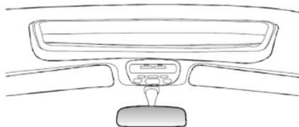
На внутреннем зеркале заднего вида отображается сигнал от датчиков парктроника (дополнительное оборудование). При движении автомобиля назад включаются задние датчики парктроника, при этом загораются фонари заднего хода и включается звуковой сигнал.
