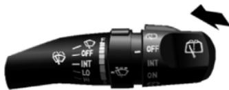
Омывающая жидкость будет подаваться на лобовое стекло при перемещении рычага переключателя стеклоочистителя / омывателя в сторону рулевого колеса. При перемещении рычага автоматически включатся стеклоочистители. Омыватель перестанет работать, как только Вы отпустите переключатель стеклоочистителя / омывателя лобового стекла.
