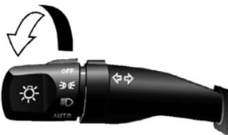
Освещение контролируется вращающимся регулятором, расположенным на комбинированном переключателе слева от рулевого колеса. Чтобы включить стояночный фонарь, задние габаритные огни, подсветку приборной панели и подсветку CD плеера, поверните регулятор переключателя в положение . Чтобы включить передние фары, поверните регулятор переключателя в положение . При повороте регуля-
