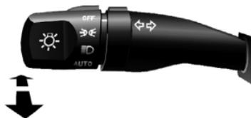
Для включения дальнего света фар нажмите на переключатель от себя и отпустите, когда услышите щелчок. При этом на панели приборов загорится контрольная лампа включения дальнего света. При переводе рычага обратно на себя, свет переключается с дальнего на ближний.
