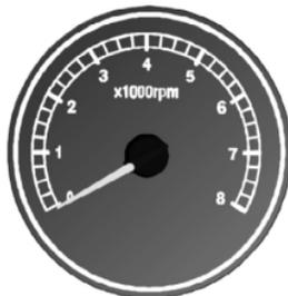
Тахометр показывает частоту вращения коленчатого вала двигателя в оборотах в минуту (об/мин.).
