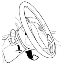
Данный рычаг расположен слева под рулевым колесом. Для регулировки рулевого колеса переведите рычаг вниз и удерживайте его, это позволит разблокировать рулевое колесо. Под-
