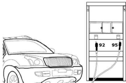
Для заправки Вашего автомобиля TAGAZ C190 необходимо использовать неэтилированный бензин с октановым числом 92 или выше. Использование этилированного бензина приведет к выходу из строя каталитического нейтрализатора выхлопных газов, а также к увеличению расходов на техническое обслуживание.
