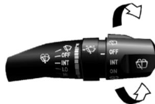
Функция стеклоочистителя и омывателя заднего стекла контролируется вращающимся регулятором на комбинированном переключателе, находящемся справа от рулевого колеса.
