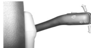
Щетки стеклоочистителя могут работать в четырех режимах: быстром, ускоренном,
