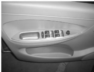
Когда ключ зажигания находится в положении «2», Вы можете опускать и поднимать стекла с помощью кнопки. Для того, чтобы опустить стекло, нажмите переключатель в нижнем положении. Для того, чтобы поднять стекло, нажмите переключатель в верхнем положении. Отпустите кнопку, чтобы остановить движение стекла, достигшего нужного положения.
