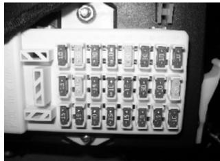
Центральный блок предохранителей расположен во вспомогательном боксе панели приборов со стороны водителя. Все электрические цепи автомобиля снабжены предохранителями. Мы рекомендуем Вам всегда иметь несколько запасных предохранителей для замены.
