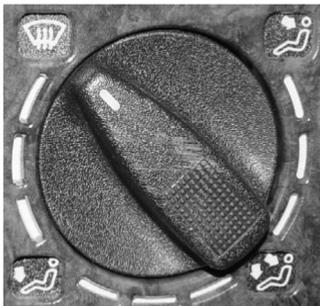
Распределитель потока воздуха используется для выбора направления потока воздуха. Он имеет четыре положения:
