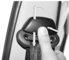
Регулировка ремня по высоте производится регулирующим анкерным устройством.
