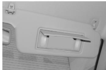
Зеркало расположено на тыльной стороне правого козырька. Правый козырек имеет те же функции и регулируется так же как и левый, но оборудован зеркалом. При открытии зеркала включается подсветка.
