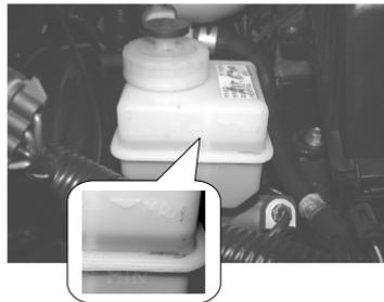
Перед заливкой тормозной жидкости очистите пробку бачка. Снимите пробку, налейте тормозную жидкость до отметки "MAX" на бачке и плотно закрутите пробку.
