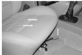
Потяните рычаг регулировки вверх и удерживайте его. Установите сиденье в нужное положение и опустите рычаг. Убедитесь, что фиксатор сработал и сиденье заблокировано.
