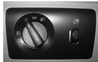
При помощи данного регулятора можно включить передние и задние противотуманные фары. Чтобы включить передние противотуманные фары, нужно перевести регулятор в первое положение (включение габаритных огней) и потянуть его на себя до первого положения. Потянув регулятор до второго положения, Вы включите дополнительно задние противо-
