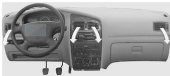
Воздух поступает из дефлекторов на панели приборов и боковых вентиляционных отверстий в верхнюю часть салона автомобиля.
