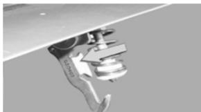
3. Вставьте опорный рычаг в отверстие капота.
