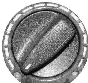
Регулятором температуры можно плавно регулировать температуру подаваемого воздуха. При включенном кондиционере поверните регулятор влево для снижения температуры воздуха или вправо для увеличения.
