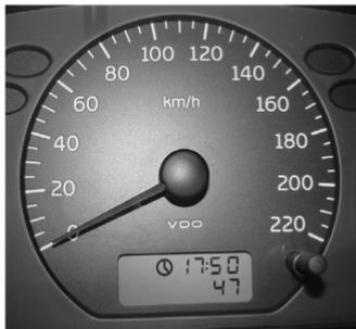
Спидометр показывает скорость движения автомобиля в км/ч. Необходимо следовать указаниям относительно скорости движения в период обкатки.
