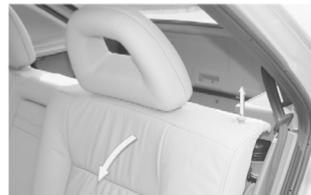
Чтобы поставить спинку заднего сиденья вертикально, приподнимите его до фиксированного положения. Убедитесь, что спинка зафиксирована.
