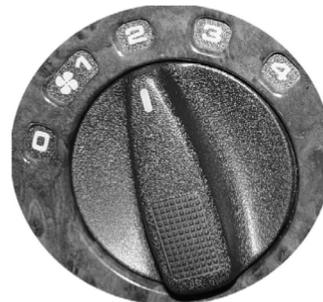
Этот переключатель используется для включения и выключения вентилятора и выбора скорости его вращения. Скорость вращения вентилятора и, следовательно, величина воздушного потока, поступающего из системы вентиляции, может изменяться вручную путем поворота этого переключателя между положениями «1» (минимальная скорость) и «4» (максимальная скорость).
