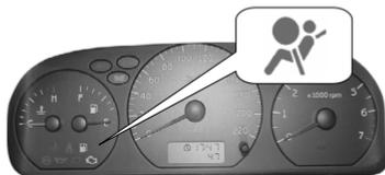
Индикатор неисправности подушек безопасности горит в течение 6 секунд после перевода замка зажигания в положение 2.
