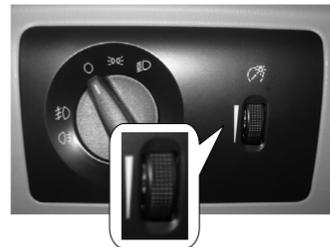
Интенсивность подсветки панели приборов можно настроить с помощью регулятора, показанного на рисунке выше.
