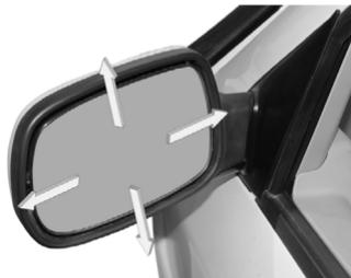
2. Установите кнопку в положение «R» для регулировки правого зеркала, а затем двигайте ручку управления в нужных направлениях.
