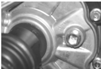
Заливайте только рекомендованное масло. Проверьте коробку передач на отсутствие протечек и повреждений после закручивания пробки.
