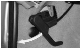
2. Подвиньте защелку, расположенную под капотом, назад и приподнимите капот как показано на рисунке.
