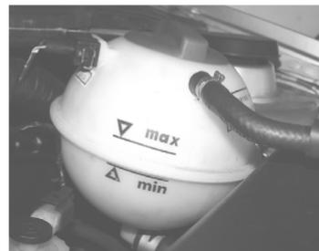
На холодном двигателе уровень охлаждающей жидкости считается нормальным, если он находится между отметками **MIN** и **MAX** расширительного бачка. При нагреве двигателя уровень жидкости в расширительном бачке может меняться. Если уровень находится ниже отметки **MIN**, долейте охлаждающую жидкость, но не выше отметки **MAX**.
