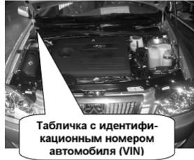
Идентификационный номер автомобиля (номер шасси) выбит на табличке в моторном отсеке.
