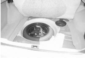
Инструменты и запасное колесо размещены в отделении для запасного колеса под отделением багажника.
