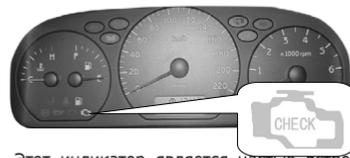
Этот индикатор является частью встроенной системы диагностики автомобиля, контролирующей работу системы управления двигателем. Данная лампа загорается при повороте ключа зажигания в положение «ON» (вкл.), через несколько секунд она должна погаснуть. Если эта лампа загорается во время движения автомобиля или не загорается после поворота ключа в положение «ON» (вкл.), как можно скорее обратитесь на СТО дилерской сети ООО «ТагАЗ» для проверки системы.
