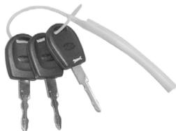
Автомобиль комплектуется тремя ключами. Один из ключей – сервисный. Он имеет соответствующую метку и им нельзя открыть замок багажника. Номер ключей указан на табличке. В целях безопасности табличку следует хранить в надежном месте вне автомобиля. Это позволит избежать копирования Вашего ключа злоумышленниками.
