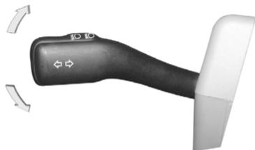
Указатели поворотов работают только при включенном зажигании.
