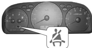
Когда ключ зажигания находится в положении «2», а водитель не пристегнут ремнем безопасности, загорится индикатор ремня безопасности.
