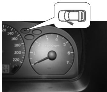
Данный индикатор загорится если одна из дверей не закрыта или закрыта неплотно.
