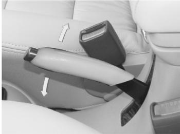
Во избежание самопроизвольного движения автомобиля после парковки поднимите рычаг стояночного тормоза. Если включено зажигание, в этот момент на панели приборов загорится индикатор стояночного тормоза.
