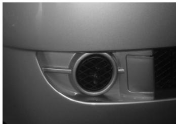
Передние противотуманные фары обеспечивают освещение с большой степенью рассеивания в плохих погодных условиях (например, сильный туман). Они обеспечивают Вашу безопасность и безопасность других участников движения.
