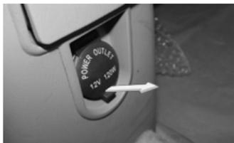
Розетка резервного питания предназначена для дополнительного электрического оборудования. Откройте крышку, чтобы подключить электрооборудование. После использования розетки закройте крышку.
