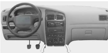
При выборе режима вентиляции «в область ног» воздух поступает через дефлекторы в область ног.
