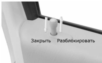
Если Вы покидаете автомобиль, водительскую дверь можно закрыть только ключом.
