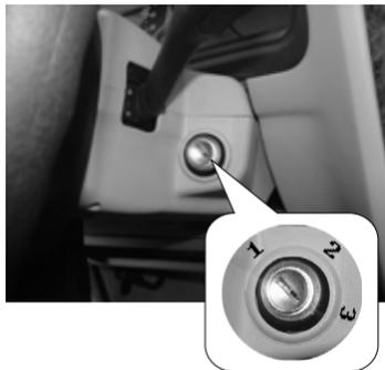
Положение 1: В данном положении ключа зажигания система зажигания выключена, радио и сигнал не работают.
