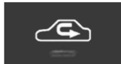
При включении данного режима на кнопке загорится индикатор. Этот режим используется для того, чтобы предотвратить попадание в салон выхлопных газов и задымленного или запыленного воздуха с улицы, или для того, чтобы поддерживать температуру внутри салона на необходимом уровне.
