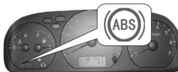
После поворота ключа зажигания в положение 2 загорается контрольная лампа неисправности антиблокировочной системы тормозов. Через несколько секунд она должна погаснуть. Если эта лампа не гаснет или загорается во время движения, обратитесь на СТО дилерской сети ООО «ТагАЗ» для диагностики. Даже в случае неисправности ABS основная тормозная система будет продолжать работать.
