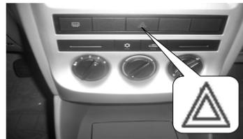
Нажмите переключатель аварийной сигнализации на панели приборов и все указатели поворотов заработают одновременно. Нажмите еще раз и указатели по-
