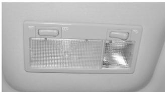
Система салонного освещения оборудована двумя выключателями.
