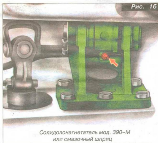
Рис. 14. Смазка пальцы передних рессор. Солидолонагнетатель моделей 390-М, мод. 142, шприц для смазывания
