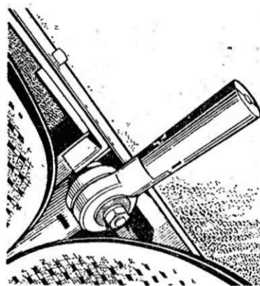
Рис. 14. Рукоятка механизма регулировки жесткости подвески сиденья водителя
