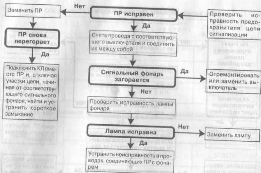
Рис. 154. Не работают сигнализаторы заднего хода и торможения
