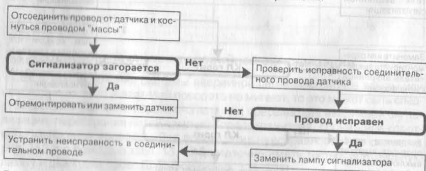
Рис. 155. Не работают сигнализаторы аварийных режимов
