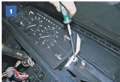
1 Отворачиваем четыре самореза крепления комбинации панели приборов.
