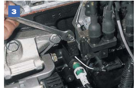
Ключом «на 10» отворачиваем болт крепления конденсатора к кронштейну генератора и снимаем конденсатор.
