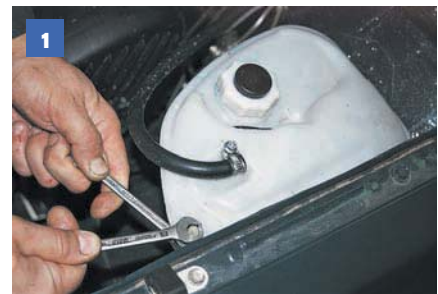
Двумя ключами «на 10» отворачиваем болт крепления расширительного бачка к брызговику.
