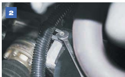
2 Ключом «на 10» отворачиваем второй болт крепления щитка к картеру сцепления...
