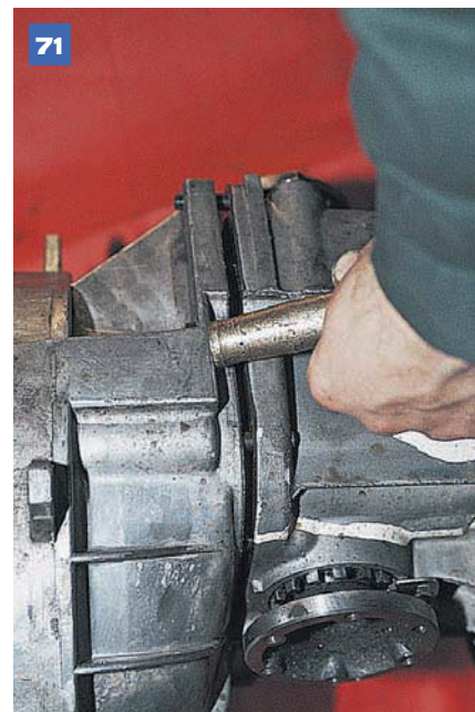
71 Выколоткой из мягкого металла разъединяем картер сцепления и картер главной передач...
