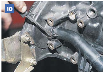
Поддев отверткой за выступ, снимаем патрубок.
