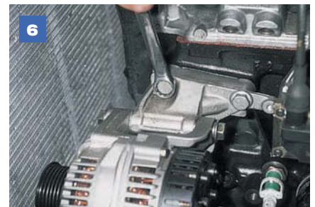
Опустив генератор, ключом «на 16» отворачиваем два верхних болта кронштейна.
