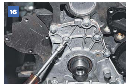
Головкой E-8 отворачиваем восемь болтов крепления передней крышки блока цилиндров (два нижних болта длинные — 30 мм).
