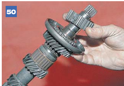
50 Снимаем ступицу синхронизатора и ведущую шестерню 3-й передачи.
