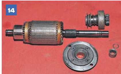
14 Снимаем с якоря упорное кольцо, привод в сборе (бендикс) и подшипник в сборе.
