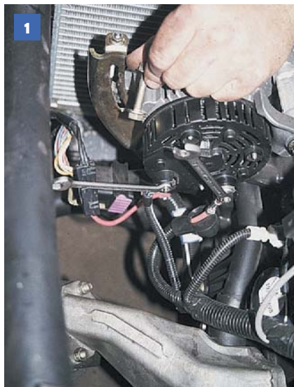
Ключами «на 8» и «на 10» отворачиваем гайки клемм провода цепи возбуждения и плюсового.
