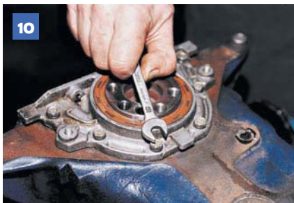
10 Ключом «на 10» отворачиваем шесть болтов задней крышки...
