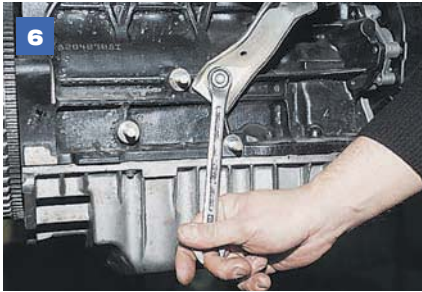
Ключом «на 17» отворачиваем гайку крепления кронштейна выхлопного коллектора к блоку цилиндров. Отвернув болт крепления кронштейна к коллектору, снимаем кронштейн.
