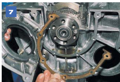
Снимаем крышку и прокладку.
