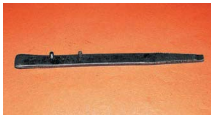
Монтажная лопатка с отверстиями (в них вставлены болты) для отворачивания верхней гайки амортизаторной стойки.
