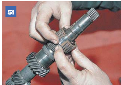
51 Раскрываем замок сепаратора и снимаем игольчатый подшипник.
