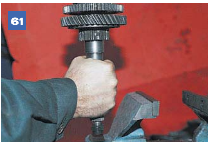
61 Постукивая вторичным валом о твердую поверхность,...
