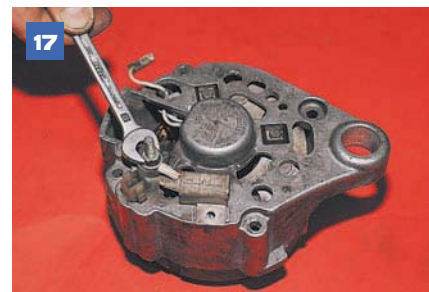
17 Ключом «на 10» отворачиваем гайку болта вывода генератора, снимаем конденсатор, шайбы и болт вывода.
