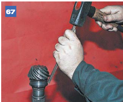
67 Выколоткой из мягкого металла сбиваем с вала внутреннее кольцо подшипника.
