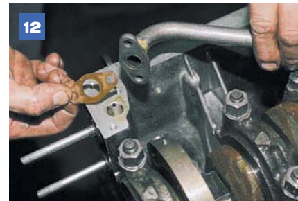
Снимаем маслоприемник и прокладку.
