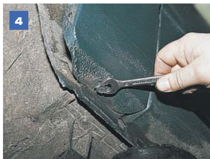
4 Этим же ключом отворачиваем болт нижнего крепления переднего крыла, расположенный под днищем возле передней двери.
