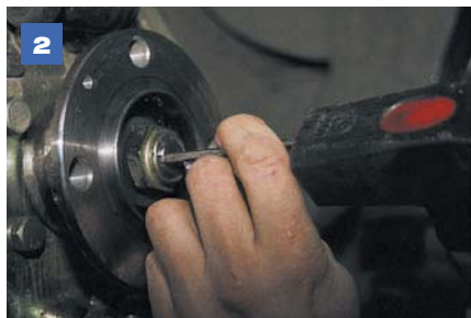
2 Маленьким зубилом выправляем две вмятины буртика гайки.
