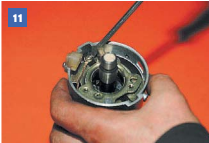
Отворачиваем два винта крепления неподвижной пластины...
