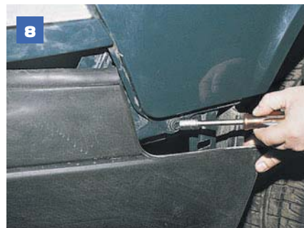
8 Саморез бокового крепления крыла можно отвернуть, не снимая переднего бампера, а только отвернув его боковое крепление и отогнув вниз.
