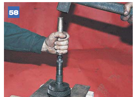
58 При отсутствии подходящего съемника подкладываем под края синхронизатора обрезки досок, и через выколотку из мягкого металла выбиваем вал вниз.
