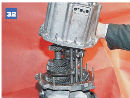
32 Снимаем картер коробки передач. Извлекаем из отверстия три шарика фиксаторов.
