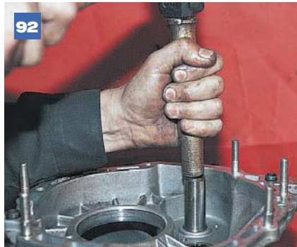
92 Выбиваем ось выколоткой из мягкого металла.
