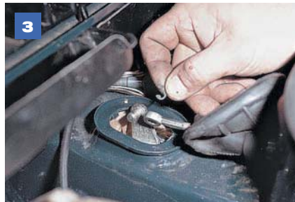
3 Снимаем наконечник троса с пальца рычага.
