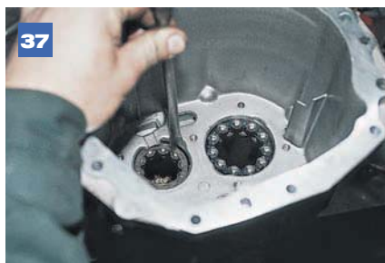
37 Постукивая попеременно с двух сторон по наружному кольцу подшипника ведущего вала, выпрессовываем его из картера.
