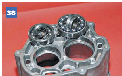
38 Аналогично выпрессовываем подшипник ведомого вала.
