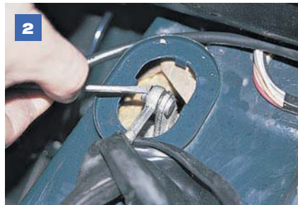
2 Отверткой снимаем стопорную шайбу.
