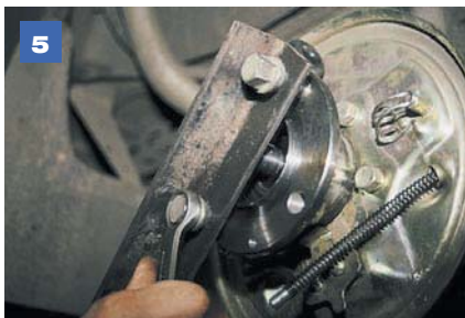
5 Заворачиваем штатные колесные болты в ступицу через отверстия пластины.
