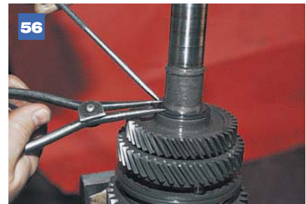
56 Щипцами снимаем стопорное кольцо...
