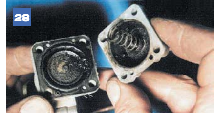
...снимаем крышку диафрагменного устройства системы пуска.
