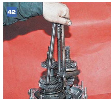
42 Вынимаем последовательно три штока, начиная с левого.
