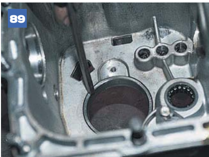
89 Выбиваем кольцо подшипника.
