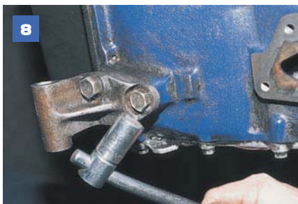
8 Головкой «на 17» отворачиваем два болта крепления кронштейна генератора и снимаем кронштейн.
