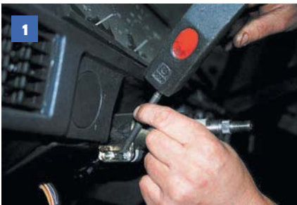
Если головки уже срезаны, то отворачиваем болты зубилом и молотком.
