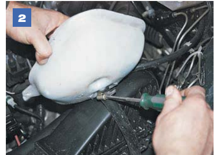
Ослабляем хомуты паропроводящей и наполнительной трубок и снимаем их.
