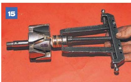
15 ...который демонтируем съемником.
