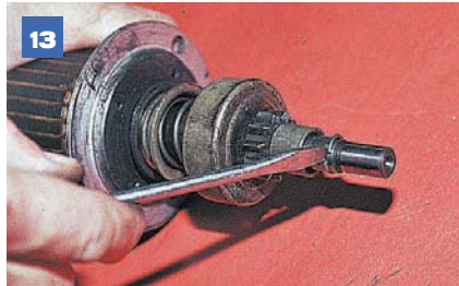
13 Поддеваем отверткой и снимаем замковое кольцо.
