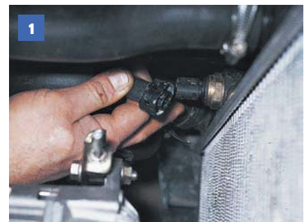
Отсоединяем разъем датчика электроклапана...
