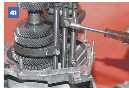
41 ...и отворачиваем три фиксатора вилок головкой «на 10».
