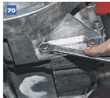
70 Ключом «на 17» отворачиваем пять гаек снаружи картера сцепления.
