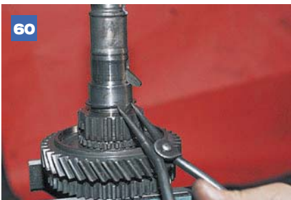
60 Снимаем сегментную шпонку и стопорное кольцо.
