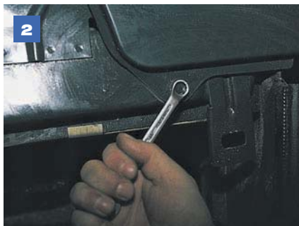
2 Ключом «на 10» отворачиваем болт бокового крепления...
