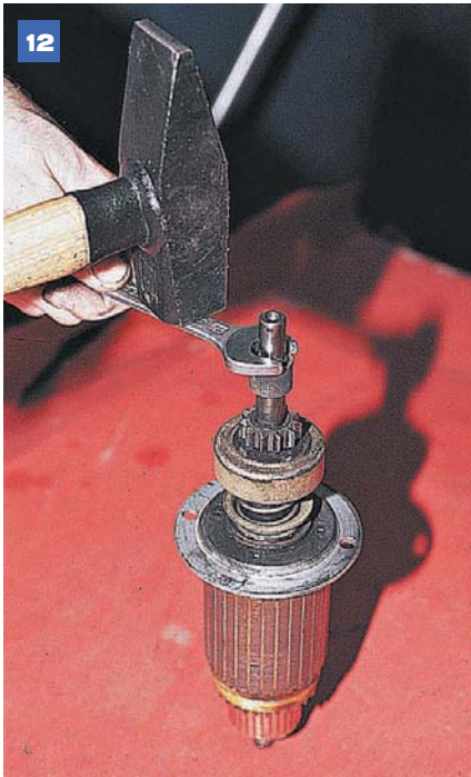
12 Оперев ось якоря на деревянный брусок, через ключ «на 14» сбиваем упорное кольцо.
