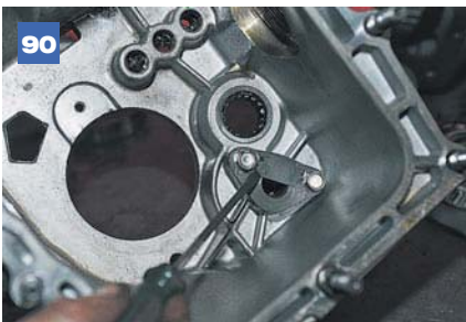
90 Отгибаем усы, контрящие болты крепления оси шестерни заднего хода...
