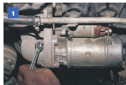
1 Ключом «на 12» отворачиваем три болта крепления стартера к картеру сцепления.
