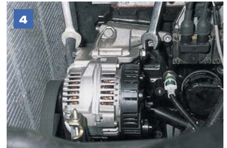
Двумя ключами «на 16» ослабляем болт крепления правой проушины генератора к кронштейну.
