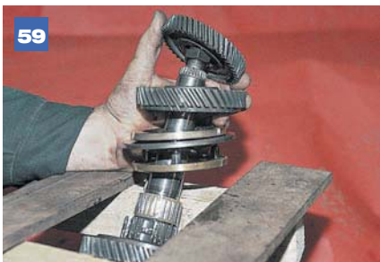
59 Снимаем шестерни 3-й и 2-й передач, синхронизатор и игольчатый подшипник.
