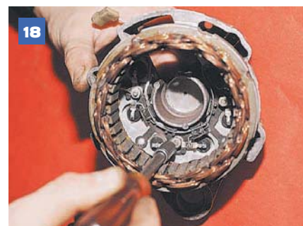
18 Головкой «на 8» отворачиваем три гайки крепления клемм стартера к выпрямительному блоку.
