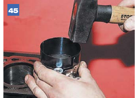
Вставив юбку поршня в цилиндр, обстукиваем оправку для лучшего ее прилегания к плоскости блока.
