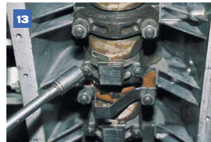
13 Головкой «на 15» отворачиваем гайки шатунных болтов.
