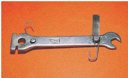
Щупы круглые для проверки зазоров между электродами свечей.
