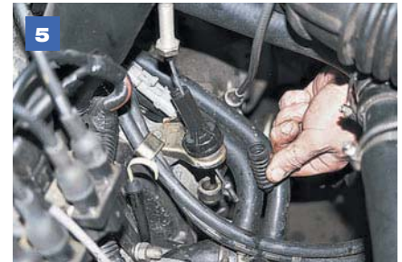
5 Вынимаем трос из кронштейна. Установку троса проводим в обратной последовательности.
