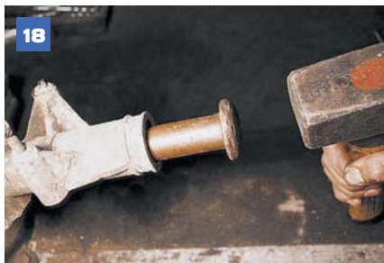
18 Через выколотку из мягкого металла наносим несколько ударов в торец рейки.
