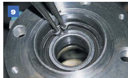
9 Круглогубцами с острыми концами снимаем стопорное кольцо.
