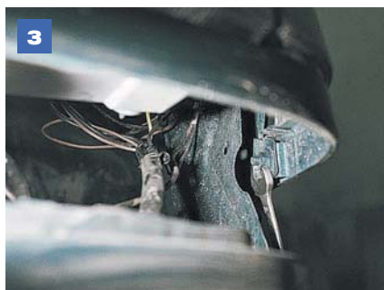
3 ...и гайку крепления крыла к накладке передней решетки моторного отсека.
