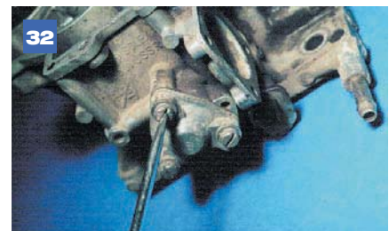
Отвернув три винта крышки диафрагменного устройства экономайзера,...
