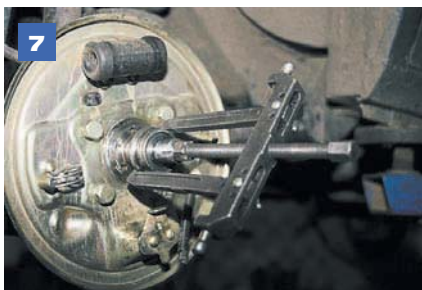
7 Как только между кольцом подшипника и упорным буртиком цапфы появится зазор, можно воспользоваться съемником.
