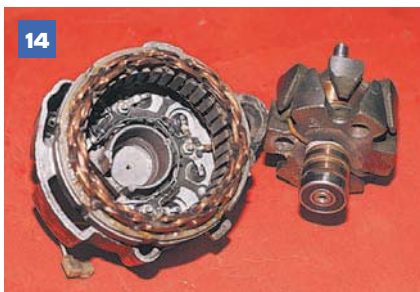
14 Ротор выходит из крышки вместе с подшипником,...
