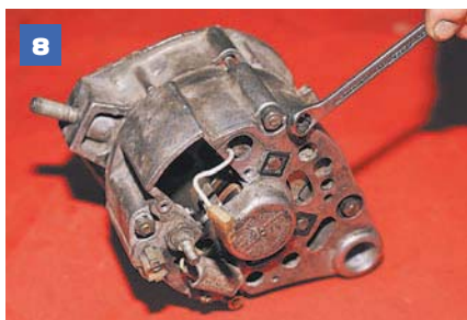
8 Ключом «на 10» отворачиваем четыре гайки...
