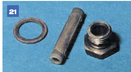
...вместе с фильтром и уплотнительным кольцом.
