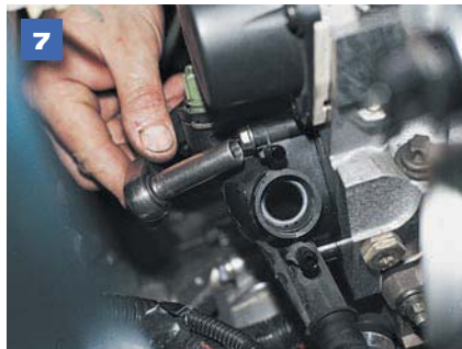
Головкой «на 10» отворачиваем три болта крепления корпуса термостата к головке блока цилиндров...
