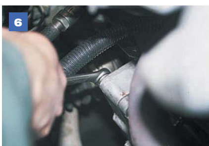
6 Ключом «на 17» отворачиваем три болта крепления стартера к картеру сцепления.
