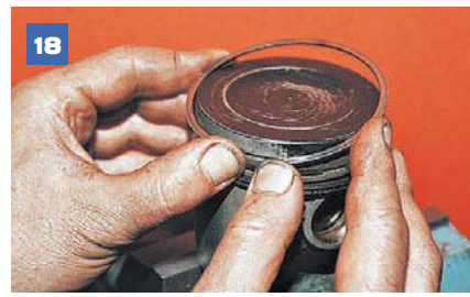
18 Зажав шатун в тиски, снимаем два компрессионных...
