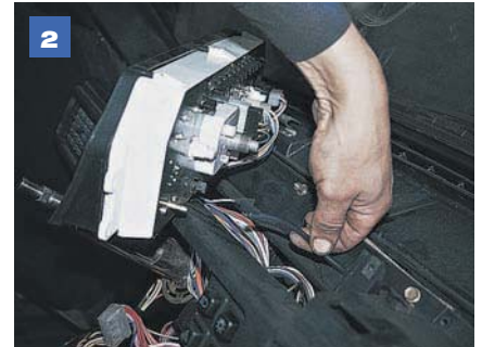
2 Отсоединяем трос привода спидометра, хлорвиниловую трубку эконометра.
