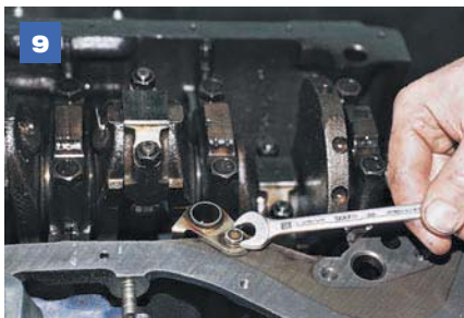
9 Ключом «на 10» отворачиваем болт кронштейна сливной трубки и снимаем кронштейн.
