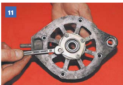
11 Для замены переднего подшипника ключом «на 8» отворачиваем четыре гайки, снимаем крышку подшипника...
