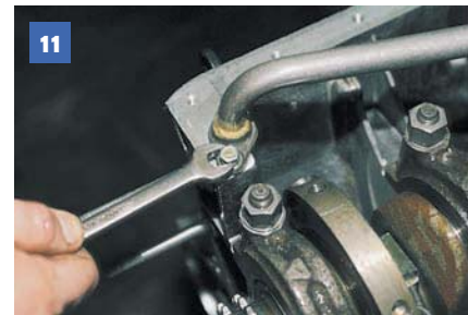
11 Ключом «на 10» отворачиваем два болта крепления маслоприемника к блоку цилиндров.
