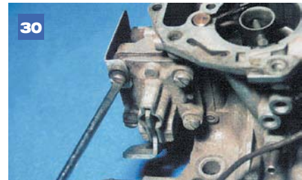
Отвернув четыре винта крышки механизма ускорительного насоса,...
