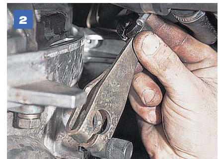
2 Разжимаем отверткой прорезь рычага и снимаем его.
