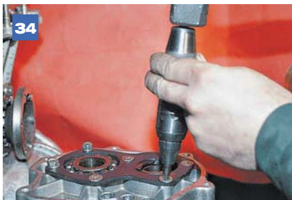
34 Ударной отверткой отворачиваем четыре винта...
