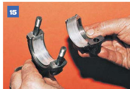
15 В нижних головках и крышках шатунов установлены сталеалюминиевые вкладыши. Для фиксации вкладышей на них выполнены замки, которые входят в соответствующие прорези постелей.
