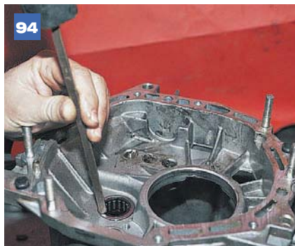
94 Выбиваем кольцо подшипника.
