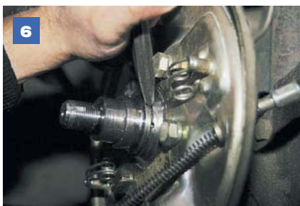
6 Обычно внутреннее кольцо подшипника остается на цапфе и снимать его придется молотком и зубилом.
