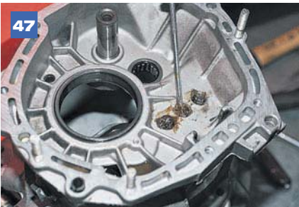
47 В сверлениях картера расположены замки. Чтобы они не выпали при разборке, забываем отверстия консистентной смазкой.
