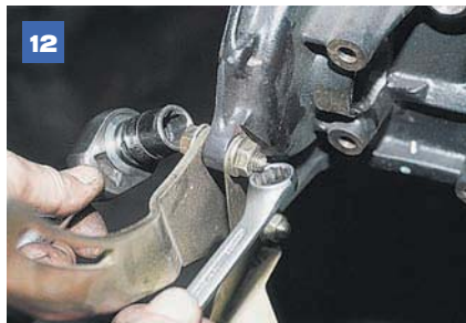
Ключами «на 16» отворачиваем два болта крепления натяжного кронштейна генератора и кронштейна колодки моторного жгута проводов.
