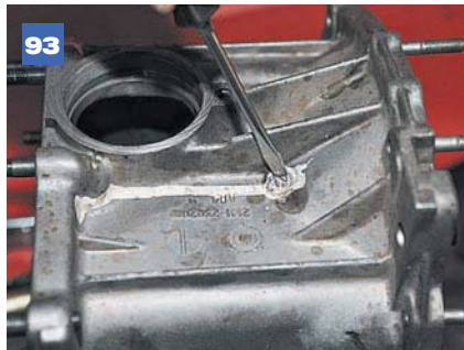
93 Отворачиваем винт крепления наружного кольца подшипника первичного вала.
