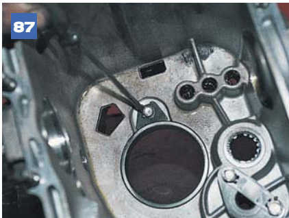
87 Отгибаем стопорные усы болта крепления наружного кольца подшипника вторичного вала...
