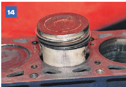
14 Извлекаем поршень с шатуном.
