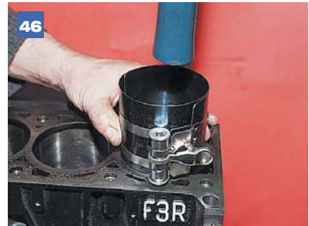
Рукояткой молотка упираемся в днище поршня и вдавливаем его в цилиндр.
