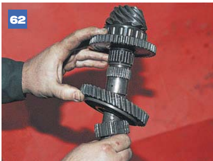
62 ...сбиваем ступицу синхронизатора и шестерню 1-й передачи, снимаем подшипник.
