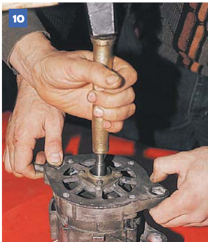
10 Удерживая генератор за переднюю крышку, выбиваем через оправку из мягкого металла ротор вместе с задней крышкой.
