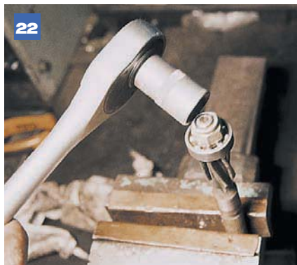
22 Зажав шестерню в тиски с мягкими губками, головкой «на 17» отворачиваем гайку крепления подшипника.
