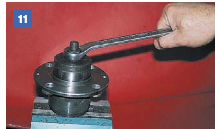
11 Очищаем и смазываем посадочную поверхность и тем же приспособлением запрессовываем новый подшипник. На этот раз шайба упирается в наружное кольцо подшипника.
