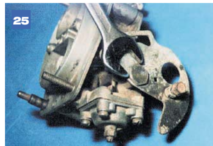
Ключом «на 14» отворачиваем болт крепления трехпрофильного рычага воздушной заслонки...
