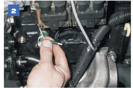
Отсоединяем разъем провода конденсатора.
