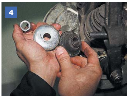
...и снимаем чашки и задние половины шарниров.
