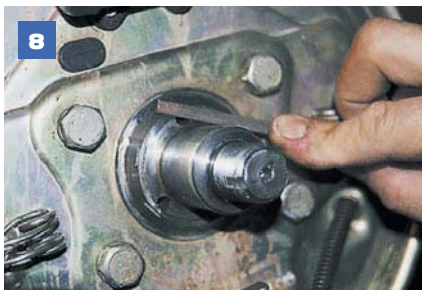
8 Забоины на упорном буртике цапфы убираем надфилем.
