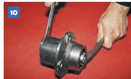
10 Вкладываем снятое с цапфы внутреннее кольцо в подшипник на шарики и съемником выпрессовываем подшипник. Шайба съемника при этом опирается на внутреннее кольцо.
