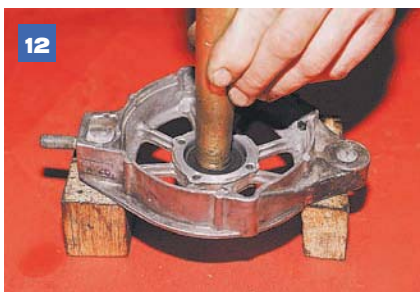
12 ...и выбиваем его. Новый подшипник запрессовываем, нанося удары по наружному кольцу через подходящий отрезок трубы.
