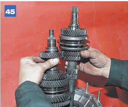
45 Вынимаем первичный и вторичный валы вместе.
