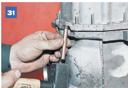
31 Разъединяем части картера, постукивая по ним через выколотку из мягкого металла.
