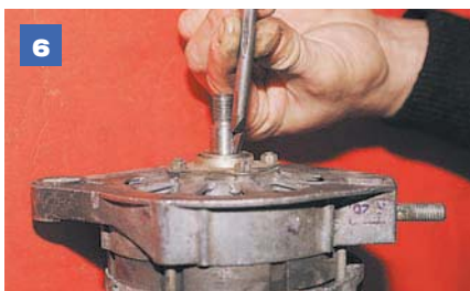
6 Маленьким зубилом удаляем из вала шпонку...
