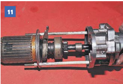
11 Вынимаем якорь из передней крышки.
