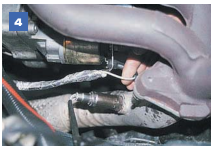
4 Снимаем провод с клеммы тягового реле стартера.
