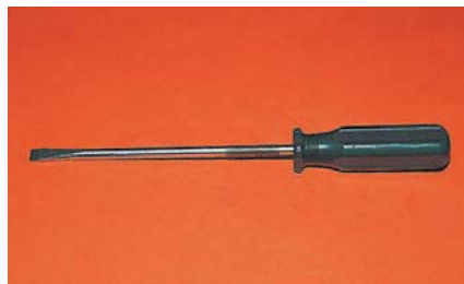
Шлицевая отвертка: толщина жала 0,4–2,0 мм, ширина 2,5–8,0 мм.
