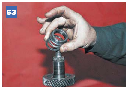
53 Снимаем со вторичного вала внутреннее кольцо подшипника и регулировочные шайбы.
