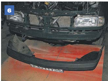
6 Отвернув два самореза нижнего крепления, снимаем бампер.
