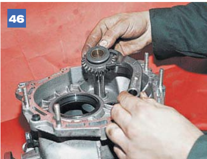
46 Снимаем вилку и шестерню заднего хода.
