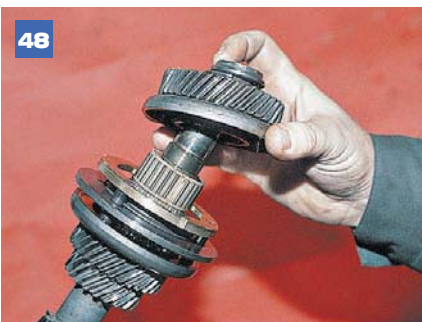
48 Снимаем с первичного вала внутреннее кольцо подшипника, упорное кольцо и ведущую шестерню 4-й передачи.
