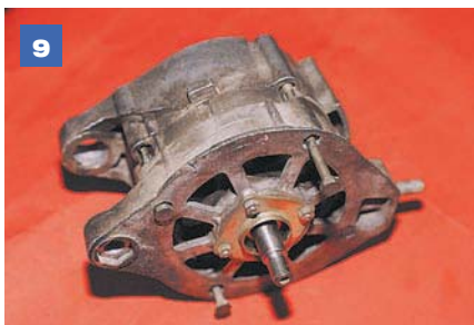
9 ...и вынимаем болты, стягивающие крышки генератора.
