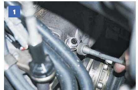
1 Отворачиваем накидную гайку троса от редуктора спидометра и отсоединяем нижний конец троса.
