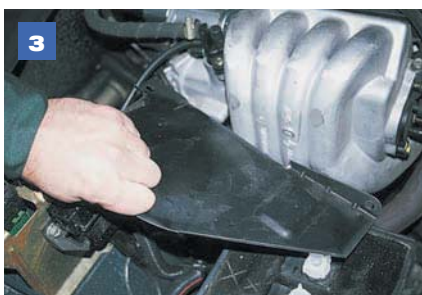
3 ...и снимаем теплоотражательный щиток.
