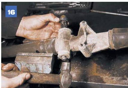
16 Постукивая молотком по торцу шлицевой части шестерни, вынимаем ее из картера вместе с подшипником.
