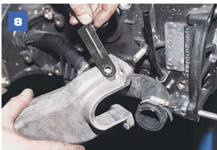
...снимаем опорный кронштейн и кронштейн крепления жгута проводов.
