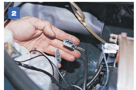
2 Отсоединяем разъем датчика скорости (расположенный возле блока управления системой впрыска).
