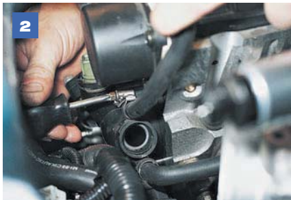
шланг расширительного бачка (датчик температуры для наглядности снят);
