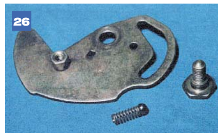
...и снимаем рычаг, придерживая фиксатор, состоящий из пружины и шарика.
