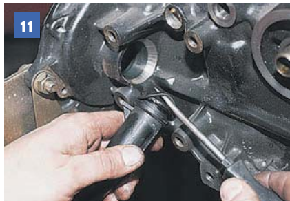
На патрубке установлено резиновое уплотнительное кольцо.
