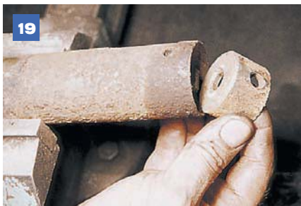
19 С противоположного конца корпуса рейки вынимаем выбитую заглушку...
