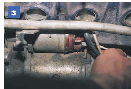
3 Отсоединяем провод питания тягового реле стартера.
