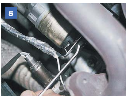
5 Ключом «на 13» отворачиваем гайку крепления плюсового провода.
