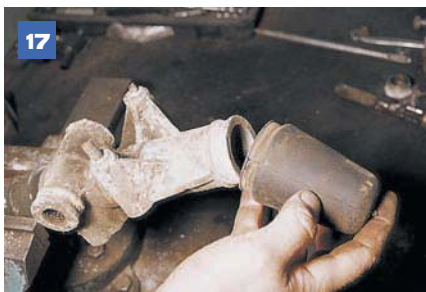
17 Снимаем хомут и торцевой грязезащитный чехол с корпуса рейки.
