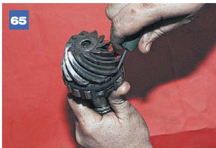
65 Отверткой выталкиваем ролики из сепаратора...
