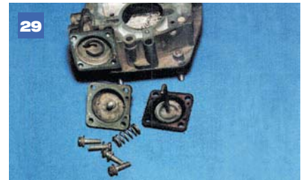
Повернув шток, выводим его из зацепления и вынимаем диафрагму из корпуса.
