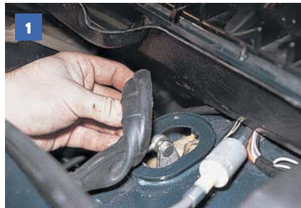
1 Снимаем резиновый чехол с люка щита передка.
