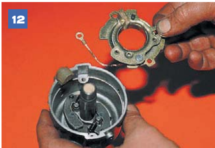
...и снимаем неподвижную пластину с подшипником и подвижной пластиной.
