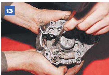
13 Выколоткой из мягкого металла выбиваем ротор из задней крышки через окно регулятора напряжения.
