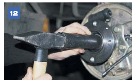
12 Смазываем посадочную поверхность цапфы и легкими ударами молотка через подходящий отрезок трубы напрессовываем подшипник вместе со ступицей до глубины, позволяющей наживить гайку без шайбы на две-три нитки резьбы.
