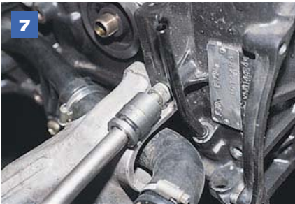
Головкой «на 17» отворачиваем три гайки крепления левого опорного кронштейна к блоку цилиндров,...
