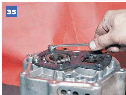
35 ...и ключом «на 12» два болта крепления пластины подшипников к картеру.
