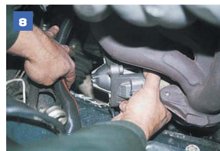
8 ...и вынимаем стартер вверх. Установку стартера проводим в обратной последовательности.
