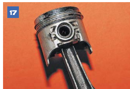
17 При установке поршней в цилиндры метка «П» должна быть обращена вперед по ходу автомобиля.
