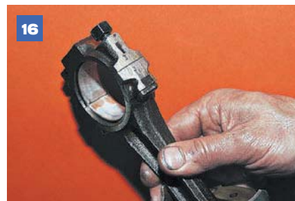
16 На боковых поверхностях нижних головок шатунов и крышках выбиты порядковые номера цилиндров. При сборке шатунов номера должны располагаться на одной стороне.
