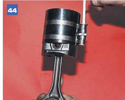
Для установки шатунно-поршневой группы в цилиндр используем оправку для обжима поршневых колец.
