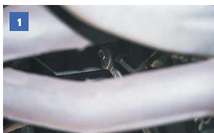
1 С правой стороны двигателя под выпускным коллектором ключом «на 12» отворачиваем болт крепления теплоотражательного щитка стартера к блоку цилиндров.
