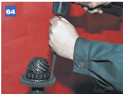
64 Выколоткой из мягкого металла сбиваем шестерню заднего хода.
