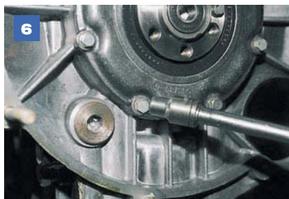
6 Головкой «на 10» отворачиваем шесть болтов крепления крышки задней манжеты коленчатого вала.
