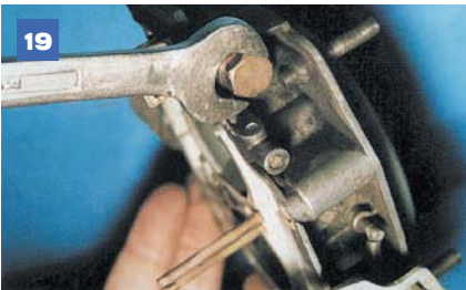
Ключом «на 13» отворачиваем пробку-держатель топливного фильтра...
