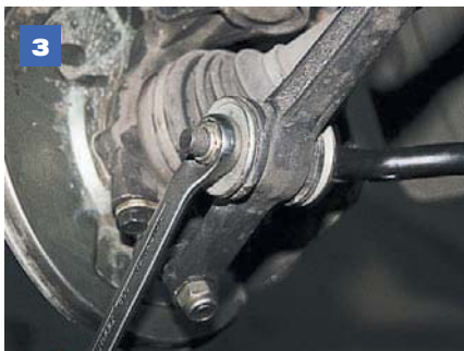
Ключом «на 24» отворачиваем две гайки чашек шарниров...
