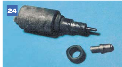
Снимаем топливный жиклер холостого хода и уплотнительное кольцо.
