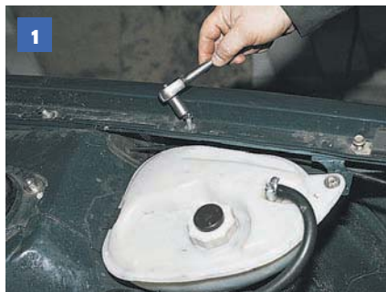
1 Головкой «на 10» отворачиваем шесть саморезов крепления крыла сверху.
