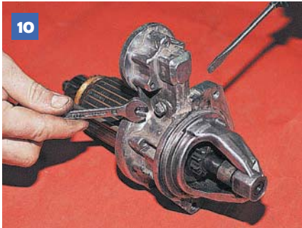
10 Ключом «на 10» и отверткой отворачиваем ось рычага и снимаем ее.
