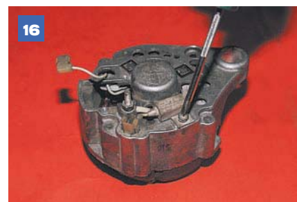
16 Крестообразной отверткой отворачиваем винт крепления конденсатора.
