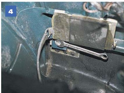
4 Ключом «на 12» отворачиваем два болта боковых креплений бампера...
