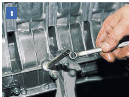
1 Ключом «на 10» отворачиваем трубку указателя уровня масла.
