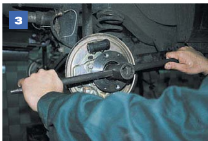
3 Торцевым ключом «на 32» отворачиваем гайку ступицы...
