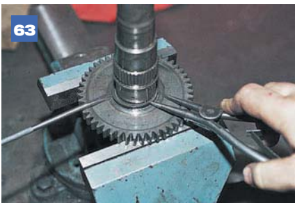
63 Щипцами снимаем стопорное кольцо.
