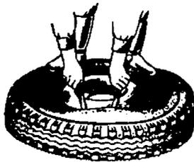
Рис 85 Демонтаж наружного борта шины
