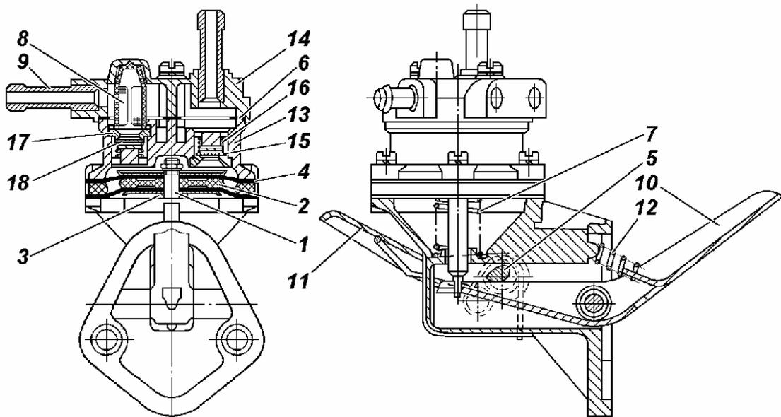
Рис.2.40 Топливный насос «Универсал» 2105-1106010-50:
