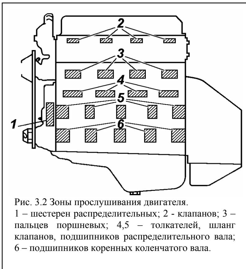
Рис. 3.2 Зоны прослушивания двигателя.
