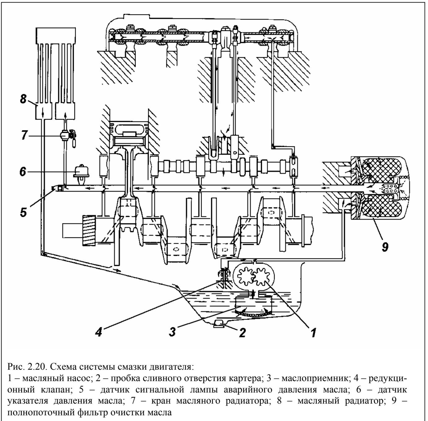
цилиндров, откуда по сверленому каналу в масляную магистраль - продольный масляный канал. Из продольного канала масло по каналам в перегородках блока подается на коренные подшипники коленчатого вала и в опоры распределительного вала. Масло, вытекающее из пятой опоры распределительного вала в полость блока между валом и заглушкой, отводится в картер через поперечное отверстие в шейке вала.
