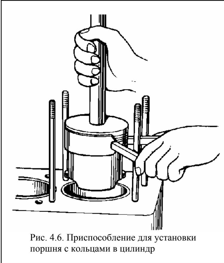
Рис. 4.6. Приспособление для установки поршня с кольцами в цилиндр
