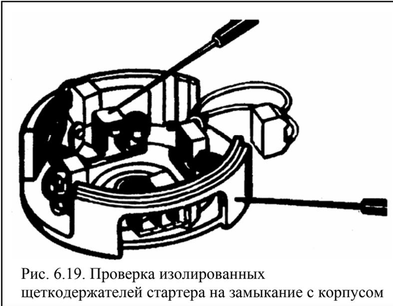
Рис. 6.19. Проверка изолированных щеткодержателей стартера на замыкание с корпусом
