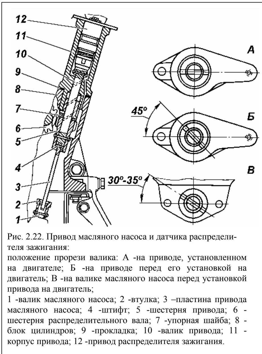
Рис. 2.22. Привод масляного насоса и датчика распределителя зажигания:
