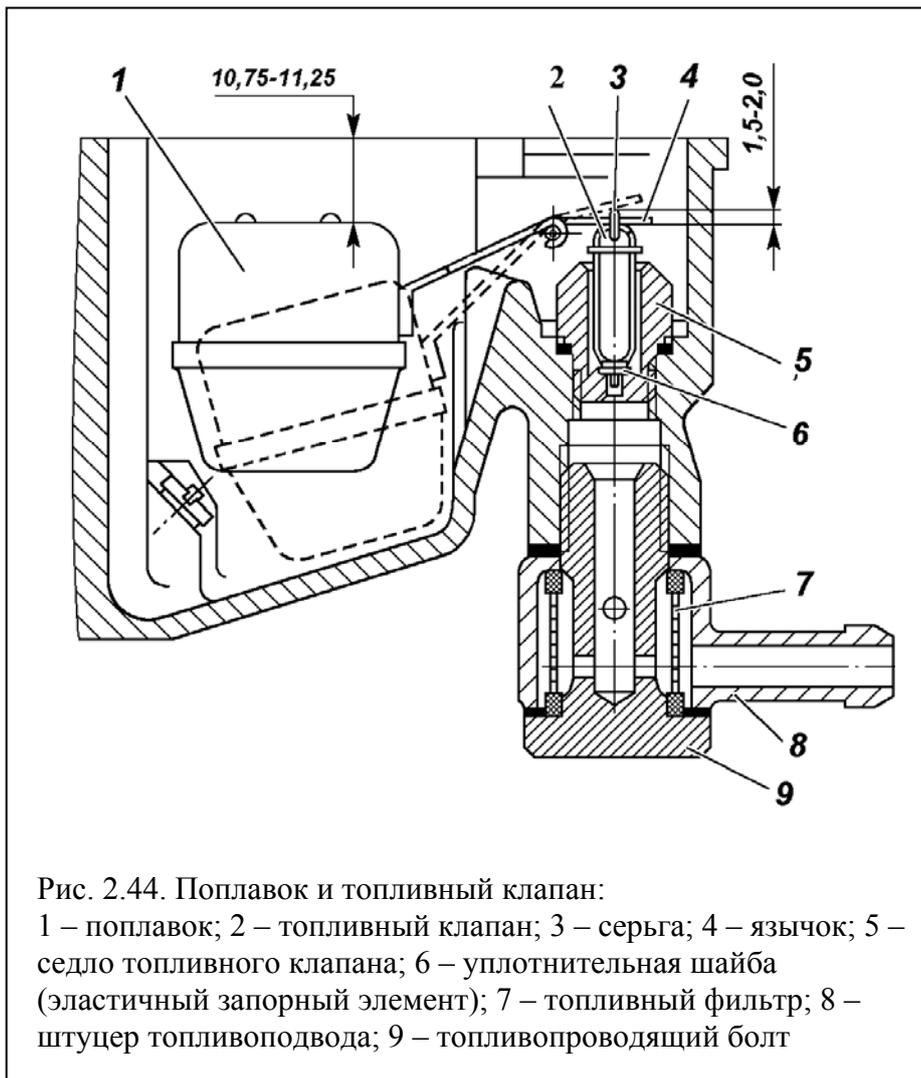
Рис. 2.44. Поплавок и топливный клапан:
