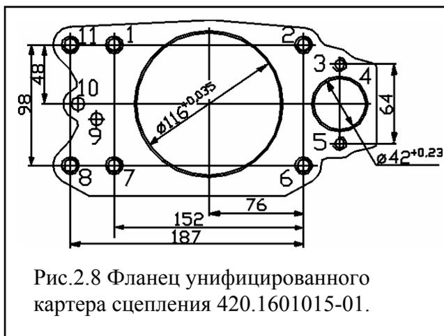
Рис.2.8 Фланец унифицированного картера сцепления 420.1601015-01.
