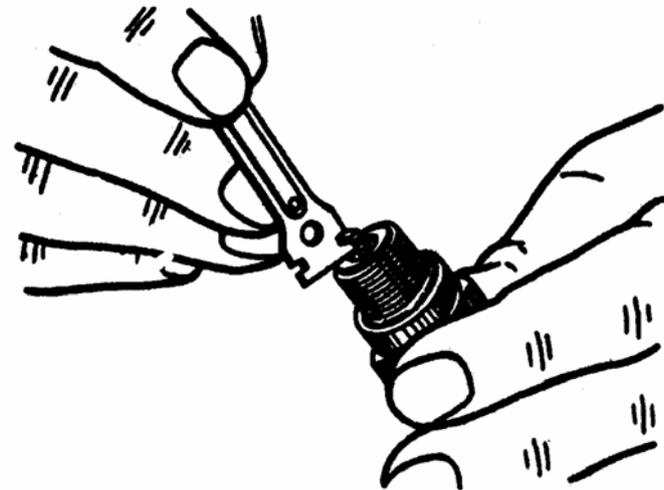
Рис. 6.29. Регулировка искрового зазора в свече
