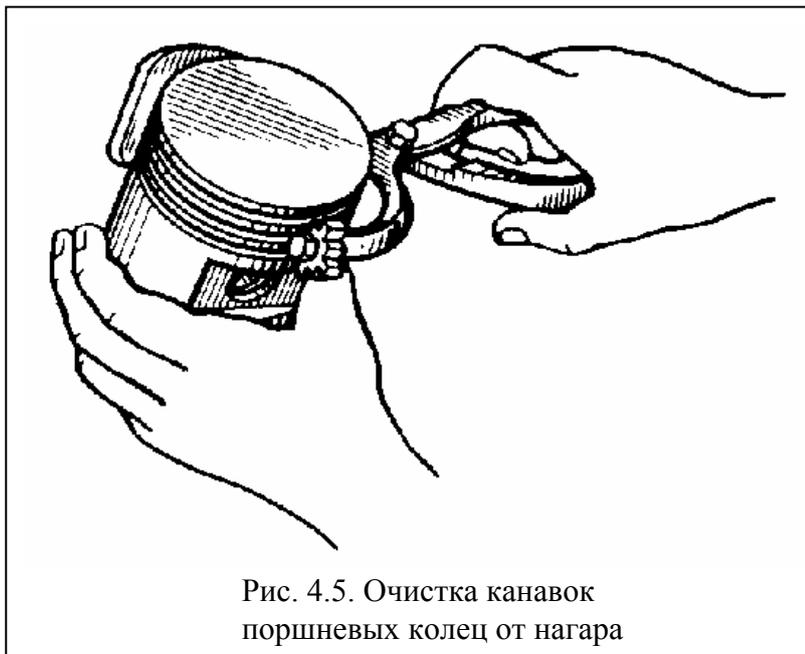
Рис. 4.5. Очистка канавок поршневых колец от нагара
