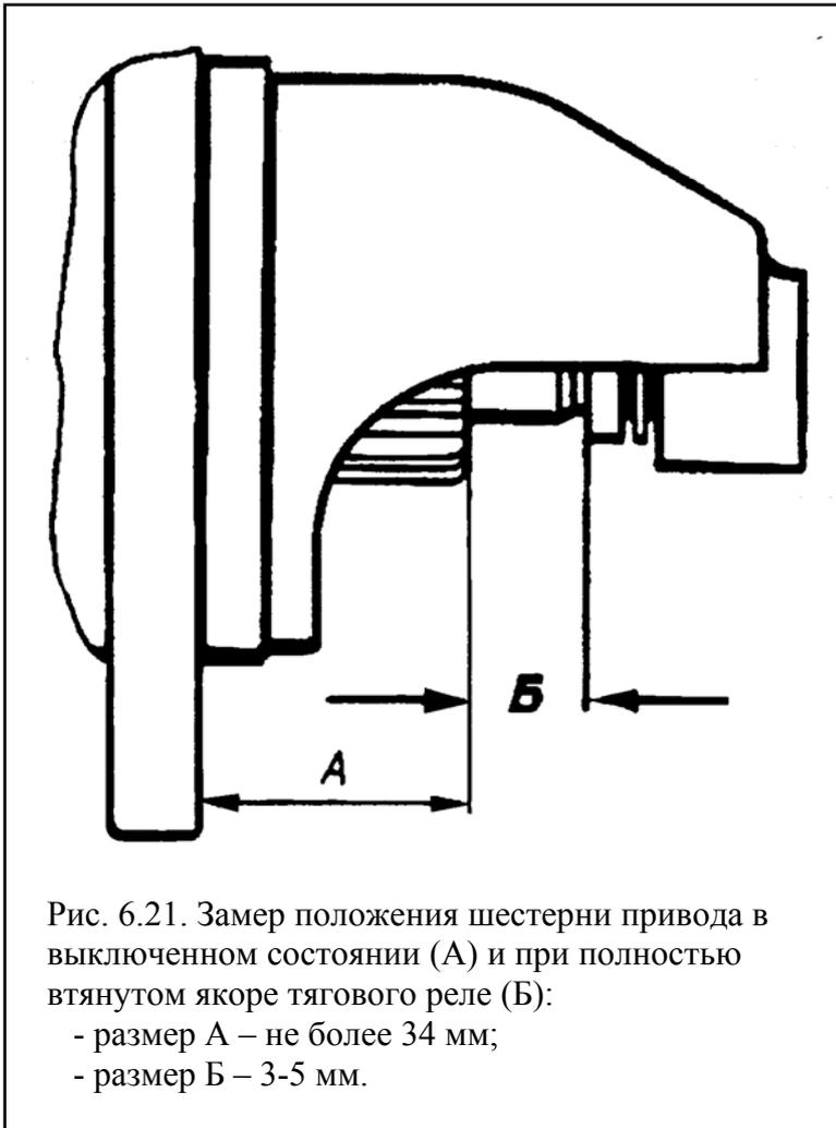
Рис. 6.21. Замер положения шестерни привода в выключенном состоянии (А) и при полностью втянутом якоре тягового реле (Б):
