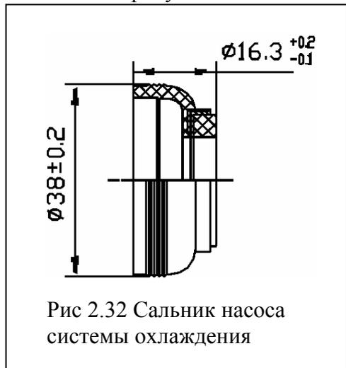
из посадочного гнезда. Перед установкой наружная поверхность сальника смазывается герметиком, изготовленным на основе «Гермесила» (2 части «Гермесила» и 1 часть неэтилированного бензина). Натяг сальника в месте контакта кольца скольжения с торцом крыльчатки составляет около 0,8 мм.
