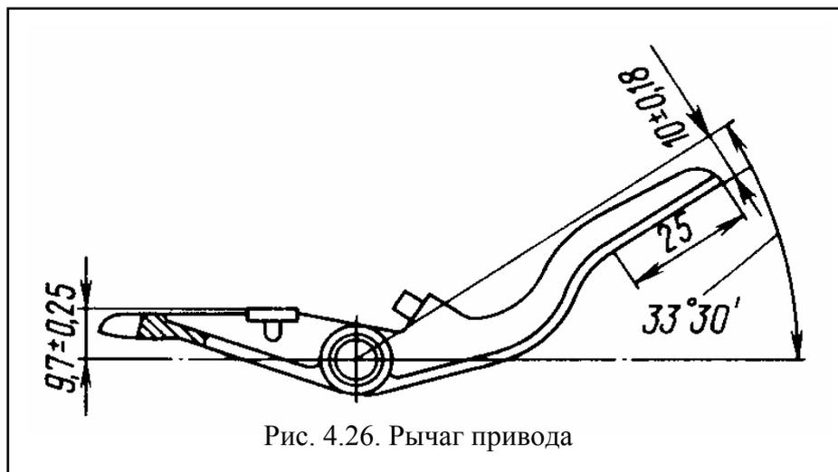
Рис. 4.26. Рычаг привода
