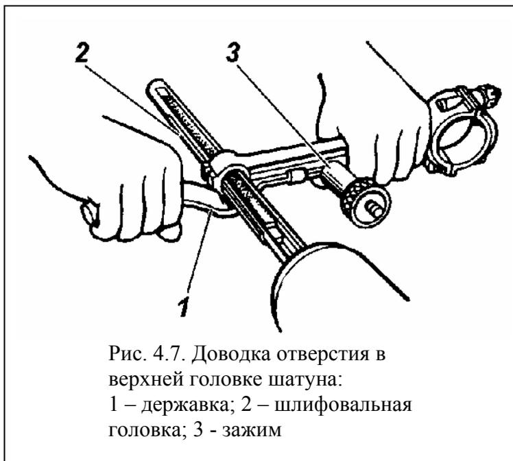
Рис. 4.7. Доводка отверстия в верхней головке шатуна:
