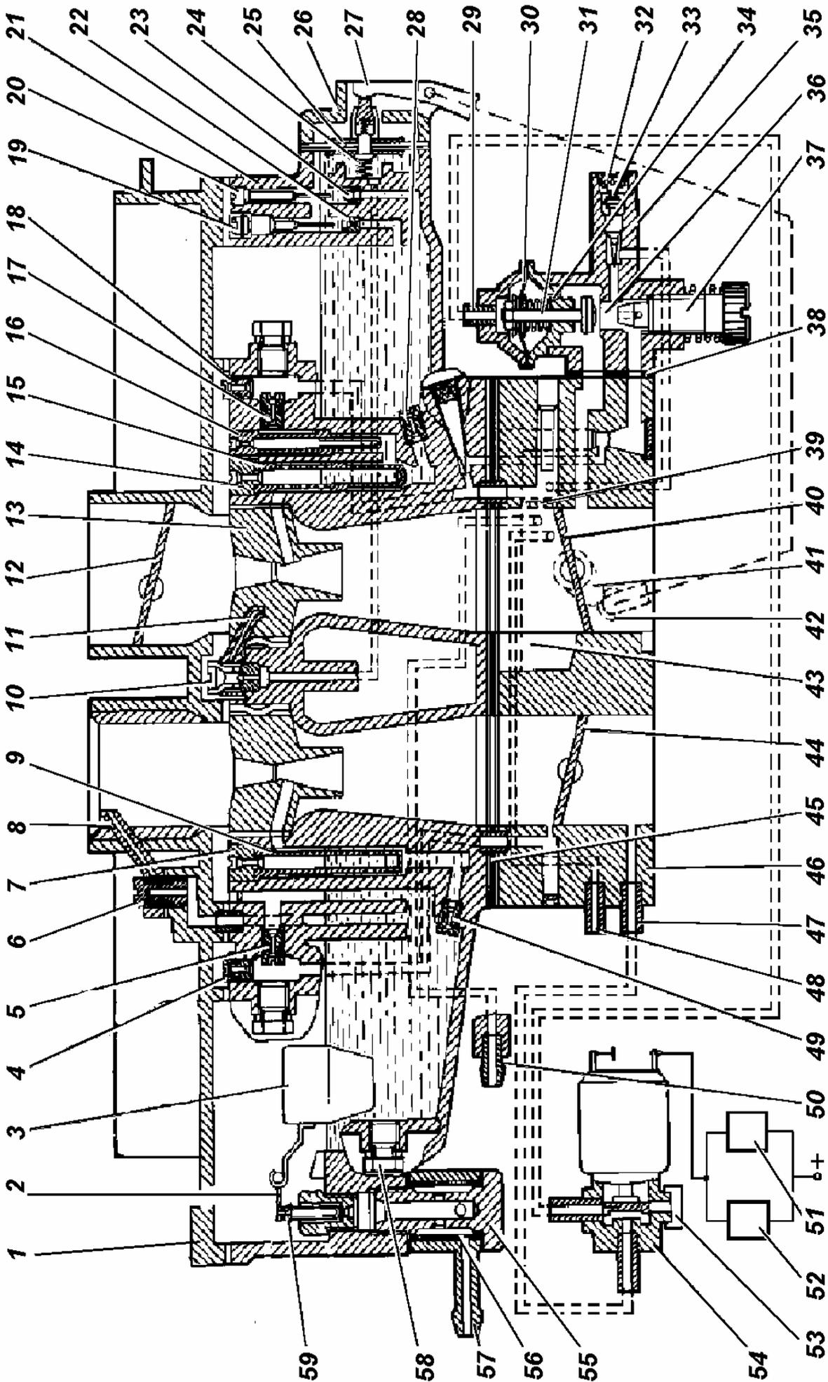
Рис. 2.42. Схема карбюраторов К-151:
