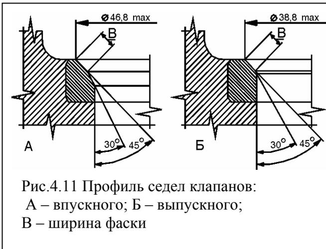
Рис.4.11 Профиль седел клапанов:
