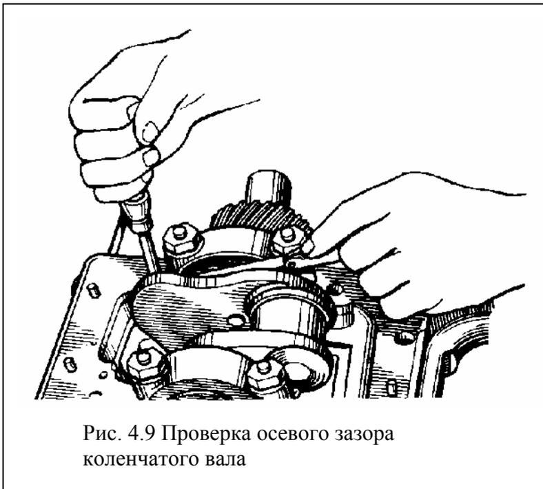
Рис. 4.9 Проверка осевого зазора коленчатого вала
