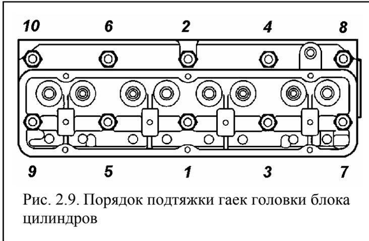
Рис. 2.9. Порядок подтяжки гаек головки блока цилиндров
