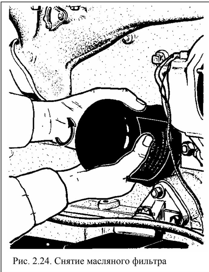
Рис. 2.24. Снятие масляного фильтра
