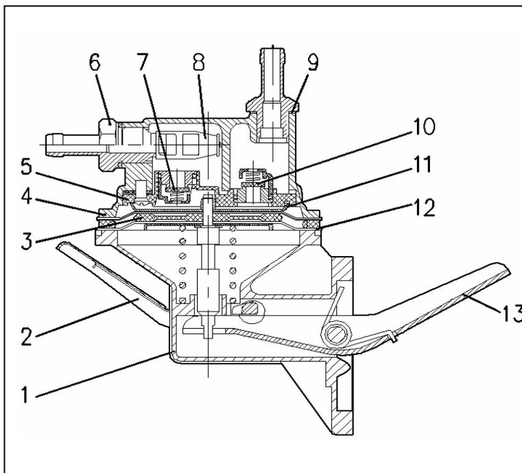
Рис.2.38 Топливный насос 900-1106010:
