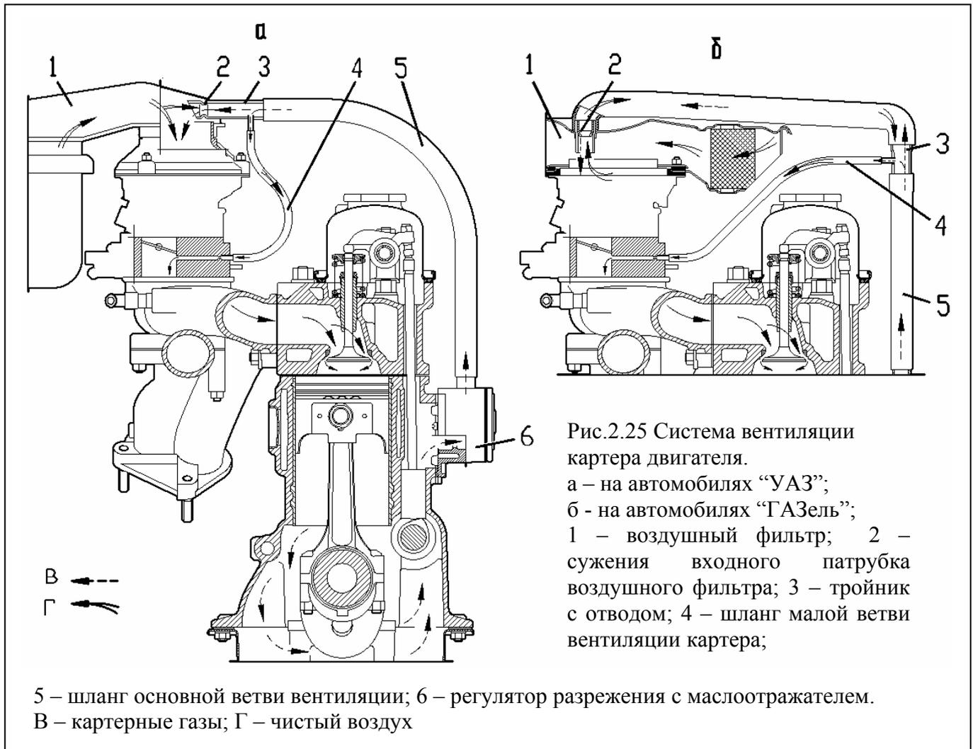
На остальных режимах работы двигателя большая часть газов отводится по трубопроводу 5 и далее по тройнику 3 в воздушный фильтр 1.
