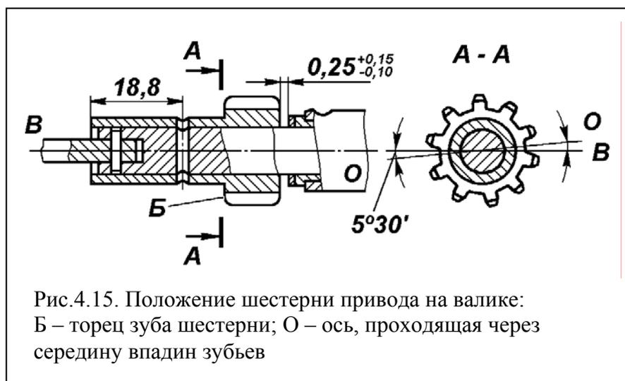
вынув предварительно штифт шестерни с помощью борodka диаметром 3 мм. При снятии шестерни с валика корпус 11 привода установите верхним торцом на подставку с отверстием в ней для прохода валика привода в сборе с упорной втулкой.
