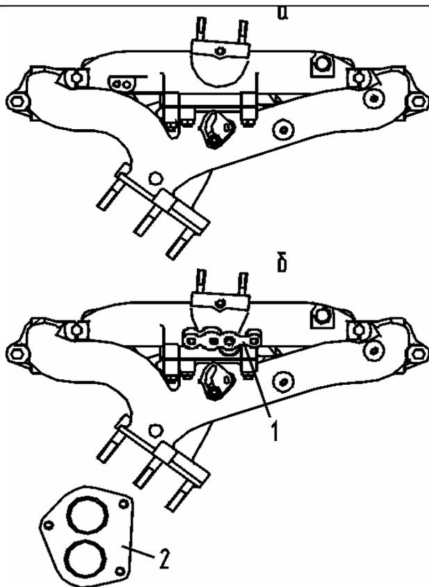
Рис.2.15 Газопровод под настроенную систему выпуска отработавших газов.
