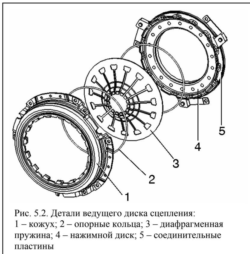
Рис. 5.2. Детали ведущего диска сцепления:
