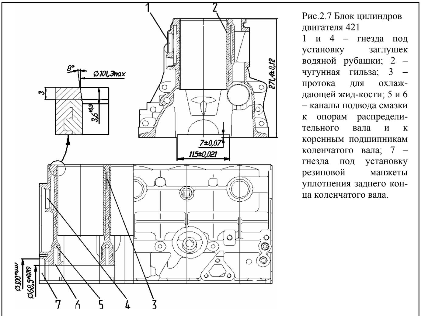
Рис.2.7 Блок цилиндров двигателя 421
