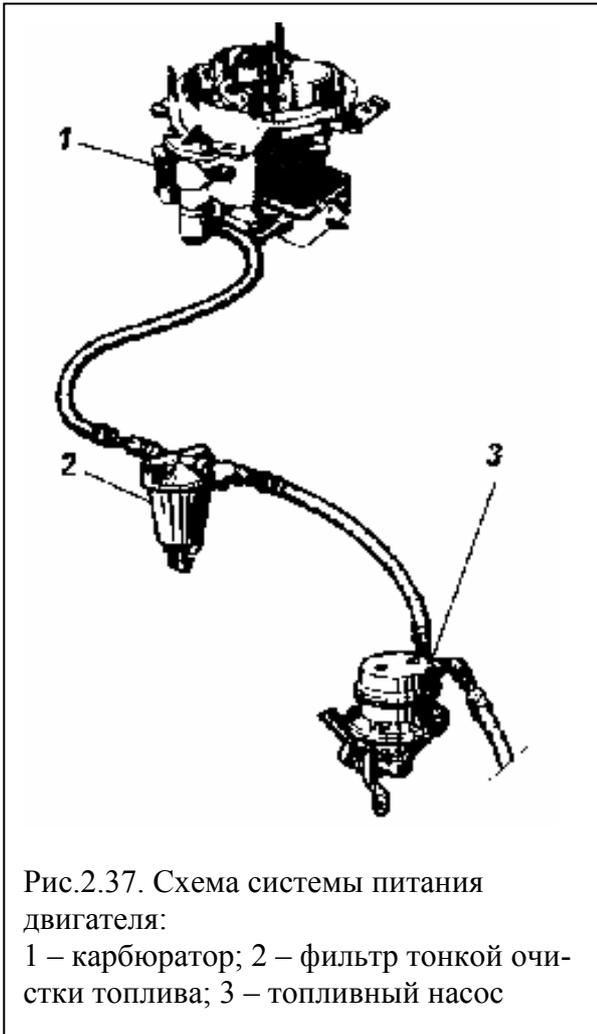
Рис.2.37. Схема системы питания двигателя:
