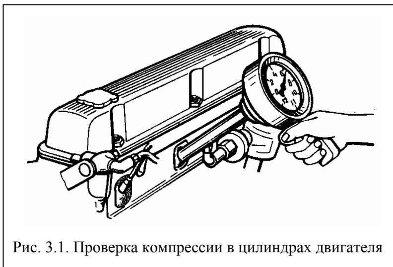
Рис. 3.1. Проверка компрессии в цилиндрах двигателя
