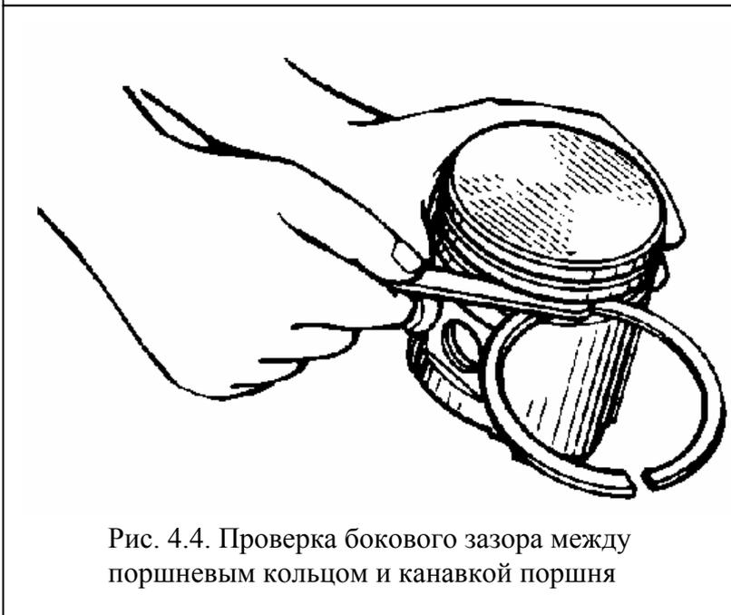
Рис. 4.4. Проверка бокового зазора между поршневым кольцом и канавкой поршня
