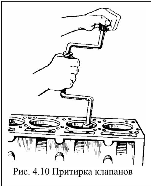
Рис. 4.10 Притирка клапанов
