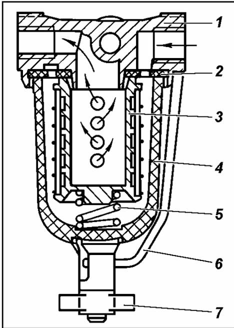
Рис. 2.41. Фильтр тонкой очистки топлива:
