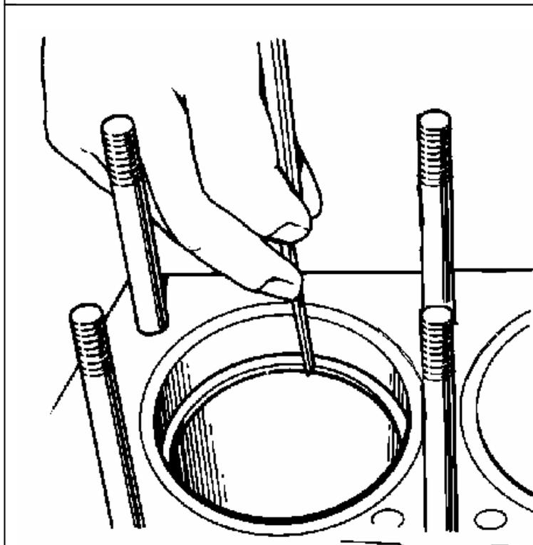
Рис. 4.2. Подбор поршневых колец по цилиндру (проверка бокового зазора в стыке кольца)
