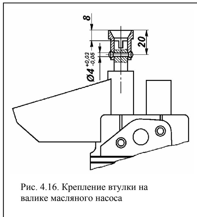
При этом необходимо, чтобы ось О-О, проходящая через середину впадин между двумя зубьями на торце Б была смещена относительно оси В-В шлица валика на  $5^{\circ}30' \pm 1^{\circ}$ .
