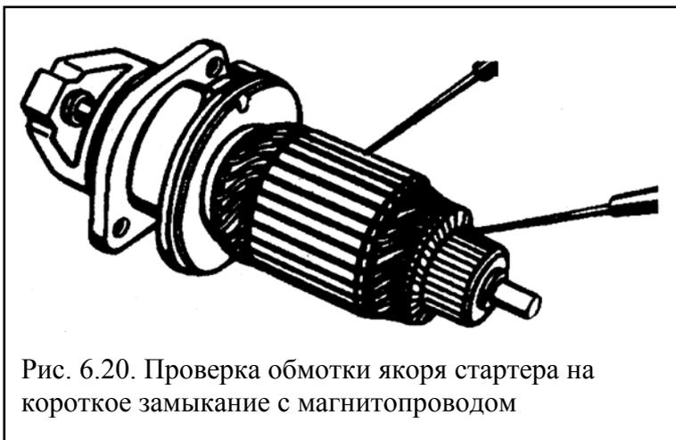
Рис. 6.20. Проверка обмотки якоря стартера на короткое замыкание с магнитопроводом
