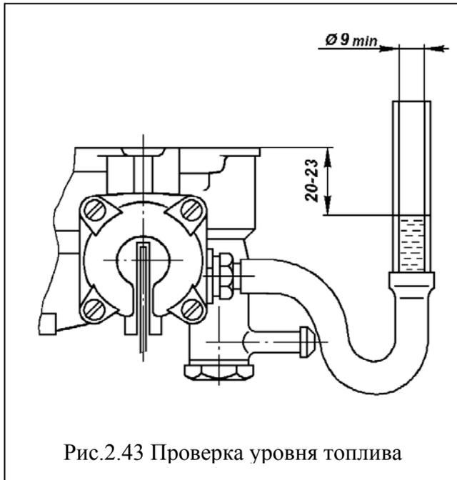
Рис.2.43 Проверка уровня топлива
