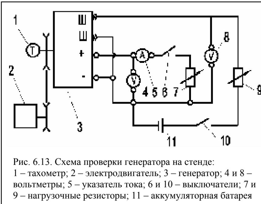
необходимо включить выключатель 6 и, увеличивая частоту вращения генератора, увеличить нагрузку. Во время этих испытаний контролировать напряжение на клеммах генератора. Напряжение на клеммах генератора должны быть в пределах указанным в таблице 6.1. Если напряжение генератора не соответствует указанным значениям, необходимо заменить регулятор напряжения.
