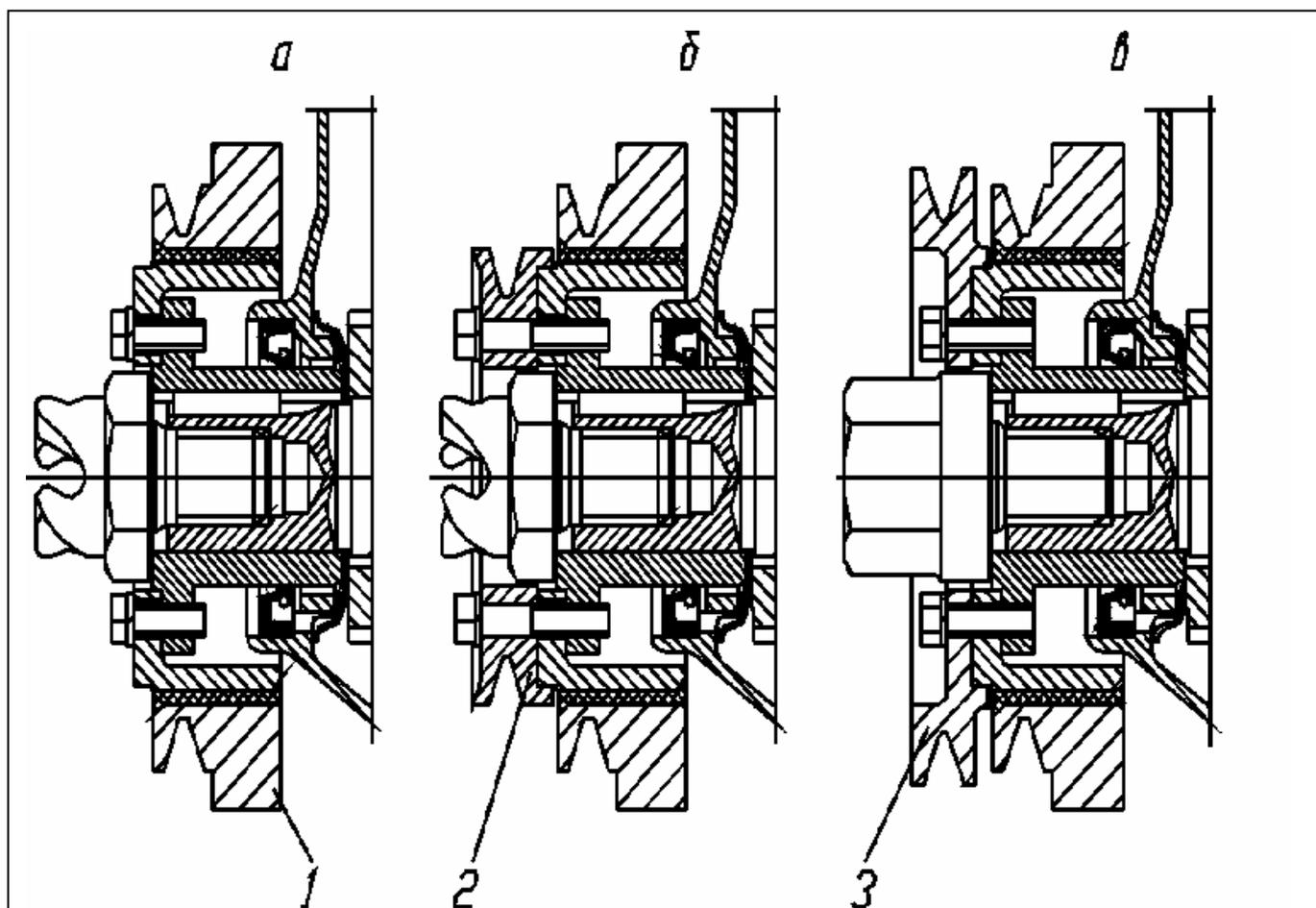
Рис.2.13 Варианты установки шкивов привода на переднем конце коленчатого вала.
