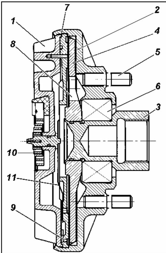
На двигателях 421 и 4218 (на автомобилях УАЗ) может устанавливаться вязкостная муфта привода вентилятора (рис. 2.37), позволяющая снизить расход топлива, уменьшить шум вентилятора, а также способствующая прогреву холодного двигателя и поддержанию теплового режима двигателя в оптимальных пределах.
