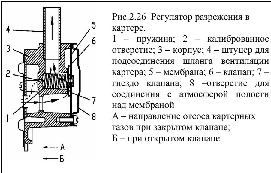
При исправной системе вентиляции на работающем двигателе в картере должно быть разрежение в пределах 10-40 мм водяного столба. Величину разрежения можно определить при помощи водяного пьезометра, присоединенного к гнезду указателя уровня масла на блоке цилиндров. Повышение разрежения в картере более 50 мм водяного столба свидетельствует о неисправности регулятора разрежения. В этом случае необходимо разобрать
