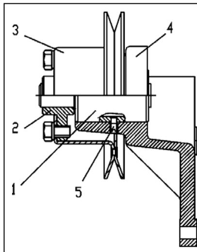
Рис 2.33 Корпус привода вентилятора в сборе для двигателя 4215.
