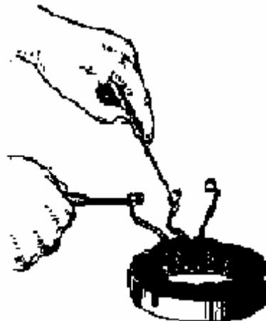
Рис. 6.9. Проверка обмоток статора на обрыв цепи
