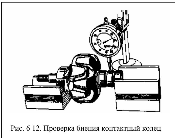
Рис. 6.12. Проверка биения контактных колец
