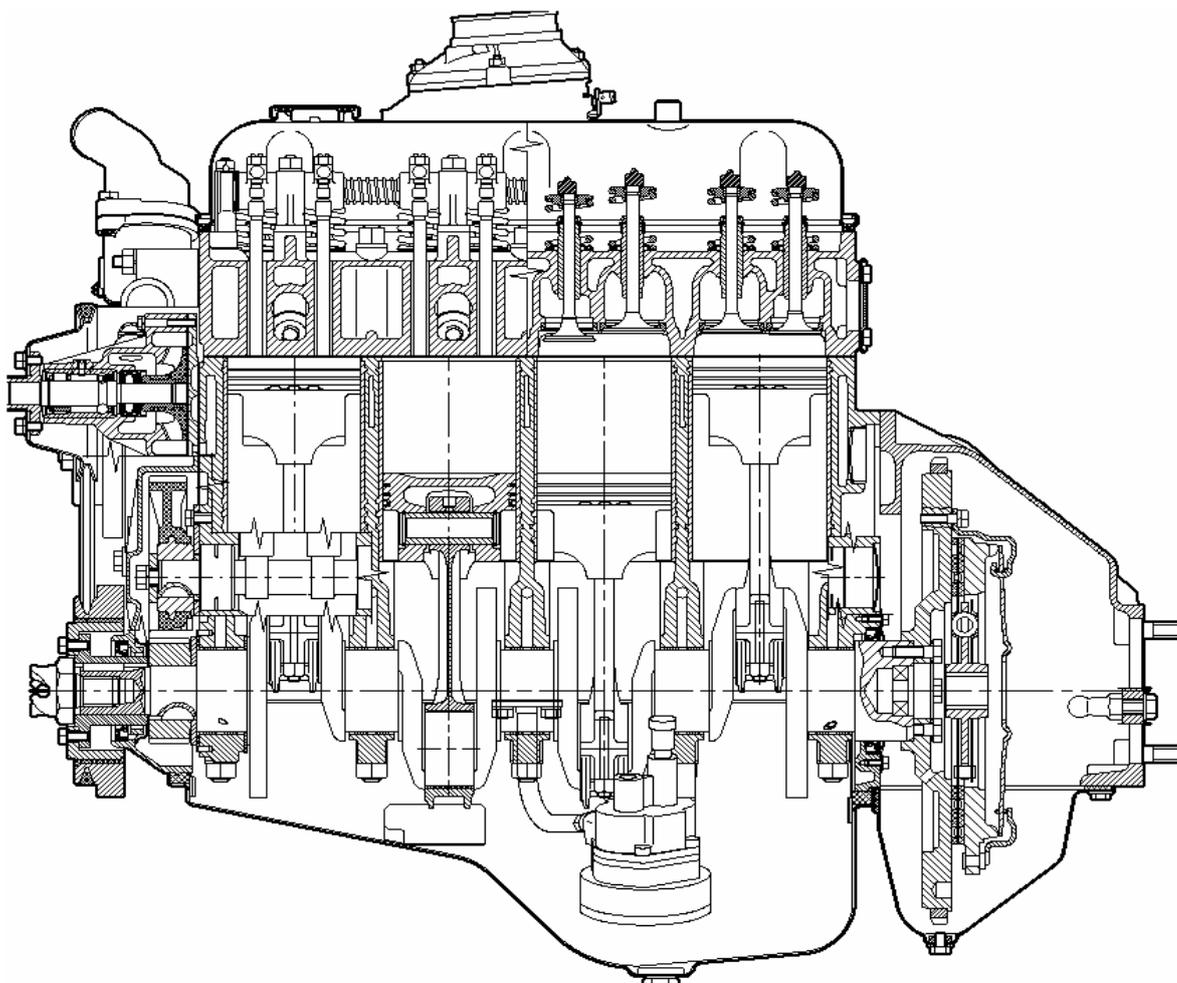
Рис 2.4 Двигатель 421 (продольный разрез)
