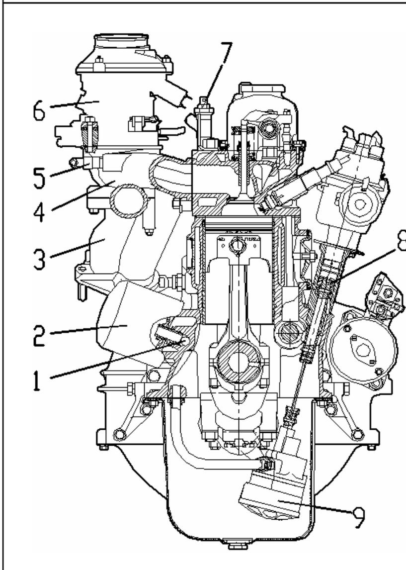
Рис. 2.6 Двигатель 421 (поперечный разрез):
