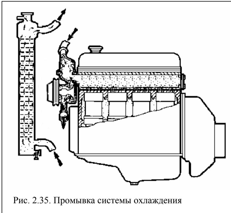
Рис. 2.35. Промывка системы охлаждения
