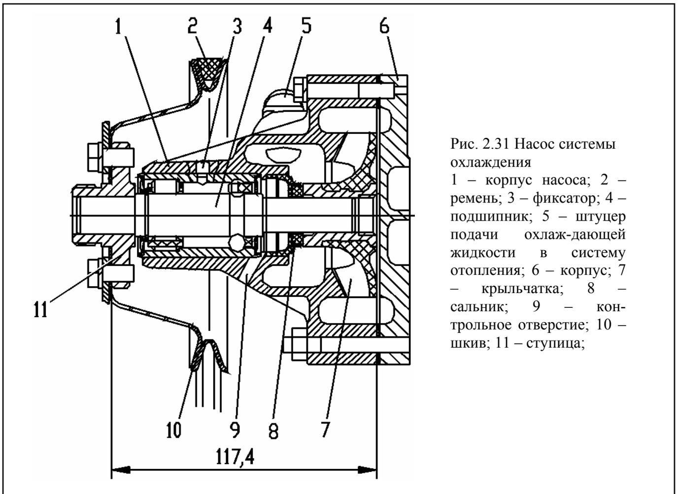
Рис. 2.31 Насос системы охлаждения
