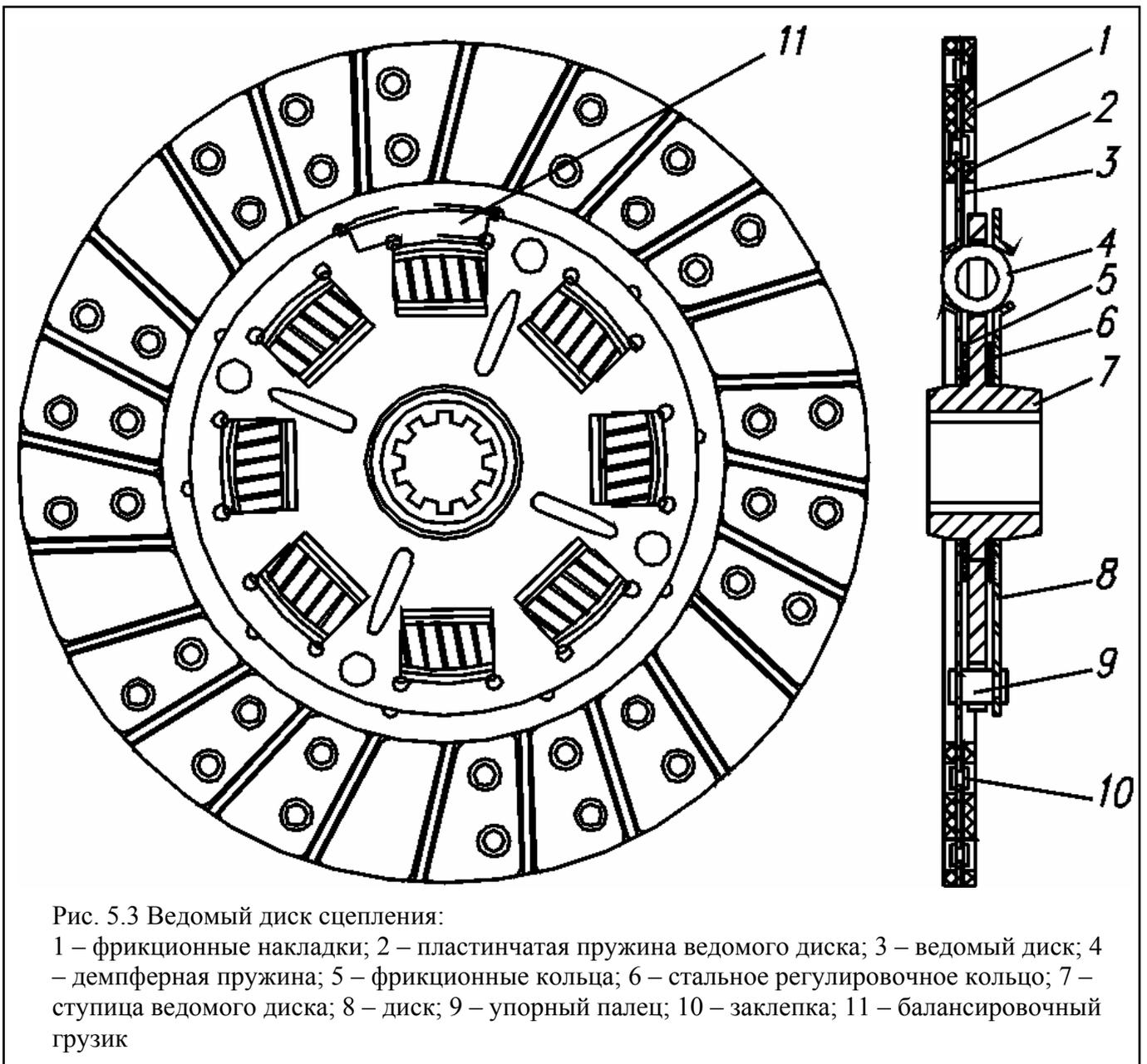
Ведомый диск состоит из ступицы 7, ведомого стального диска 3, пластинчатых пружин 2, фрикционных накладок 1, упорных пальцев 9 и узла демфера крутильных колебаний.
