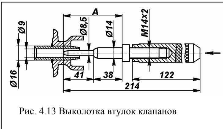
Рис. 4.13 Выколотка втулок клапанов
