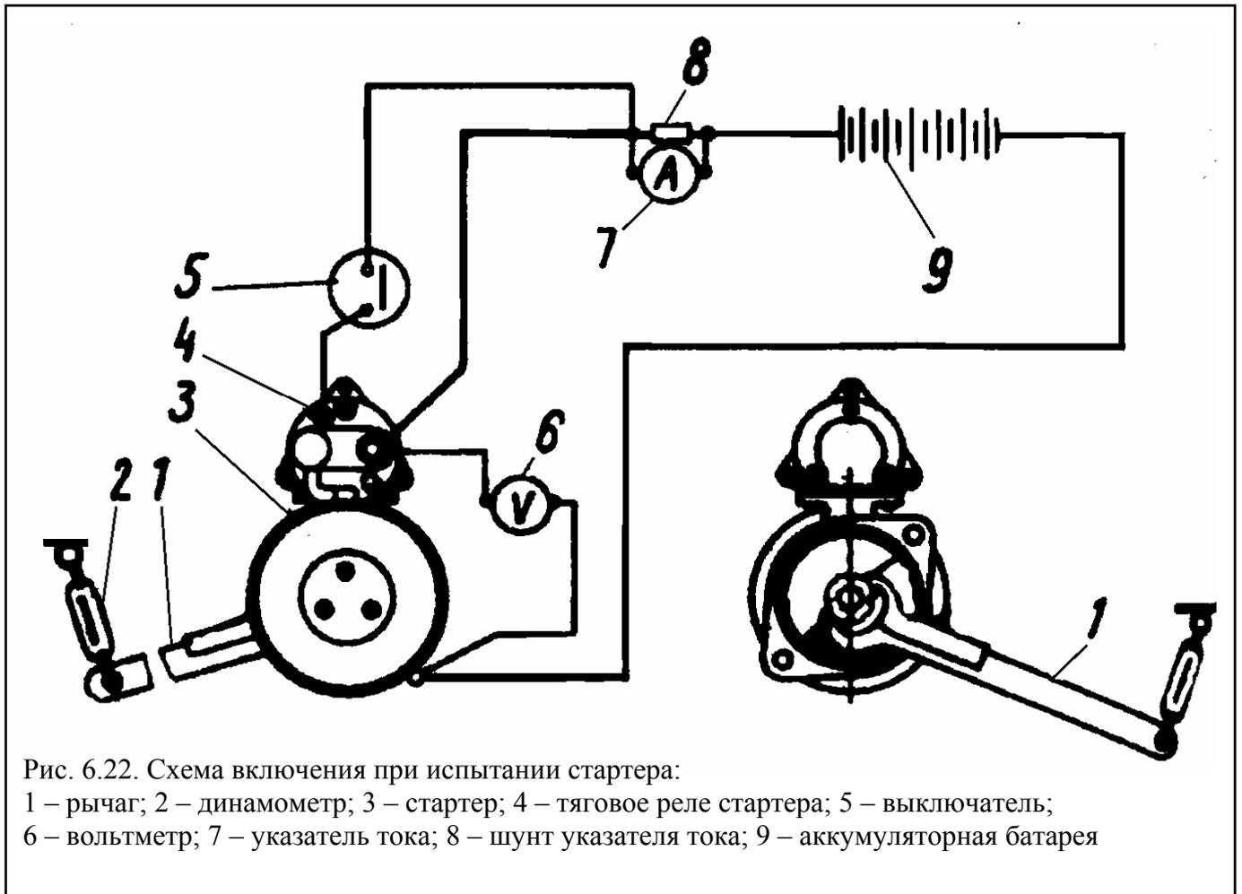
Если нет специального контрольно-испытательного стенда модели 532М, то зажимают стартер в тиски и соединяют с батареей (зажим стартера соединяют через указатель тока с плюсовым, а корпус стартера с минусовым выводом батареи). Для соединения стартера с батареей применяются провода сечением не менее 25-35 мм<sup>2</sup>. Силу тока и число оборотов якоря при испытании на холостом ходу измеряют не более чем через 30 с после включения стартера.
