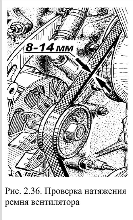
Рис. 2.36. Проверка натяжения ремня вентилятора
