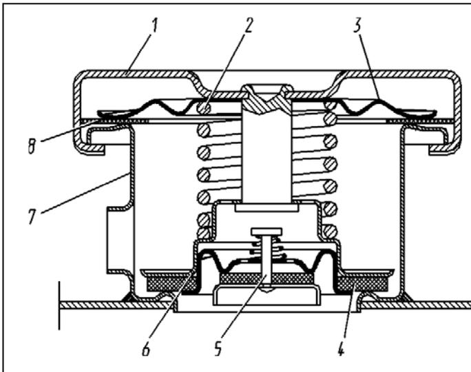
Рис. 2.30 Пробка радиатора автомобилей УАЗ
