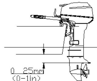
**ЗАМЕЧАНИЕ:** оптимальная высота крепления мотора зависит от комбинации лодки и мотора и предпочтений в эксплуатации. Испытания на различной высоте помогут определить оптимальную высоту установки. Для дальнейшей информации, консультируйтесь со своим дилером "NEXUS-OUTBOARDS" или производителем лодки.
