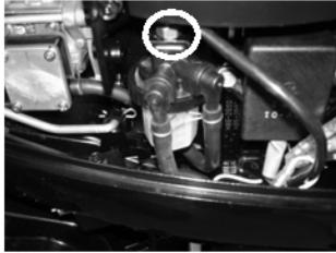
2. Отвинтите крышку фильтра, вытирая проливающееся топливо тряпкой.
