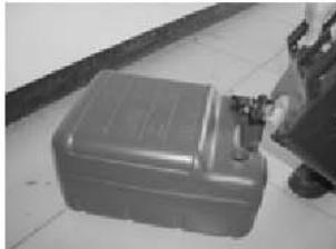
3. Надежно закрутите крышку топливного бака. Вытрите любое протекания.
