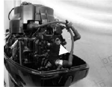
4. Налейте консерванта или машинного масла через карбюратор (ы) и отверстия свечи (ей).
