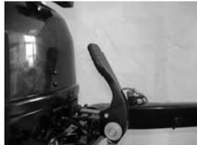
**ЗАМЕЧАНИЕ:** Удостоверьтесь, что кронштейн замка наклона двигателя находится в замкнутом положении.
