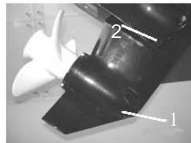
2. Поместите емкость под сливное отверстие. 1. Винт сливного отверстия.
