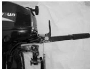
2. Максимально закрутите регулятор сопротивления повороту двигателя, чтобы избежать свободного вращения двигателя в поднятом положении
