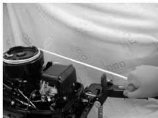
7. Резко дернете за ручку, чтобы провернуть коленчатый вал и запустить двигатель.
