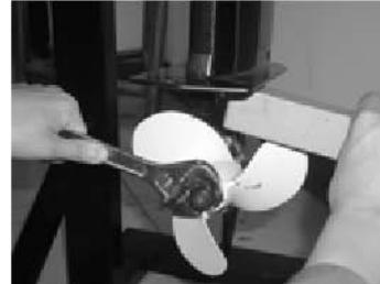
1. Проверьте каждое из лезвий винта на предмет износа, коррозии от кавитации или вращения, и наличие других повреждений.
