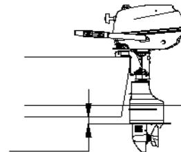
**ЗАМЕЧАНИЕ:** оптимальная высота крепления мотора зависит от комбинации лодки и мотора и предпочтений в эксплуатации. Испытания на различной высоте помогут определить оптимальную высоту установки. Для дальнейшей информации, консультируйтесь со своим дилером "NEXUS-OUTBOARDS" или производителем лодки.
