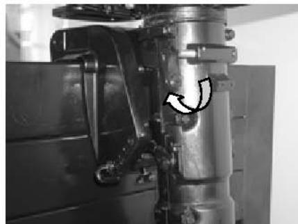
3. Закрутите воздушный винт на баке.
