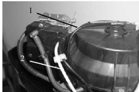
3. Снимите стартер после удаления трех болтов.
