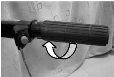
2. Быстро сдвиньте рычаг переключения передач и переведите его из нейтрального положения в положение хода вперед.
