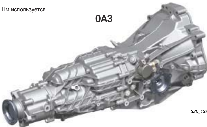
Коробка передач 0A3 предназначена для двигателей 3,0 I-V6-TDI-CR.
