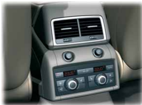
Задняя панель управления климатической установкой
