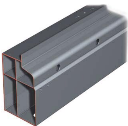
профиль порога Audi TT четырёхкамерный пресованный профиль
