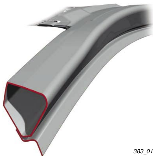
стойка A Audi A8 однокамерный пресованный профиль
