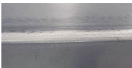
Лазерный шов до (вверху) и после карцевания (внизу)
