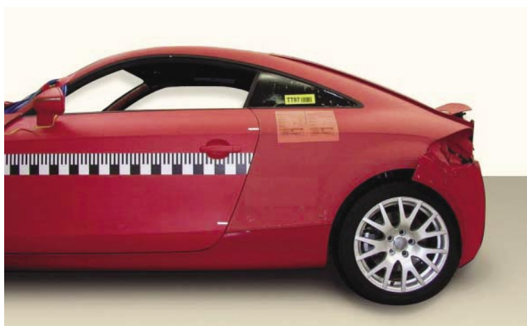
ЕСЕ и Япония, столкновение сзади (50 км/ч)
