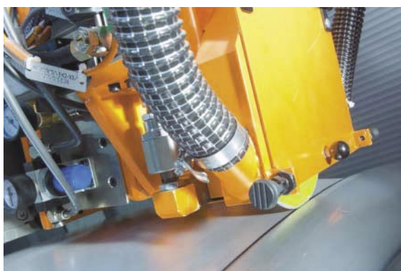
Процесс карцевания на производстве
