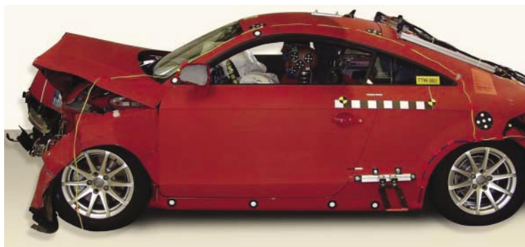
Euro NCAP, лобовое столкновение (64 км/ч с частичным перекрытием)
