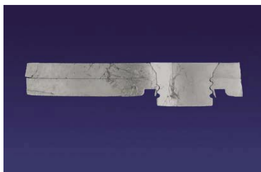
Вид соединения заклепкой с конической головкой в разрезе
