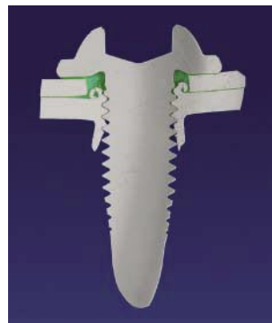
Изображение соединения при помощи болта Flow Drill в разрезе
