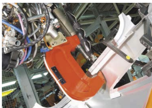
Процесс соединения заклепками с конической головкой на производстве
