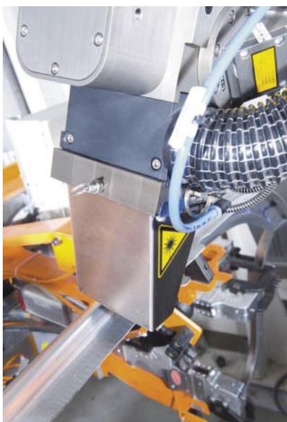
Процесс очистки лазером на производстве
