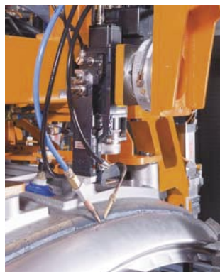
Лазерная сварка на производстве
