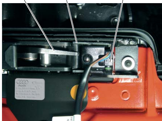
Коромысло Крюк Передний датчик блокировки крыши F172
