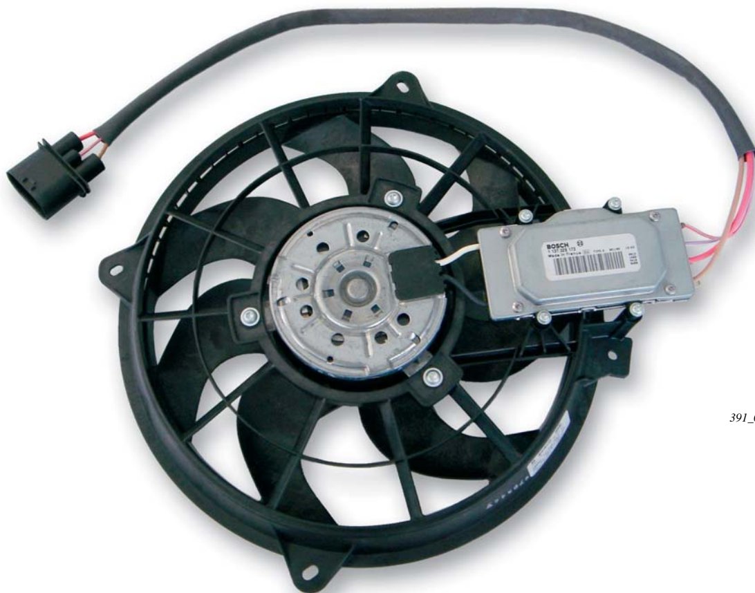
Вентилятор радиатора V7 с блоком управления вентилятора радиатора J293
