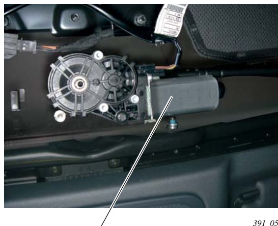
Электродвигатель устройства блокировки крыши V223
