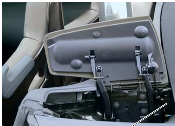
Электродвигатель заслонки крыши V383 с датчиком заслонки крыши G596
