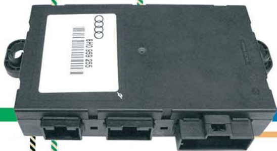
Блок управления подъёма/опускания крыши J256
