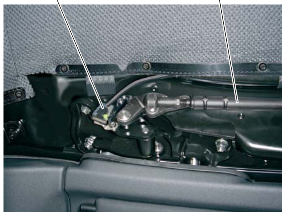
Датчик „Блокировка крыши закрыта“ F295 в верхней части левого замка
