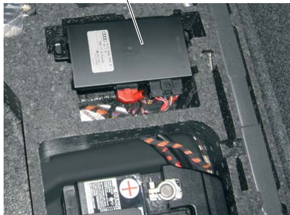
Блок управления системы складывания крыши J256
