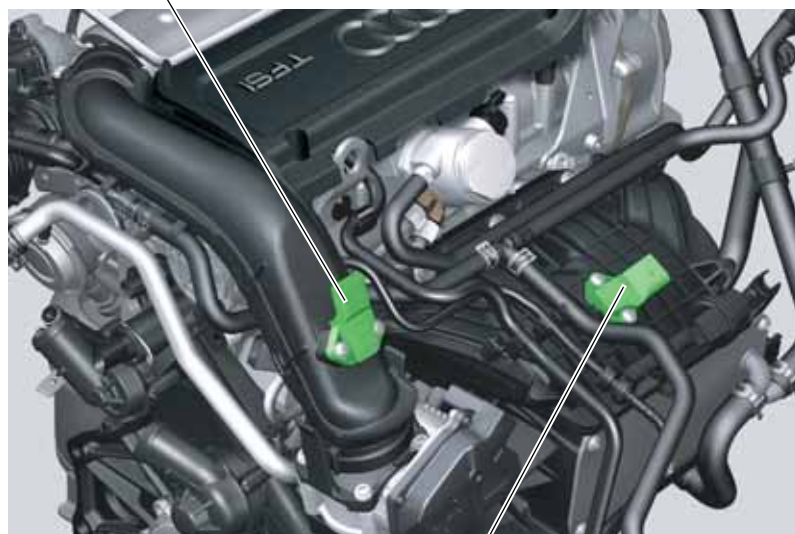
Датчик давления во впускном коллекторе G71 с датчиком температуры воздуха на впуске G42
