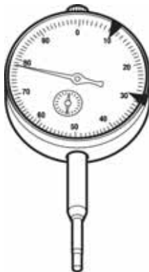
VAS 6079 Индикатор часового типа Установка первого цилиндра в BMT
