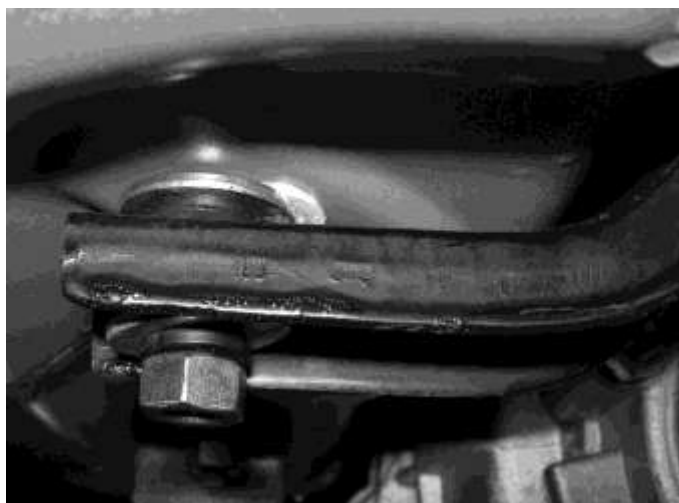
Рис. 3-31. Установка шайб под поперечину задней опоры раздаточной коробки.
