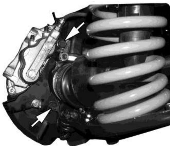
Рис. 6-12. Снятие переднего тормоза.
