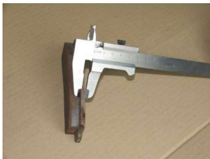
Рис. 6-17. Замер толщины тормозных колодок
