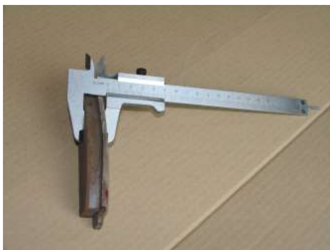
Рис. 6-17. Замер толщины тормозных колодок
