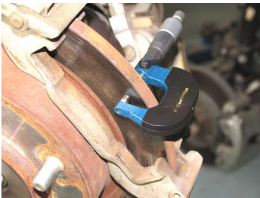
Рис. 6-14. Замер толщины диска микрометром
