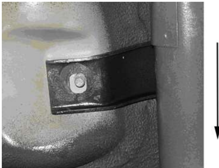
Рис. 3-30. Установка поперечины опоры коробки передач.
