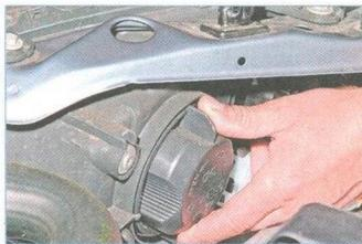
...поворачиваем крышку фары против часовой стрелки (на крышке имеется стрелка, указывающая направление поворота)...
