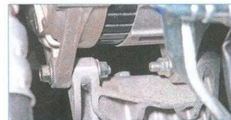
Ключом «на 12» отворачиваем гайки болтов нижнего крепления генератора, удерживая болты от проворачивания вторым ключом «на 12».
