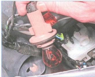
...и вынимаем его из корпуса блок-фары.
