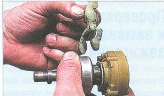
...и отсоединяем рычаг.
