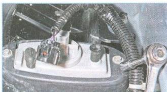
Головкой «на 8» отворачиваем два самореза крепления фары.
