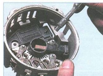
Головкой «Е6» с удлинителем отворачиваем четыре винта крепления выпрямительного блока и щеткодержателя с регулятором напряжения...
