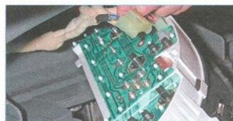
...и нажав на фиксатор колодки, отсоединяем от комбинации колодку
