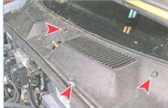
Крестообразной отверткой отворачиваем винты пистонов и вынимаем три пистона крепления левой облицовки ветрового окна.
