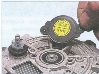
...и снимаем крышку.
