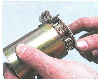
Извлекаем из корпуса стартера якорь с щеткодержателем.
