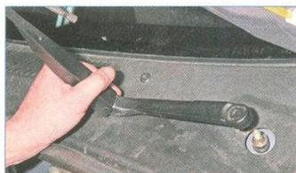
Снимаем с вала рычаг со щеткой очистителя. Правый рычаг снимаем аналогично.
