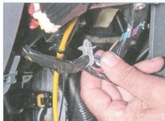
...снимаем держатель жгута проводов с кронштейна рулевой колонки.
