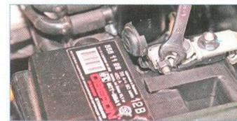
Ключом «на 10» ослабляем затяжку клеммы провода на «минусовом» выводе аккумуляторной батареи и снимаем клемму.
