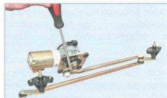
Отжав отверткой тягу, отсоединяем ее от кривошипа (для наглядности показано на снятом очистителе).
