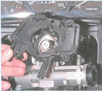
Снимаем соединитель переключателей с рулевой колонки.
