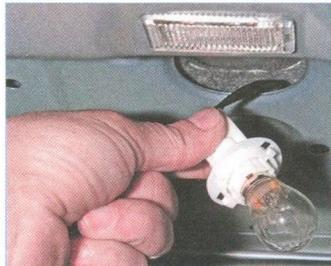
...поворачиваем патрон лампы против часовой стрелки и вынимаем патрон с лампой из корпуса сигнала. Нажав на лампу, поворачиваем ее до упора против часовой стрелки...
