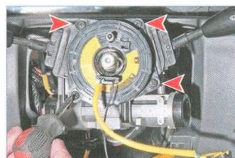
Крестообразной отверткой отворачиваем четыре самореза крепления барабанного устройства.
