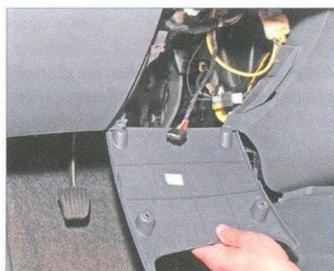
Снимаем нижнюю накладку панели приборов.
