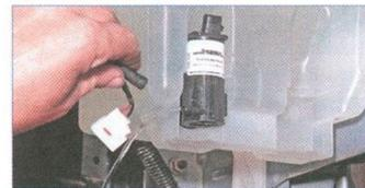
...и снимаем шланг подачи жидкости к форсункам с патрубком насоса. Сливаем жидкость из бачка омывателя.
