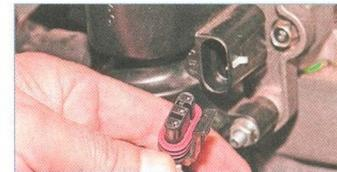
...отсоединяем колодку жгута проводов от катушки зажигания.
