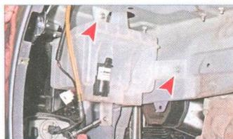
Головкой «на 10» отворачиваем три гайки крепления бачка.
