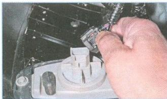
...нажав на фиксатор, отсоединяем колодку проводов от противотуманной фары.
