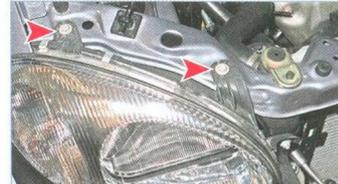
Головкой «на 10» отворачиваем гайку и два болта крепления блок-фары.
