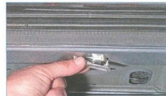
...и вынимаем плафон из отверстия в задней полке.
