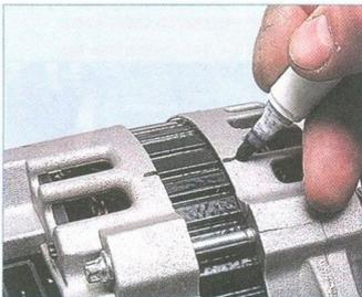
Помечаем взаимное положение крышек и статора генератора.
