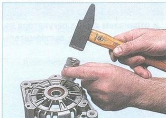
...выпрессовываем подшипник подходящим отрезком трубы или инструментальной головкой, передавая усилие только на наружное кольцо подшипника. Для проверки обмотки ротора на обрыв и короткое замыкание...
