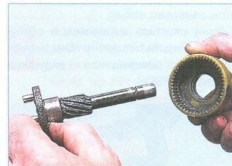
Снимаем с вала коронную шестерню планетарного редуктора.
