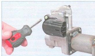
Крестообразной отверткой отворачиваем винт крепления контактной группы (для наглядности показано на снятой рулевой колонке).
