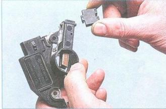
...снимаем крышку щеткодержателя.
