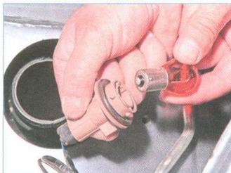
Нажав на лампу, поворачиваем ее до упора против часовой стрелки и вынимаем лампу из патрона. Новую лампу PY21W устанавливаем в обратной последовательности.
