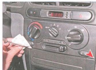
Шлицевой отверткой отжимаем оба конца облицовочной накладки консоли панели приборов сверху и снизу.
