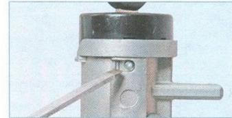
Отверткой нажимаем на фиксатор (для наглядности показано на снятой рулевой колонке)...
