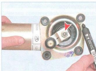
Маркером помечаем положение кривошипа относительно кронштейна мотор-редуктора...
