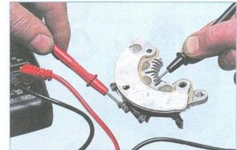
...подсоединяем щупы омметра к выводу выпрямительного блока, который соединяется с фазной обмоткой статора, и воздушному радиатору диодов...
