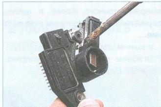
Чтобы вынуть вторую щетку, отпаиваем ее вывод от вывода регулятора напряжения. Для замены подшипника передней крышки...
