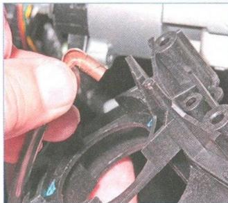
Отсоединяем от соединителя «масловый» провод.
