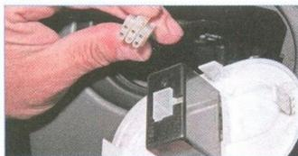
Нажав на фиксатор колодки, отсоединяем колодку проводов от переключателя.
