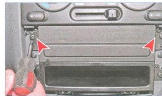
Крестообразной отверткой отворачиваем два винта крепления заглушки.
