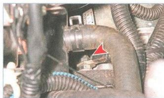
...головкой «на 12» отворачиваем гайку крепления наконечника «массового» провода к спецболту верхнего крепления стартера...
