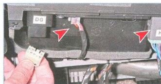
...и отсоединяем колодки проводов от выключателя лампы противотуманного света в заднем фонаре, часов и выключателя аварийной сигнализации.
