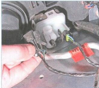
Нажав на фиксатор, отсоединяем колодку проводов от разъема блок-фары.
