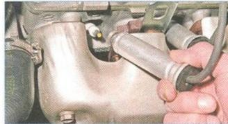
...снимаем со свечи наконечник высоковольтного провода.
