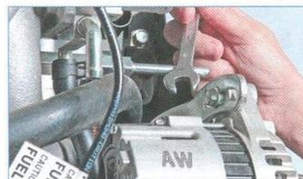
Ключом «на 12» ослабляем затяжку болта крепления генератора к натяжной планке.
