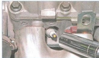
Высокой головкой «на 21» с удлинителем или свечным ключом выворачиваем свечу зажигания...
