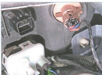
Мотор-редуктор ориентируем так, чтобы его разъем находился со стороны патрона лампы указателя поворота.
