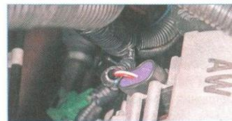
Отжав фиксатор колодки, отсоединяем колодку проводов от генератора. Ключом «на 12» отворачиваем гайку крепления наконечника провода к выводу «ВАТ» генератора...
