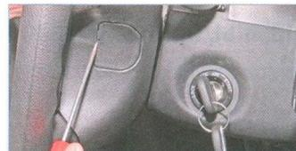
Поддев отверткой, снимаем заглушку на рулевом колесе.
