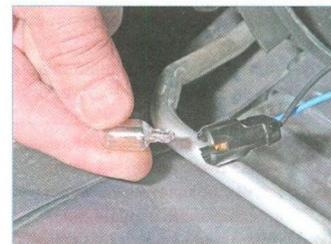
Вынимаем лампу из патрона.
