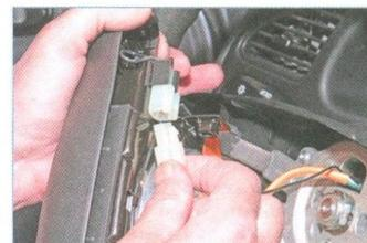
Нажав на фиксатор колодки, отсоединяем колодку проводов от колодки проводов выключателей звукового сигнала.
