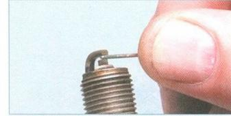
Проверяем круглым щупом зазор между электродами свечи.
