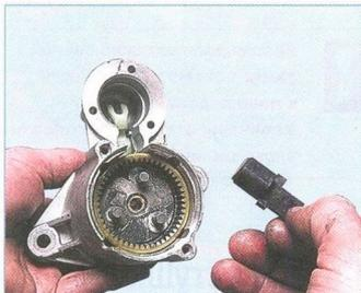
Вынимаем резиновую опору рычага привода.
