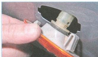
...вынимаем указатель из отверстия в переднем крыле.
