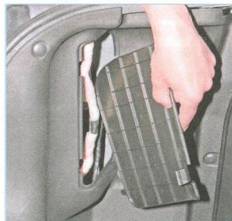
...и снимаем крышку обивки багажника.
