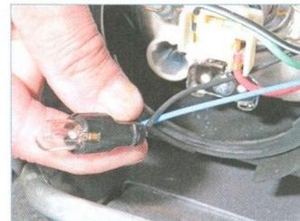
Вынимаем патрон с лампой из корпуса блок-фары.
