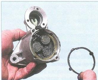
...и уплотнительное кольцо. Вынимаем три шестерни редуктора.
