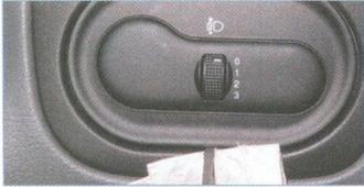
Поддеваем отверткой переключатель регулятора направления пучков света фар...
