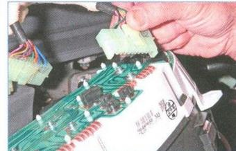
...и колодку проводов тахометра. Для замены лампы подсветки или контрольной лампы поворачиваем патрон лампы против часовой стрелки...
