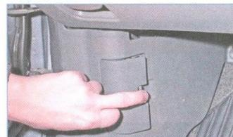
...нажимаем на фиксатор крышки...
