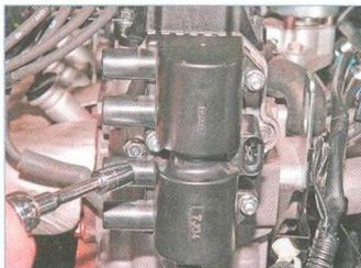
Головкой «на 10» отворачиваем три гайки крепления катушки зажигания к кронштейну...
