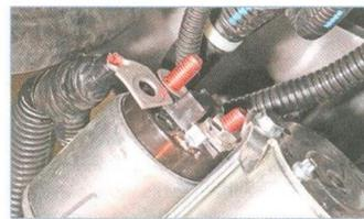
Снимаем наконечник провода с контактного болта тягового реле.
