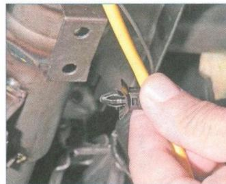
Аналогично снимаем держатель проводов барабанного устройства.
