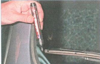
Отмечаем маркером на ветровом стекле положение щеток очистителя.
