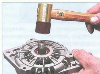
Молотком с пластмассовым бойком выбиваем вал ротора из подшипника.
