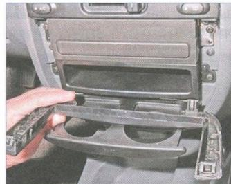
Снимаем облицовочную накладку.
