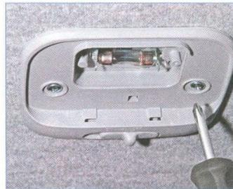
...крестообразной отверткой отворачиваем два винта крепления плафона.
