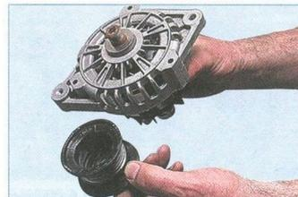
Снимаем с вала ротора шкив...
