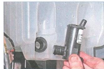
...и снимаем его с бачка.
