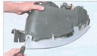
Крестообразной отверткой отворачиваем два самореза крепления накладки.
