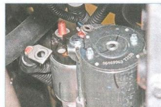
...и отсоединяем наконечник провода.
