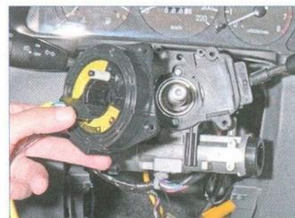
Снимаем барабанное устройство с соединителя переключателей.
