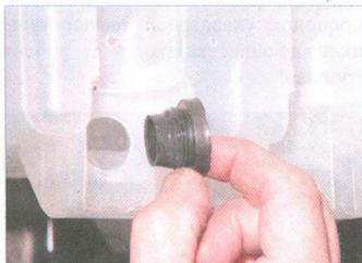
Вынимаем из отверстия бачка резиновую уплотнительную втулку. Порванную или потерявшую эластичность втулку заменяем новой. Устанавливаем насос омывателя в обратной последовательности. Для снятия бачка...
