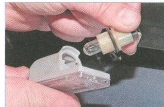
Повернув против часовой стрелки патрон лампы, вынимаем его из корпуса фонаря...
