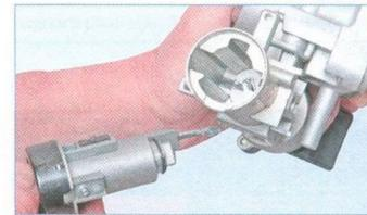
...и вынимаем цилиндрический механизм из корпуса выключателя зажигания.
