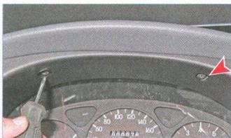
Крестообразной отверткой отворачиваем два самореза крепления накладки панели приборов.
