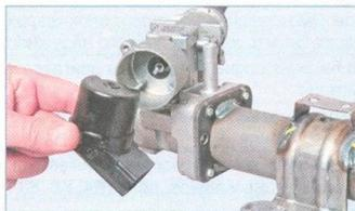
Снимаем контактную группу выключателя зажигания.
