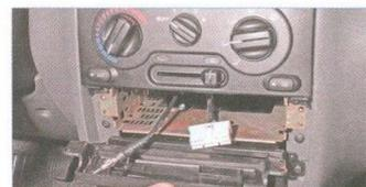
Снимаем заглушку и отсоединяем от держателей колодку жгута проводов и кабель антенны.
