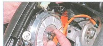
Поднимаем фиксатор колодки проводов подушки безопасности.
