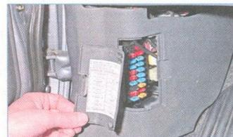
...и снимаем крышку левой обивки боковины.
