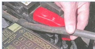
...вынимаем паротводящий шланг из держателя на крышке монтажного блока.
