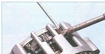
...и отпаиваем выводы обмотки статора от выводов выпрямительного блока.
