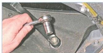
Головкой или ключом «на 13» отворачиваем гайку крепления рычага щетки.
