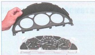
...и снимаем накладку комбинации приборов.
