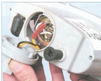
...и снимаем защитную крышку фары.
