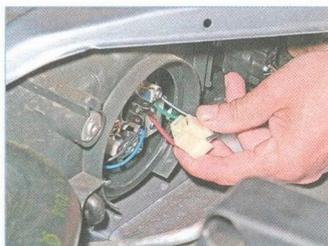
Отсоединяем колодку проводов от лампы головного света.
