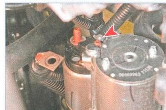
Головкой «на 10» отворачиваем гайку крепления наконечника провода управления тяговым реле...
