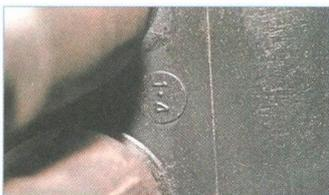
Наконечники высоковольтных проводов подсоединяем к катушке в соответствии с номерами цилиндров, нанесенными на корпусе катушки рядом с ее выводами.
