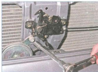
...головкой «на 12» отворачиваем болт крепления звукового сигнала.
