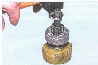
Оперев губки рожкового ключа «на 13» на ограничительное кольцо муфты, наносим удары молотком по ключу и спрессовываем ограничительное кольцо.
