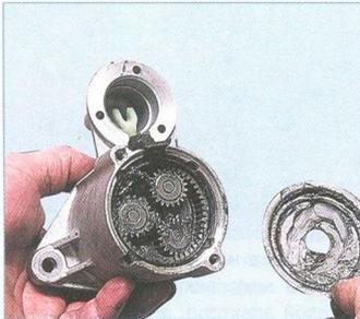
Снимаем защитную крышку планетарного механизма...
