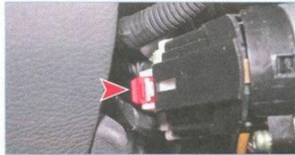
Нажав на фиксатор колодки, отсоединяем колодку проводов от контактной группы выключателя зажигания.
