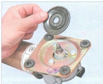
Снимаем уплотнитель мотор-редуктора.
