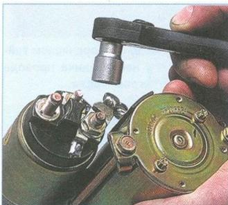
Головкой «на 13» отворачиваем гайку нижнего контактного болта тягового реле...
