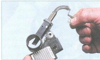
Вынимаем из щеткодержателя щетку в сборе.
