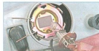
Вынимаем лампу из корпуса фары.
