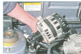
...и вынимаем генератор из моторного отсека.
