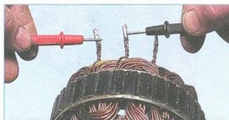
...омметром поочередно измеряем сопротивление между всеми выводами обмоток.
