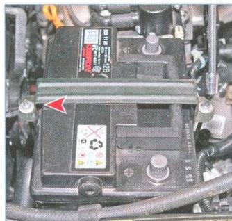
Головкой «на 10» отворачиваем две гайки крепления прижимной планки.
