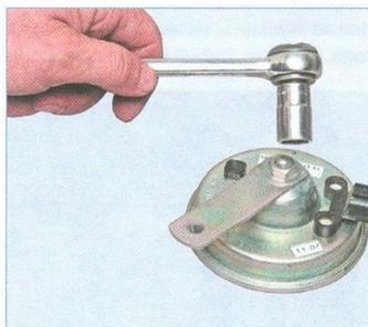
Ключом или головкой «на 13» отворачиваем гайку крепления кронштейна.
