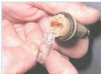
Вынимаем лампу из патрона.
