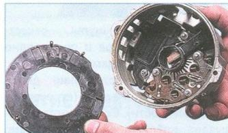
...и снимаем пластмассовую отражательную шайбу.
