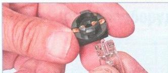
Вынимаем лампу из патрона. Устанавливаем новые лампы в обратной последовательности. На лампы подсветки приборов надеваем светофильтры. Для снятия приборов...
