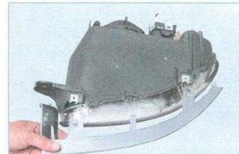
Снимаем декоративную накладку с блок-фары.
