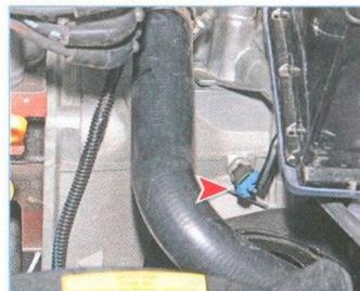
Выключатель расположен в картере коробки передач, спереди по ходу автомобиля.
