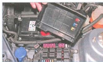
Отжав две пружинные защелки, снимаем крышку монтажного блока.
