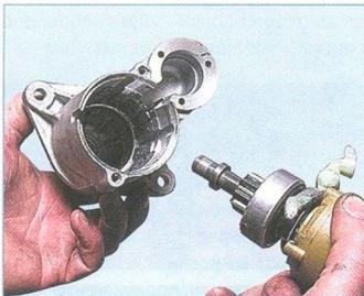
Снимаем вал привода с рычагом...
