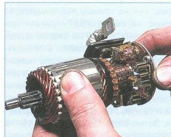
Снимаем щеткодержатель с якоря.
