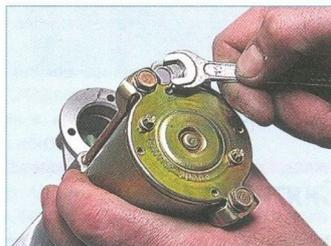
Ключом «на 10» отворачиваем два стяжных болта...
