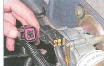
Нажав на фиксатор колодки, отсоединяем колодку проводов от мотор-редуктора.
