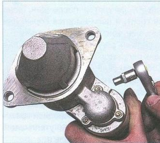
Головкой «Е5» отворачиваем три винта крепления тягового реле...
