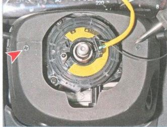
...крестообразной отверткой отворачиваем два самореза, соединяющих верхний и нижний кожухи рулевой колонки между собой.
