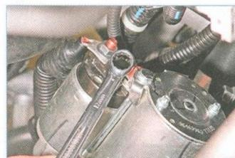
...ключом «на 12» отворачиваем гайку крепления наконечника провода, соединенного с «плюсовым» выводом аккумуляторной батареи.
