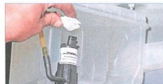
Нажав на фиксатор колодки, отсоединяем колодку проводов от насоса омывателя.
