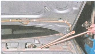
Вынимаем трапецию очистителя из моторного отсека.
