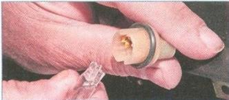
**Вынимаем лампу из патрона.**
