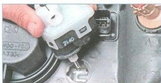
Повернув мотор-редуктор против часовой стрелки, вынимаем его из корпуса блок-фары.
