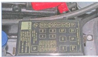
На крышке монтажного блока в моторном отсеке нанесена схема расположения предохранителей и реле и указано их назначение.
