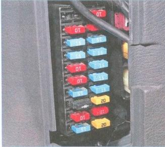
С помощью пинцета из монтажного блока в моторном отсеке можно заменить перегоревший предохранитель новым.
