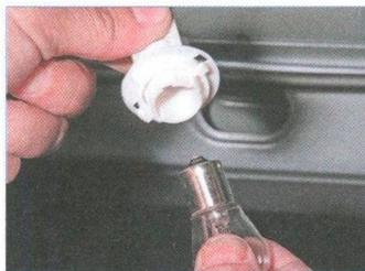
...и вынимаем лампу из патрона.
