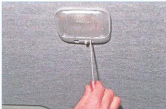
Отверткой поддеваем рассеиватель плафона...
