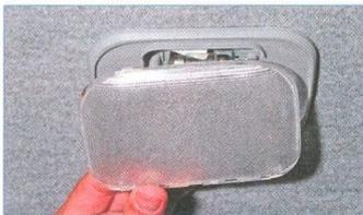
...и снимаем рассеиватель.
