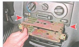
Выводим из консоли панели приборов корзину для установки головного устройства аудиосистемы.
