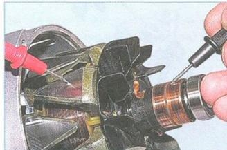
...подсоединяем щупы омметра к корпусу ротора и поочередно к контактным кольцам.
