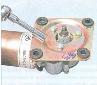
Головкой «на 10» отворачиваем три болта крепления мотор-редуктора.
