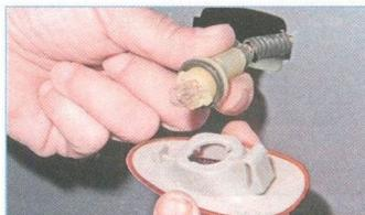
Повернув патрон лампы против часовой стрелки, вынимаем его из корпуса указателя.
