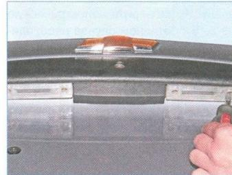
Отверткой отворачиваем два самореза крепления фонаря.
