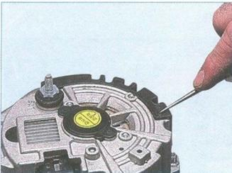
Шилом или чертилкой проталкиваем внутрь пластмассовой крышки два фиксирующих ее штифта...
