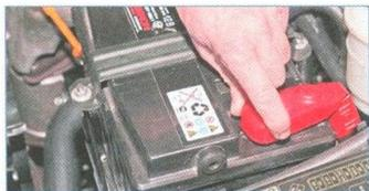
Снимаем защитный колпак с «плюсового» вывода аккумуляторной батареи.
