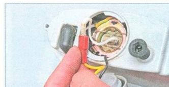
Вынимаем из корпуса фары колодку проводов (для наглядности показано на снятой фаре).
