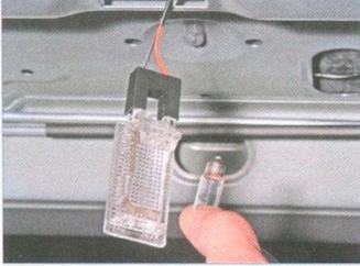
...вынимаем лампу из плафона...
