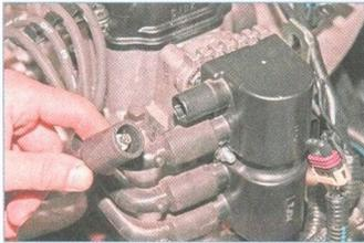
Снимаем наконечники высоковольтных проводов с выводов катушки зажигания.
