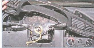
Снимаем накладку панели приборов...
