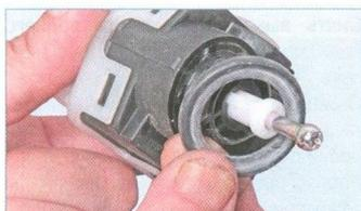
Снимаем уплотнительное кольцо мотор-редуктора. Устанавливаем мотор-редуктор в обратной последовательности.
