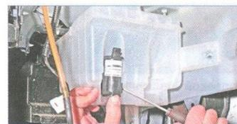
Поддев отверткой, сдвигаем насос...
