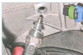
Вынимаем выключатель из отверстия в картере коробки передач.
