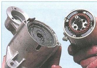
...и отсоединяем корпус стартера вместе с якорем от передней крышки.
