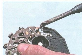
...и отпаиваем вывод регулятора напряжения от вывода выпрямительного блока.
