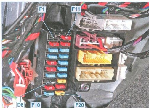
Монтажный блок предохранителей в салоне автомобиля
