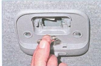
Вынимаем лампу освещения салона...
