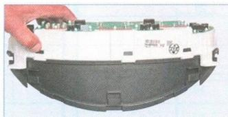
Аналогично отжимаем три фиксатора накладки сверху комбинации и четыре фиксатора снизу комбинации...
