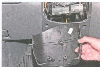
Снимаем нижний кожух рулевой колонки.
