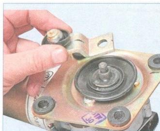
Снимаем кривошип с вала мотор-редуктора.
