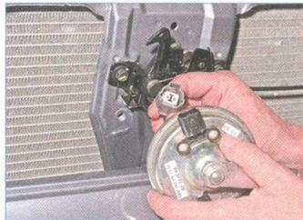
Нажав на фиксатор колодки, отсоединяем колодку проводов от звукового сигнала.
