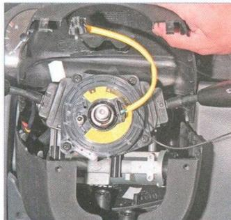
Снимаем верхний кожух рулевой колонки.
