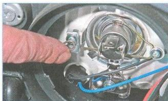
Нажимаем вниз на пружинный фиксатор лампы...
