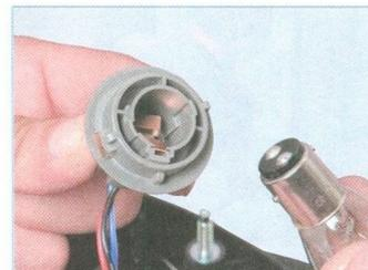
...и вынимаем лампу из патрона (для наглядности показано на снятом фонаре).
