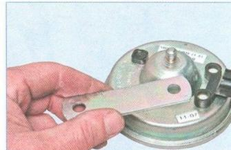
Снимаем кронштейн звукового сигнала.
