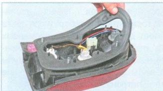
Снимаем резиновую прокладку с фонаря.
