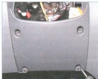
Крестообразной отверткой отворачиваем четыре самореза крепления нижней накладке панели приборов.
