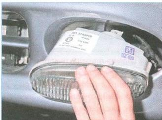
Снимаем противотуманную фару. Устанавливаем фару в обратной последовательности. После установки фары регулируем направление пучка света фары, вращая регулировочный винт шестигранником «на 6».
