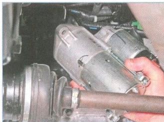
Снимаем стартер. Устанавливаем стартер в обратной последовательности.
