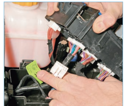
Расположение реле под панелью приборов: 1 — блок управления системой защиты аккумуляторной батареи; 2 — прерыватель указателей поворотов; 3 — реле включения противотуманного света в задних фонарях; 4 — реле блокировки стартера
