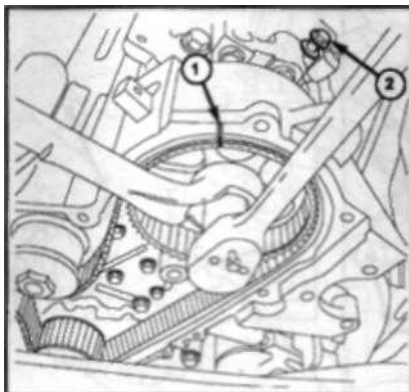
30.21 Снятие зубчатого колеса левого распределительного вала
