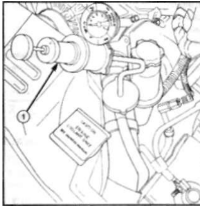
4.18 Установка приспособления с адаптером на горловину радиатора
