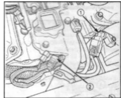
4.4b Датчик ЕСТ (2) и разъём (1) его электропроводки - двигатель 3.5 л
