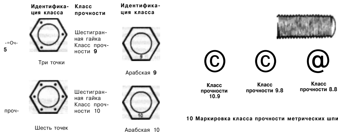
9 Маркировка класса прочности метрических шестигранных гаек
