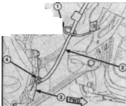
10.19 Крепление троса (2) на ступичной сборке (3) и на направляющей (1)
