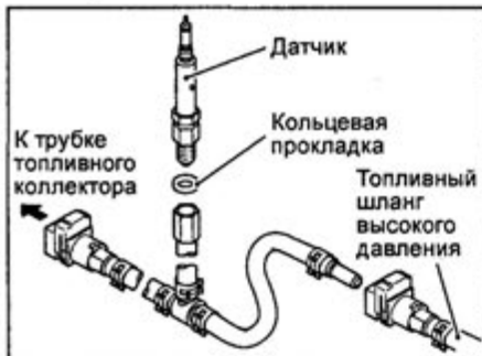
Проверка давления с помощью датчика давления.
