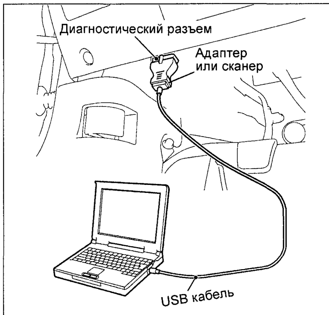
Расположение диагностического разъема на автомобиле Outlander XL.
