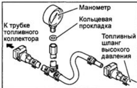
Проверка давления с помощью манометра.
