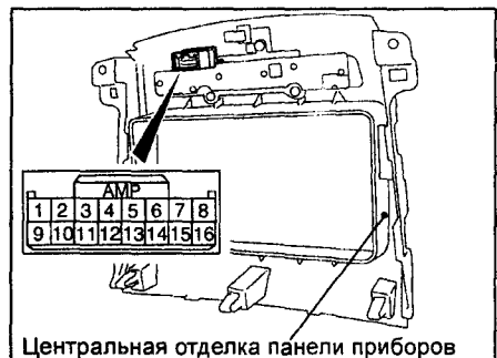
Снятие выключателя принудительного отключения подушки безопасности пассажира. 1 - выключатель принудительного отключения подушки безопасности пассажира в сборе с кронштейном, 2 - выключатель принудительного отключения подушки безопасности пассажира, 3 - кронштейн выключателя принудительного отключения подушки безопасности пассажира.
