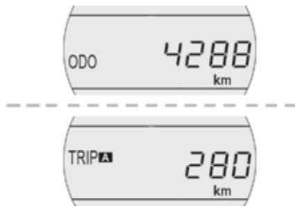
С включением зажигания индицируется счетчик, который был выбран до выключения двигателя.
