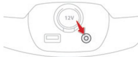
К нему можно подключать внешние переносные устройства и прослушивать аудиофайлы через бортовую аудиосистему. Управление файлами осуществляется с переносного устройства.
