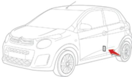
После каждой корректировки давления в одной или нескольких шинах, а также после замены одного или нескольких колес необходимо вновь настроить систему. Напоминание об этом содержится в этикетке на средней стойке со стороны водителя.
