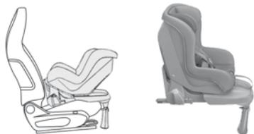
Устанавливается "спинкой вперед" на базе ISOFIX, прикрепляемой к кольцам **A**. База снабжена регулируемой по высоте стойкой, опирающейся на пол автомобиля. Это кресло можно также устанавливать для перевозки "лицом вперед".
