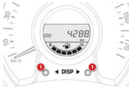
Нажатием на одну из кнопок **1** можно попеременно изменять индикацию пробега:
