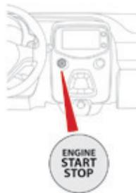
При длительном использовании дополнительными потребителями автомобиль автоматически перейдет в режим "OFF" по истечении примерно 20 минут.
