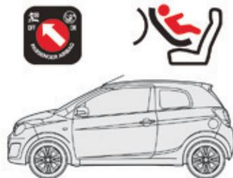
При установке детского кресла "спинкой вперед" на **сиденье переднего пассажира**, отодвиньте его в крайнее заднее положение и выпрямите спинку. Фронтальную подушку безопасности пассажира следует **обязательно отключать**. Иначе **надувшаяся подушка безопасности может тяжело травмировать или повлечь гибель ребенка**.
