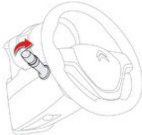
Задержка выключения световых приборов служит для поддержания фар ближнего света во включенном состоянии в течение некоторого времени после выключения зажигания с тем, чтобы осветить водителю или пассажирам путь при выходе из автомобиля в условиях слабой освещенности.
