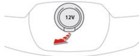
☞ Чтобы подключить прибор, рассчитанный на сеть 12 вольт (мощностью не более 120 ватт), поднимите крышку розетки и вставьте в нее соответствующий штепсель прибора.
