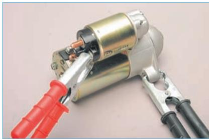
Соединяем проводами «плюсовой» вывод аккумуляторной батареи с управляющим выводом тягового реле, а «минусовой» вывод батареи — с крышкой стартера.
