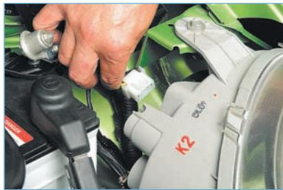
...отсоединяем колодку проводов от выводов лампы (показано на левой фаре).
