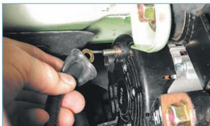
...и снимаем наконечник провода с вывода «В+» генератора.
