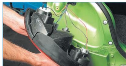
Отводим фонарь на себя, выводим его штифты из пистонов, установленных в отверстия кузова.
