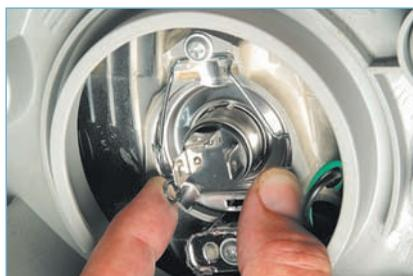
Сжав концы пружинного фиксатора, выводим их из зацепления с выступами отражателя.
