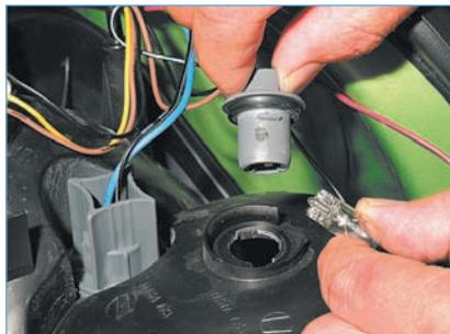
**Потянув, вынимаем лампу из патрона.**
