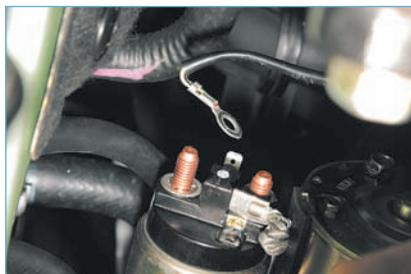
...и снимаем наконечник провода с вывода тягового реле.
