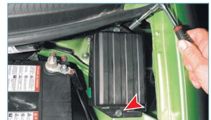
...головкой «на 10» с удлинителем отворачиваем два болта крепления
