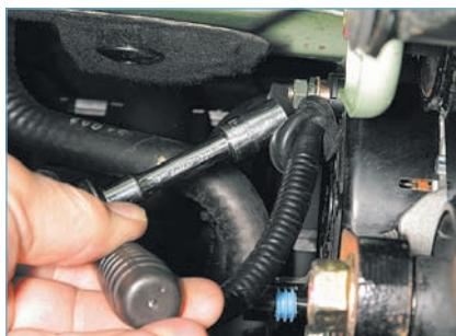
...головкой «на 10» отворачиваем гайку...
