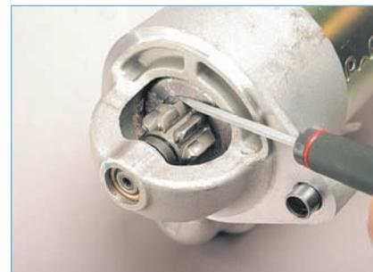
Отверткой сдвигаем шестерню по шлицам вала: она должна перемещаться свободно.
