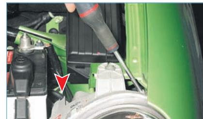
...отверткой вращаем регулятор расположенный ближе к крылу кузова. Для изменения направления светового пучка в вертикальной плоскости
