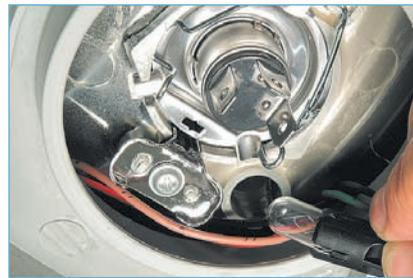
Вынимаем патрон с лампой габаритного света из гнезда в корпусе фары.
