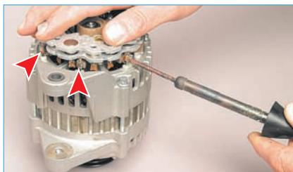
**Отпаиваем три вывода обмоток статора от выводов выпрямительного блока.**
