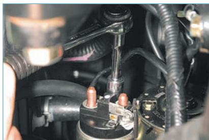
Головкой «на 10» с удлинителем отворачиваем гайку крепления наконечника провода управления тяговым реле...
