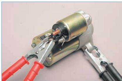
Кратковременно соединяем «плюсовой» вывод аккумуляторной батареи с нижним контактным болтом тягового реле, а «минусовой» вывод — с крышкой стартера.
