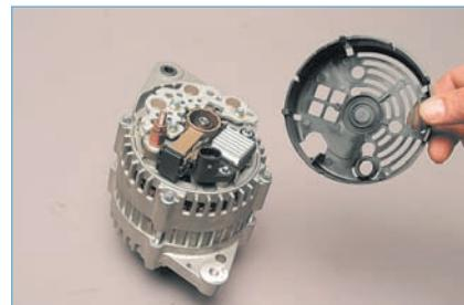
...и снимаем кожух генератора.
