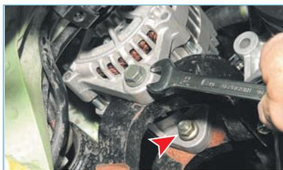
Ключом «на 12» отворачиваем болт нижнего крепления генератора со стороны привода.
