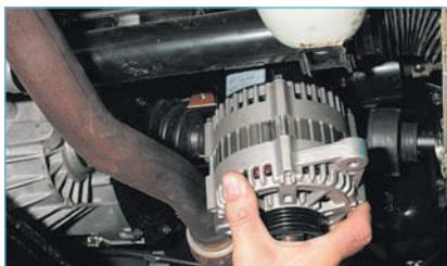
Сдвигаем генератор в сторону стартера, выводя проушину генератора
