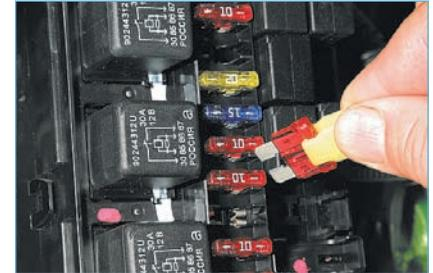
...и вынимаем предохранитель.
