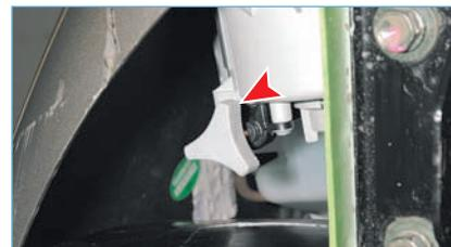
Снизу автомобиля вращаем регулировочный винт (показан стрелкой), добиваясь расположения световых пятен, (как показано на рисунке).
