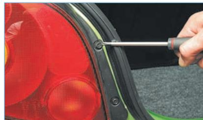
...крестообразной отверткой (или головкой «на 8») отворачиваем два самореза крепления заднего фонаря.
