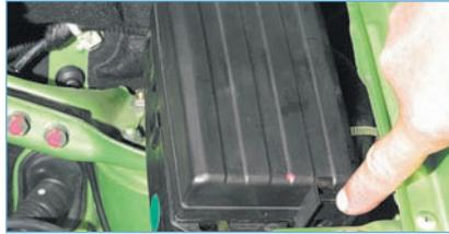
...нажимаем на фиксатор крышки (движением в сторону блока)...
