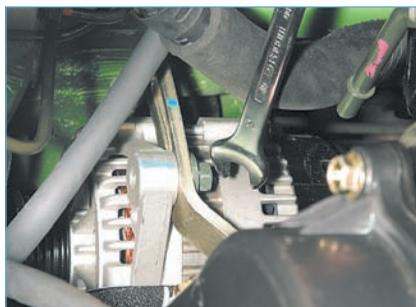
...ключом «на 12» отворачиваем болт регулировки натяжения ремня привода генератора.
