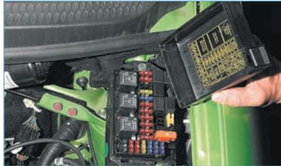
...и, сдвигая крышку назад (чтобы фиксаторы вышли из пазов корпуса), снимаем ее.
