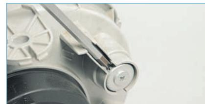
...вводим крестообразную отвертку в зацепление со звездочкой регулятора.
