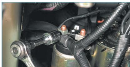
Головкой «на 12» с удлинителем отворачиваем гайку крепления наконечника провода питания стартера...
