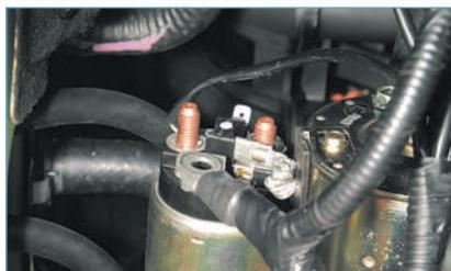
...и снимаем наконечник с вывода тягового реле.
