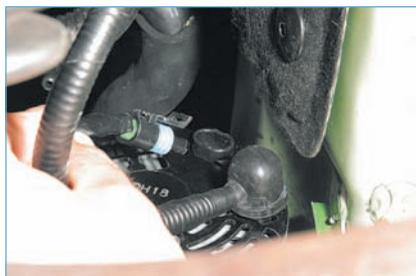
...отсоединяем колодку жгута проводов от генератора. Отведя резиновый защитный колпачок...
