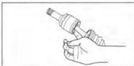
3. Снимите стопорное кольцо при помощи отвертки.
