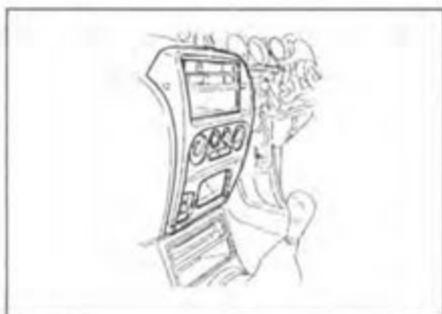
10. Отверните 4 винта и снимите комбинацию приборов.
