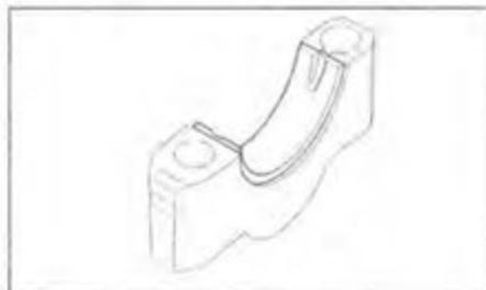
2. Установите верхние упорные полукольца в постель коренного подшипника №3 смазочными канавками наружу.
