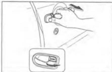
Для задних дверей установите кнопку блокировки замка двери в положение запирающего и закройте дверь.
