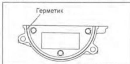
5. Установите крышку головки блока цилиндров.
