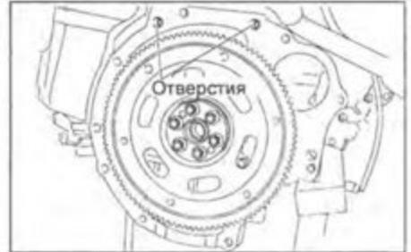
б) Убедитесь, что гидротрансформатор не соскочил с посадочного места и установите на двигатель трансмиссию.
