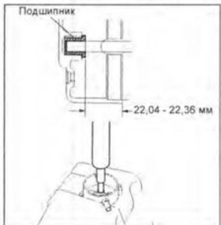
**Проверка обгонной муфты и шестерен**
