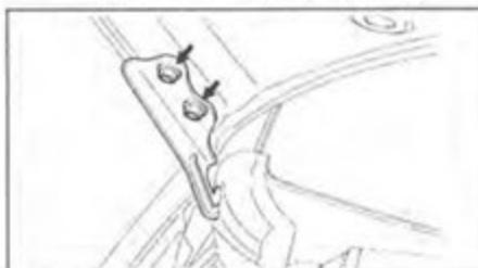
б) Отрегулируйте положение замка капота, ослабив болты крепления.
