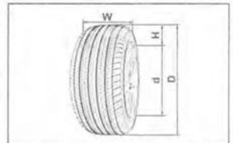
Размеры шин. D - наружный диаметр колеса, d - посадочный диаметр обода колеса, H - высота профиля покрышки, W - ширина профиля.
