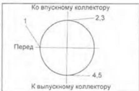
Серия КЗ. 1 - замок расширителя, 2 - замок компрессионного кольца №1, 3 - замок верхнего скребка масляеъемного кольца, 4 - замок компрессионного кольца №2, 5 - замок нижнего скребка масляеъемного кольца.
