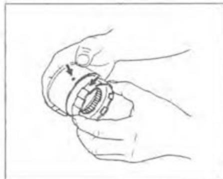
2. Установите водило и шайбу на центральный подшипник, зафиксируйте его стопорным кольцом.
