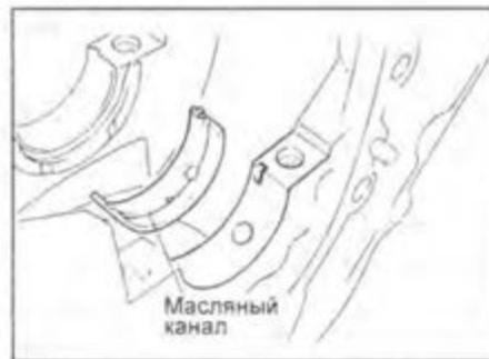
**Примечание:** очистите заднюю поверхность вкладыша подшипника и поверхность блока цилиндров, контактирующую с вкладышем. Не допускайте попадания масла и грязи на эти поверхности.
