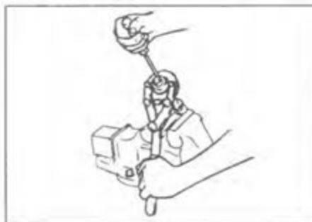
б) Зафиксируйте спецприспособлением вспомогательную шестерню и удалите сервисный винт, повернув вспомогательную шестерню.
