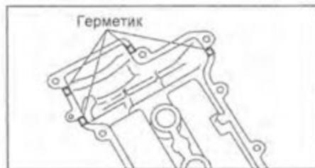
б) Установите крышку и затяните ее крепления.
