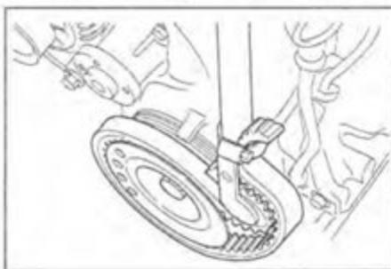
**Примечание:** не устанавливайте спецприспособление со стороны привода генератора.
