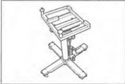
д) Поднимите домкрат до контакта с передним подрамником.
