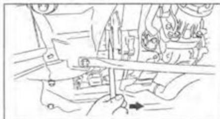
4. Снимите приводной вал.
