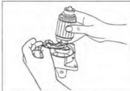
10. С помощью спецприспособления снимите упорную втулку со стопорного кольца.
