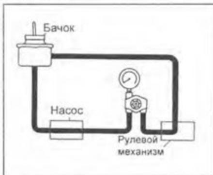
7. На холостом ходу двигателя и при полностью открытом клапане поверните рулевое колесо на максимальный угол и проверьте давление жидкости.
