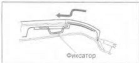
5. Предварительно установите переднюю часть молдинга, заведя фиксатор в кронштейн.
