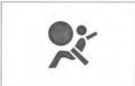
2. Если индикатор загорится позже чем через 6 секунд проверьте систему на отсутствие неисправности.
