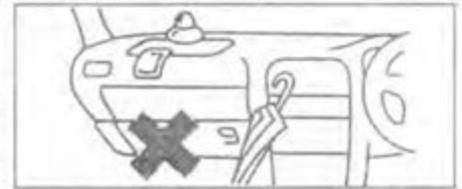
Не модифицируйте, не снимайте, не ударяйте и не открывайте какие-либо компоненты, как, например, накладку рулевого колеса, рулевое колесо, кожух рулевой колонки, крышку подушки безопасности переднего пассажира или устройство датчиков подушки. Подобные действия могут привести к внезапному срабатыванию подушки безопасности или выведению из строя системы SRS.
