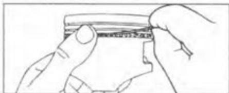
б) Экспандером для монтажа поршневых колец установите два компрессионных кольца; причем метки колец ("Т" или "R") должны быть обращены вверх, как показано на рисунке.
