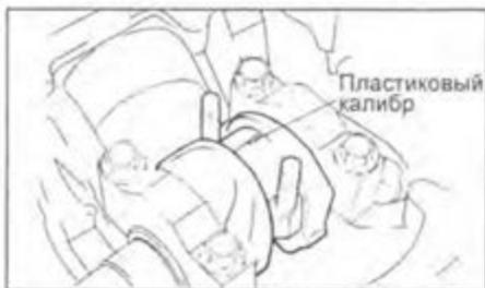
ж) Установите нижнюю крышку шатуна, совместив установочные метки. Затяните болты (серия КЗ) или гайки (EJ-VE) крепления (подробней см. подраздел "Сборка" раздела "Блок цилиндров").
