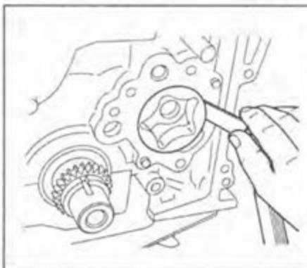
6. Прецизионной линейкой и щупом измерьте торцевой зазор между роторами и стенкой корпуса.
