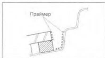
8. Используя шприц, нанесите клей на все контактные поверхности стекла.
