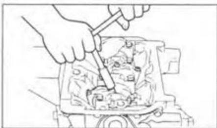
в) Снимите крышку шатуна.
