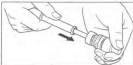
**Снятие и установка шлангов охладителя рабочей жидкости****Снятие**
