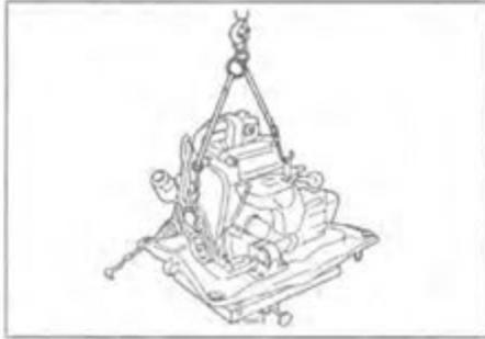
к) Снимите насос гидроусилителя рулевого управления с двигателя.
