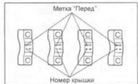
б) Нанесите тонкий слой моторного масла на резьбу и под головки болтов крепления крышек коренных подшипников.
