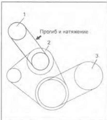
Ремень привода навесных агрегатов (EJ-VE). 1 - шкив насоса гидроусилителя рулевого управления, 2 - шкив насоса охлаждающей жидкости, 3 - шкив компрессора кондиционера.
