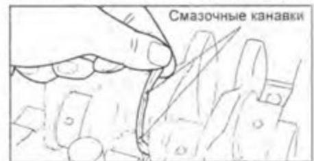
3. Нанесите моторное масло на поверхность вкладышей коренных подшипников и уложите коленчатый вал в блок цилиндров.
