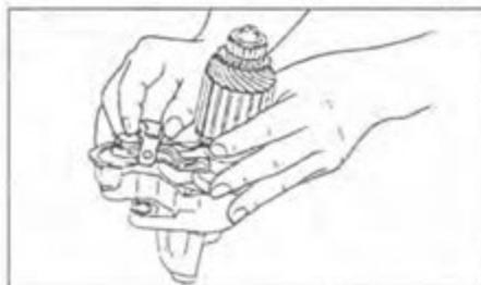
6. Установите статор на крышку со стороны привода.
