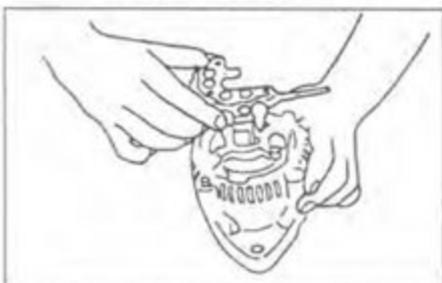
б) Установите шайбу и заверните болт крепления выпрямительного блока.
