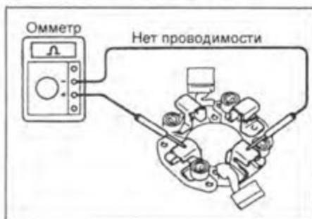
**Проверка пружин щеток**
