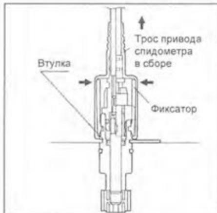
2. Снимите вал троса привода спидометра.
