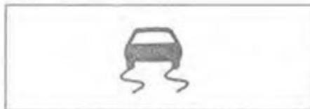
Индикатор скольжения загорается на несколько секунд после включения зажигания, а затем гаснет. Если индикатор не загорается при включении зажигания это свидетельствует о наличии неисправности в системе курсовой устойчивости.
