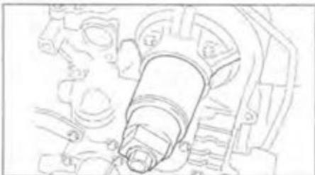
28. Зафиксируйте шкив распределительного вала с помощью спецприспособления и заверните болт его крепления.
