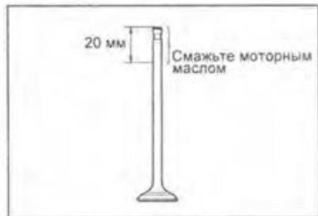
4. Установите клапаны в головку блока цилиндров.
