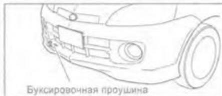
Соблюдайте крайнюю осторожность при выполнении буксировки автомобиля. Избегайте резкого трогания с места и резких маневров, при которых могут возникнуть чрезмерные усилия на буксирный трос или цепь. Петли, буксирный трос или цепь могут разорваться и стать причиной серьезной травмы или повреждения.
