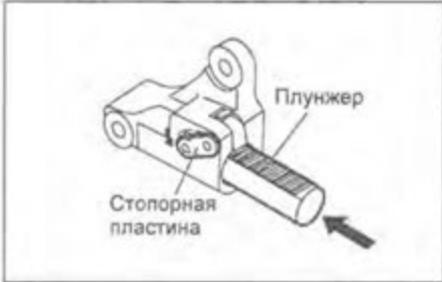
б) При утопленном плунжере совместите отверстия стопорной пластины и натяжителя, установите шестигранник в отверстие.
