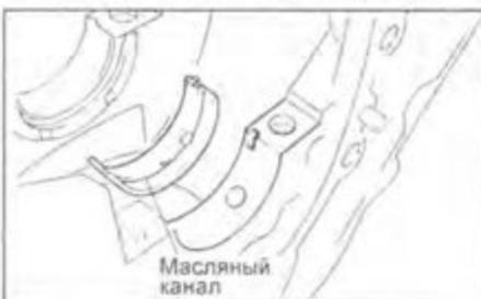
**Примечание:** очистите заднюю поверхность вкладыша подшипника и поверхность блока цилиндров, контактирующую с вкладышем. Не допускайте попадания масла и грязи на эти поверхности.
