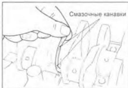
3. Нанесите моторное масло на поверхность вкладышей коренных подшипников и уложите коленчатый вал в блок цилиндров.
