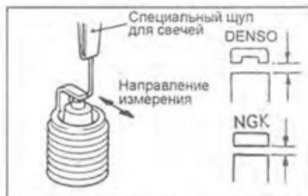
Для обычных свечей зажигания.
