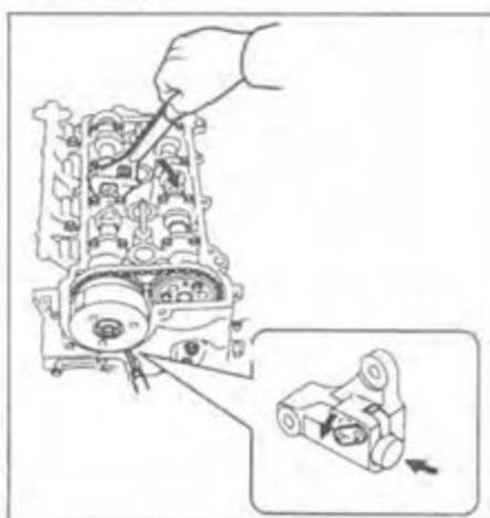
11. Совместите отверстие в стопорной пластине и натяжителя, установите шестигранник на 2,5 мм.
