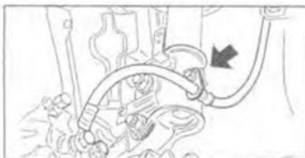
4. (Модели с ABS) Отсоедините провод датчика частоты вращения колеса.
