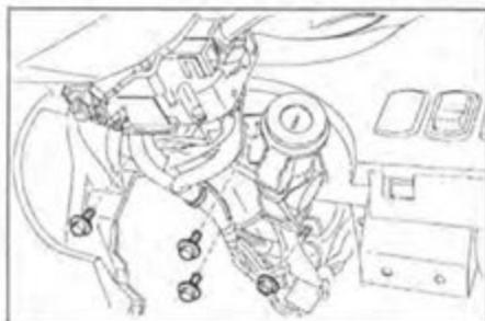
8. Открутите 2 винта, отсоедините пистоны и фиксаторы и снимите отделку комбинации приборов.
