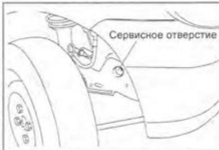
6. Установите шкив насоса охлаждающей жидкости, зафиксировав его с помощью отвертки во избежание проворота.
