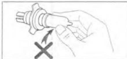
2. Если на колбу лампы попало масло, удалите его, в противном случае вследствие перегрева при работе срок службы лампы значительно уменьшится.
