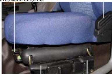
Ручка для регулирования передней высоты подушки для сиденья Ручка для регулирования задней высоты подушки для сиденья
