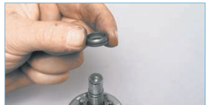
Снимаем с вала привода упорную втулку...
