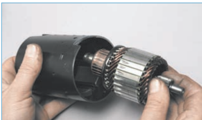
Вынимаем якорь из корпуса.
