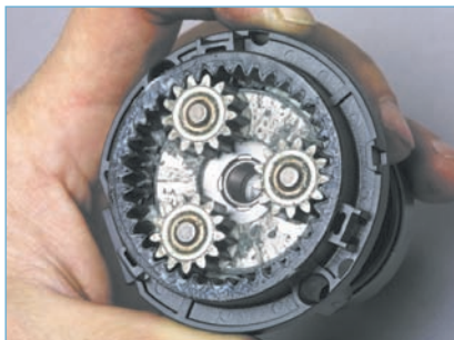
Зубья шестерен не должны иметь сколов и следов износа. При необходимости добавляем в редуктор смазку типа Литол-24 и устанавливаем крышку на место.
