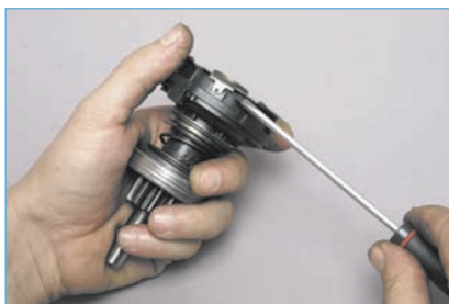
...отверткой поддеваем крышку редуктора и снимаем ее.
