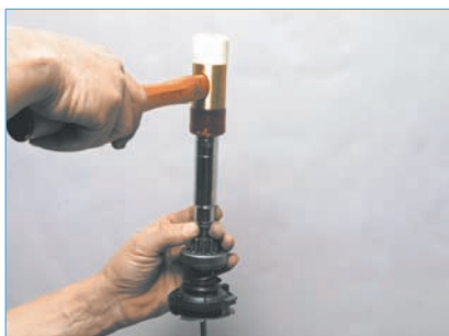
Оперев вал привода на металлический стержень, через подходящий отрезок трубы или высокую головку «на 11» сбиваем...
