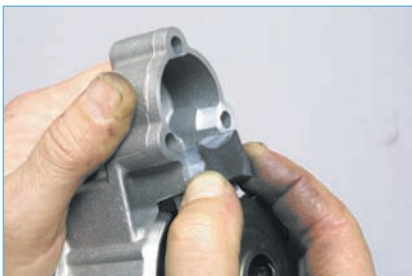
Вынимаем из крышки уплотнитель...
