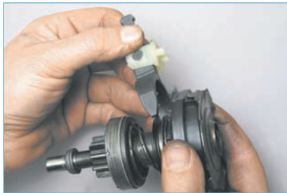
Снимаем рычаг привода. Для проверки состояния шестерен редуктора...
