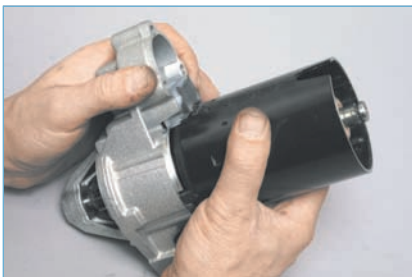
Снимаем переднюю крышку.
