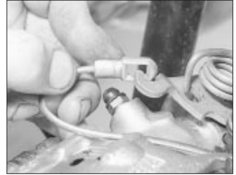
11.5a Unhook the handbrake cable . . .
