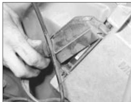
18.3 ESC II module multi-plug
