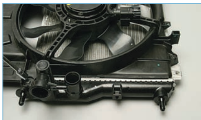
Головкой «на 10» отворачиваем два болта крепления кожуха электровентилятора к радиатору...
