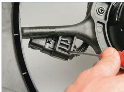
Отжав отверткой колодку жгута проводов, сдвигаем ее относительно держателя...
