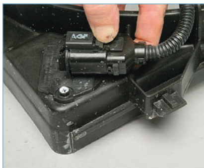
...отсоединяем колодку жгута проводов от резистора электровентилятора.
