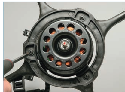
Крестообразной отверткой отворачиваем три винта крепления...
