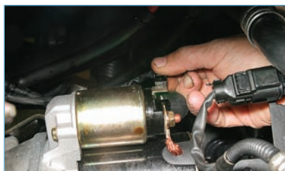
Отсоединяем колодку провода от стартера.
