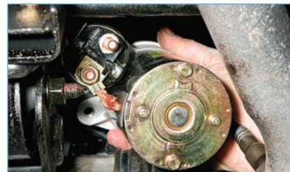
...и снимаем стартер. Для замены тягового реле...
