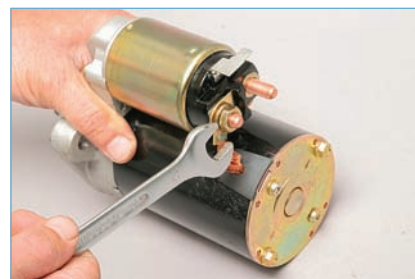
...ключом «на 12» отворачиваем гайку крепления наконечника провода к выводу тягового реле...
