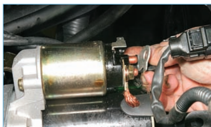
...и отсоединяем наконечник провода от вывода стартера.
