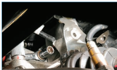
Головкой «на 14» отворачиваем два болта крепления (нижний болт также крепит наконечник «массового» провода)...
