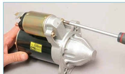
Крестообразной отверткой отворачиваем два винта крепления...
