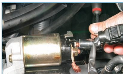
Головкой «на 12» отворачиваем гайку...
