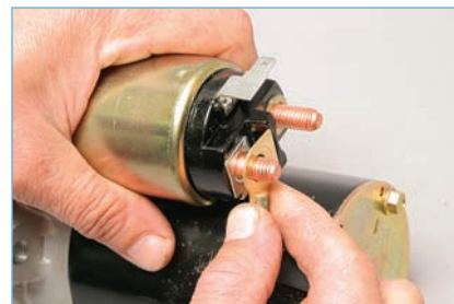
...и снимаем наконечник с вывода.
