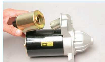
...и снимаем тяговое реле стартера.
