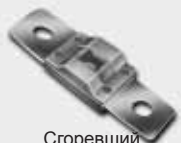
Сгоревший предохранитель 1VQA4037
