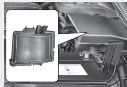
Панель предохранителей в моторном отсеке
