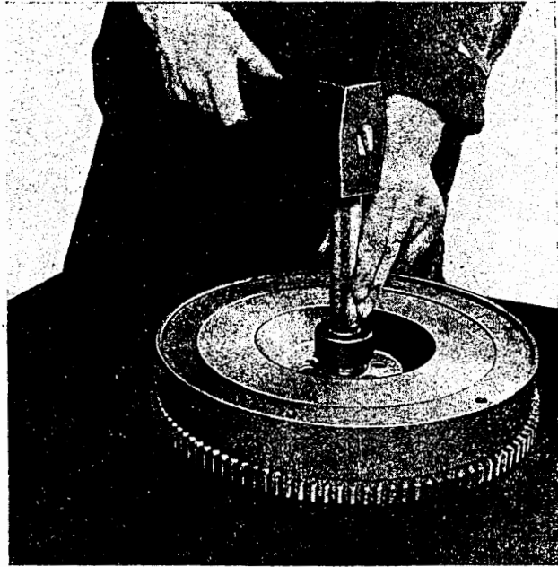
Bild M 80. Kugellager mit Eindrückdorn (Werkzeug Nr. 324.020-M 140) in das Schwungrad einschlagen bzw. mit Handhebelpresse eindrücken
