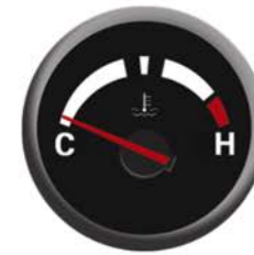
Indicador de temperatura del refrigerante
