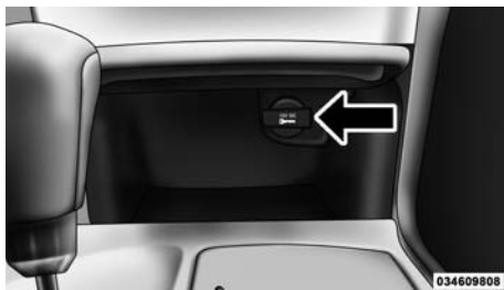
Передняя электрическая розетка
