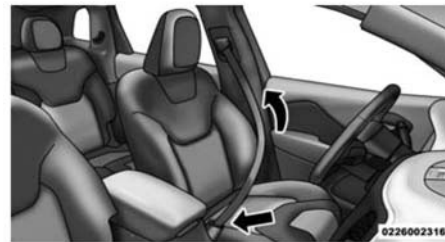
Устранение слабого натяжения ремня безопасности
