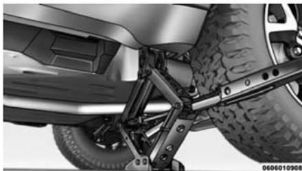
Место установки домкрата для замены заднего колеса
