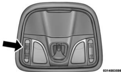
Выключатель электропривода крышки люка
