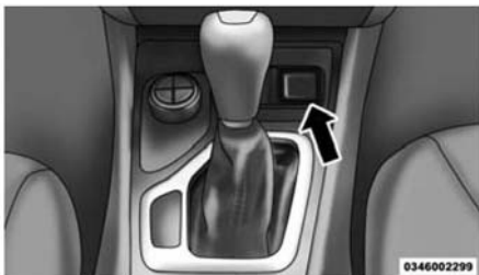
Передняя электрическая розетка
